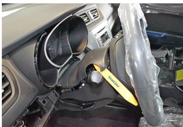
Фото 2.2. Снять верхнюю часть кожуха рулевого вала
