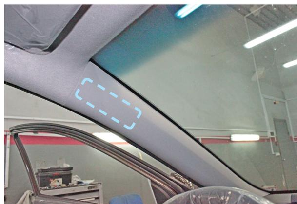
Фото 4.2. Возможное место установки антенны GSM
