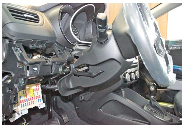
Фото 2.1. Кожух рулевого вала. Общий вид
