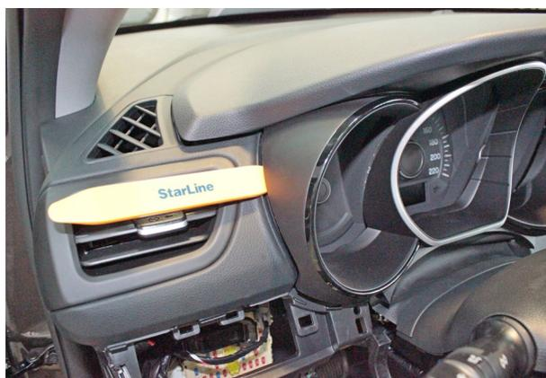
Фото 3.2. Снять декоративную накладку панели приборов
