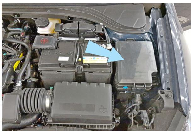
Фото 5.6. Возможное место установки подкапотного блока R6
