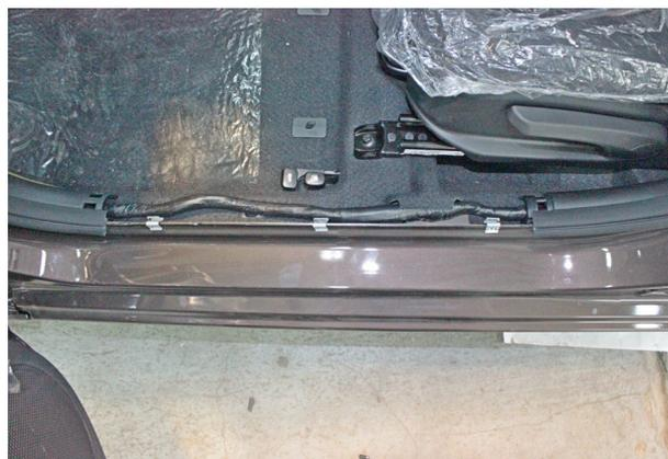
Фото 1.12. Накладка порога двери водителя снята
