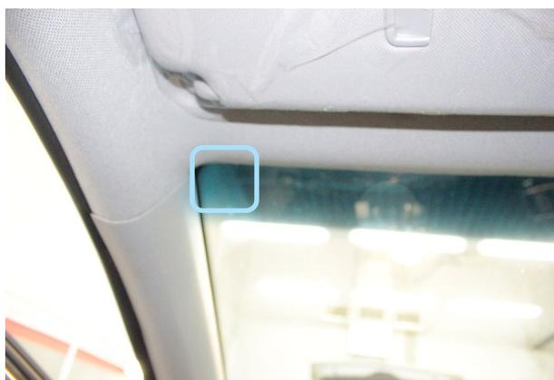
Фото 4.1. Возможное место установки микрофона
