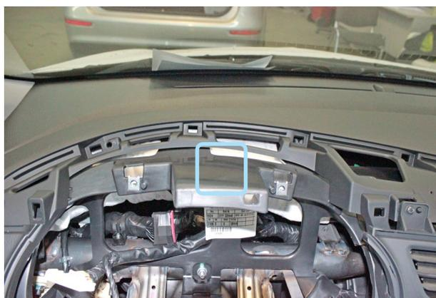
Фото 4.3. Возможное место установки антенны GPS+GLONASS
