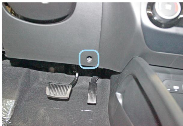
Фото 1.10. Саморез крепления пластиковой накладки под рулевой колонкой
