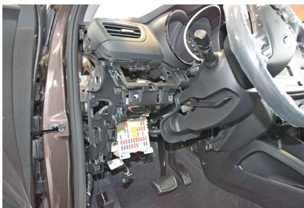
Фото 1.15. Пластиковая накладка под рулевой колонкой снята
