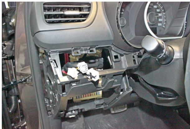
Фото 1.7. Блок кнопок управления снят
