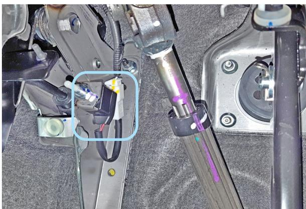
Фото 10.1. Местоположение разъёма концевика педали сцепления
