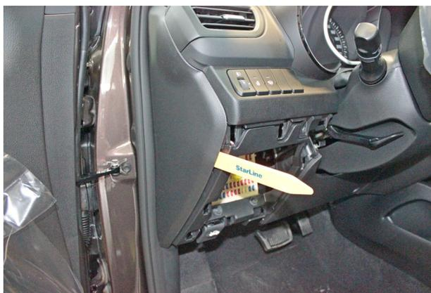
Фото 1.3. Снять боковую накладку передней панели
