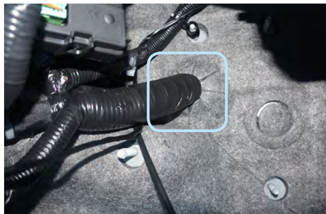
Фото 2.8. Штатный уплотнитель. Вид со стороны салона
