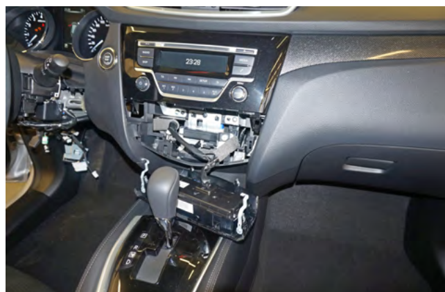
Фото 1.11. Блок управления климат-контролем снят
