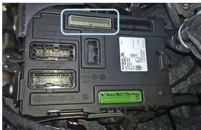
Фото 3.8. Местоположение серого разъёма блока BSM
