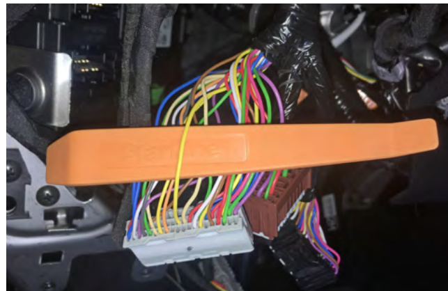
Фото 3.5. Альтернативное управление световыми сигналами (жёлтый)
