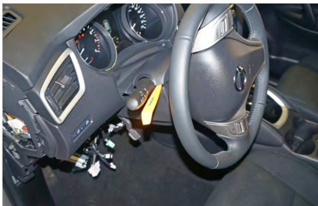
Фото 1.8. Снять нижнюю часть кожуха рулевого вала
