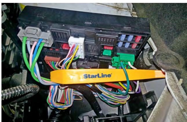
Фото 2.11. Подключение цепи зажигания (зелёный)
