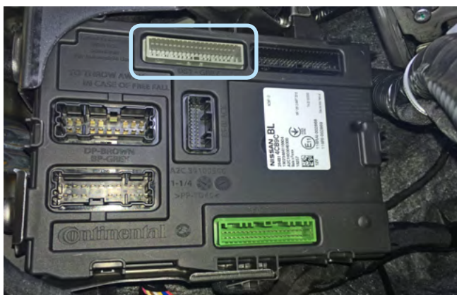
Фото 3.4. Местоположение серого разъёма блока BCM
