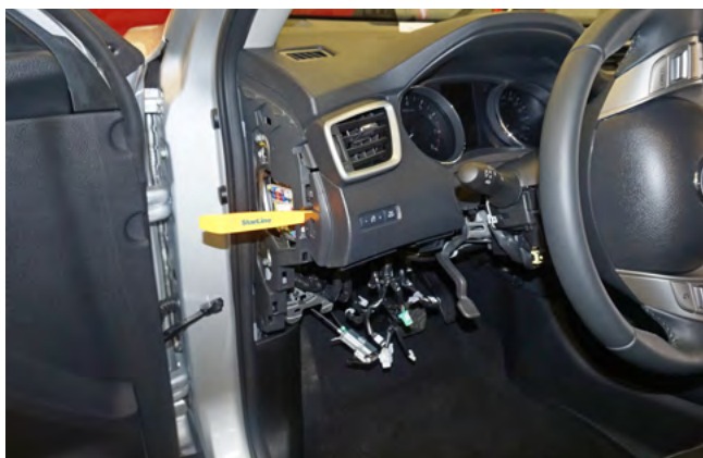
Фото 1.14. Снять пластиковую накладку слева от панели приборов
