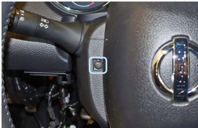
Фото 1.6. Саморез крепления кожуха рулевого вала слева
