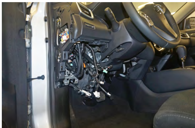
Фото 1.5. Пластиковая накладка под рулевой колонкой снята
