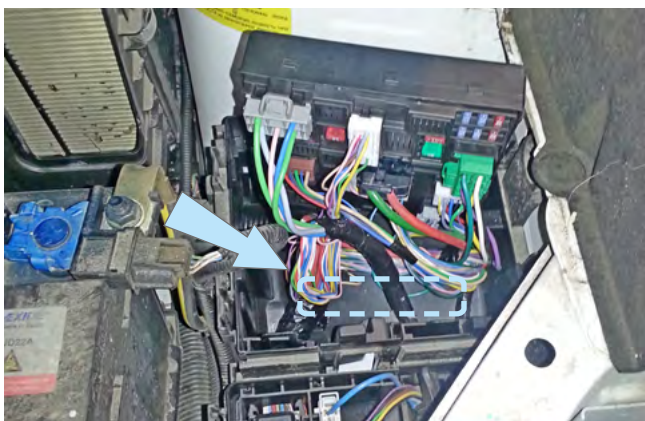
Фото 2.9. Возможное место установки подкапотного блока R6
