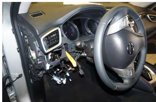
Фото 1.15. Накладка снята. Снять декоративную накладку панели приборов
