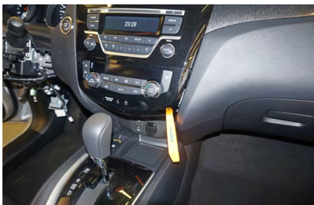
Фото 1.10. Снять блок управления климат-контролем
