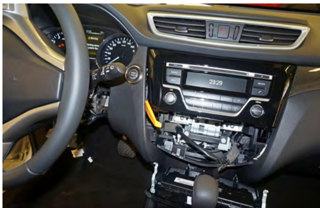
Фото 1.12. Снять пластиковую накладку справа от панели приборов
