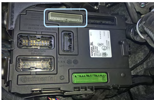
Фото 3.6. Местоположение серого разъёма блока BSM
