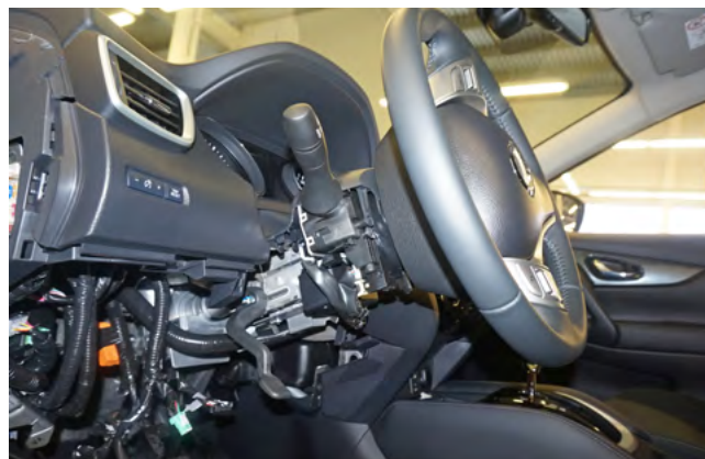
Фото 1.9. Нижняя часть кожуха рулевого вала снята
