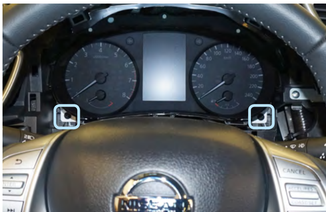
Фото 1.16. Саморезы крепления панели приборов
