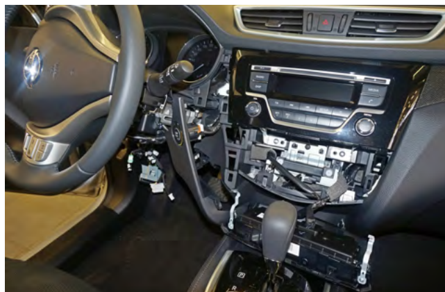
Фото 1.13. Пластиковая накладка снята
