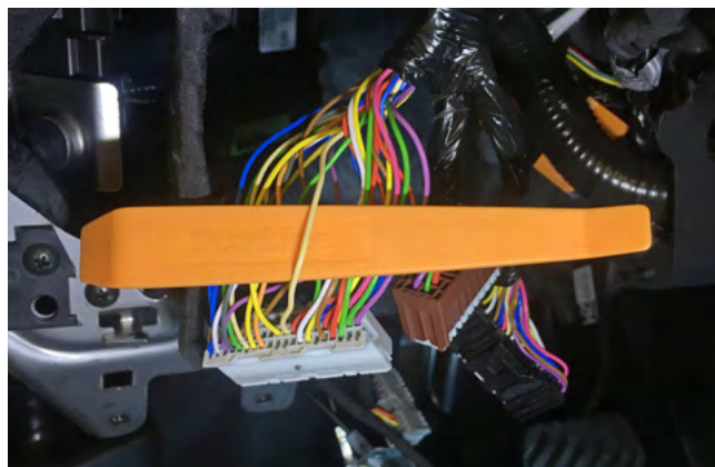
Фото 3.7. Управление запираем центального замка (бежевый)
