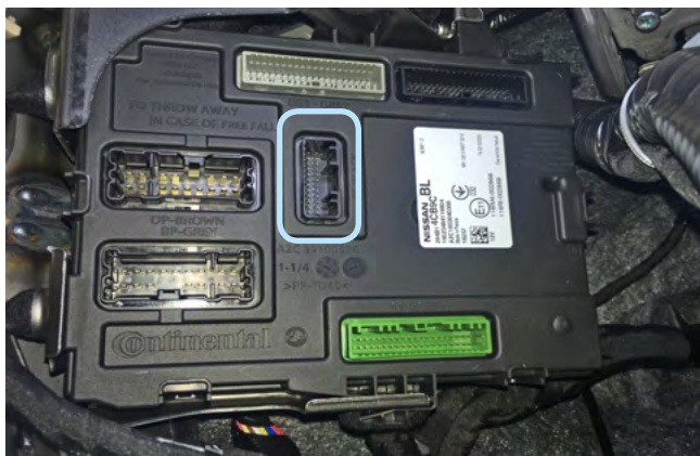
Фото 3.12. Местоположение чёрного разъёма блока BCM
