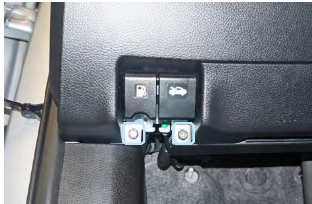
Фото 1.2. Болты крепления ручки отпирания капота
