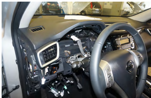
Фото 1.17. Панель приборов снята
