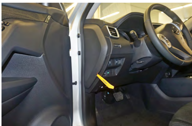
Фото 1.3. Снять боковую накладку передней панели
