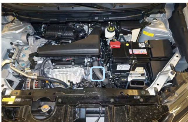
Фото 2.5. Место установки датчика температуры двигателя
