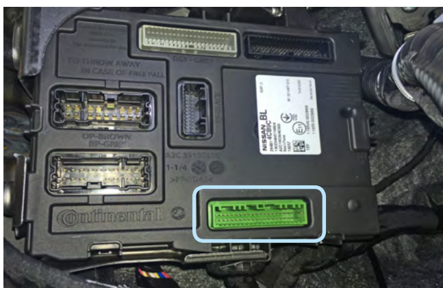
Фото 3.2. Местоположение зелёного разъёма блока BCM
