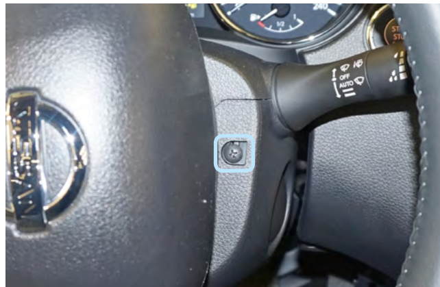
Фото 1.7. Саморез крепления кожуха рулевого вала справа
