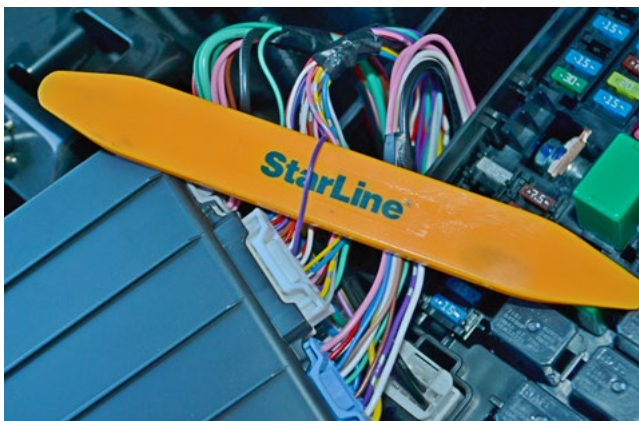
Фото 2.9. Подключение цепи зажигания (фиолетовый)
