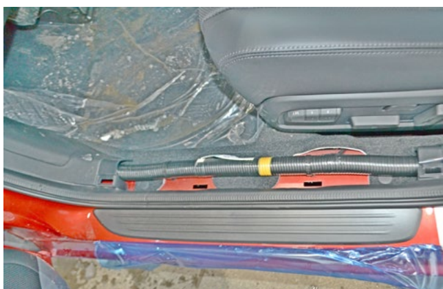
Фото 1.3. Накладка порога двери водителя снята
