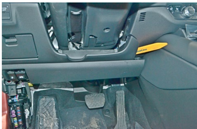
Фото 1.7. Снять накладку под рулевой колонкой
