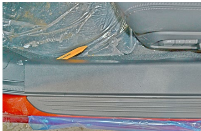
Фото 1.2. Снять накладку порога двери водителя
