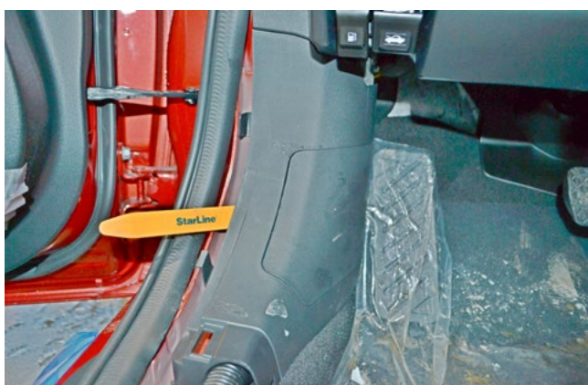
Фото 1.5. Снять накладку левой кик-панели
