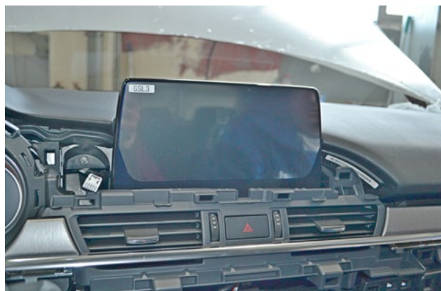
Фото 1.14. Накладка под монитором снята
