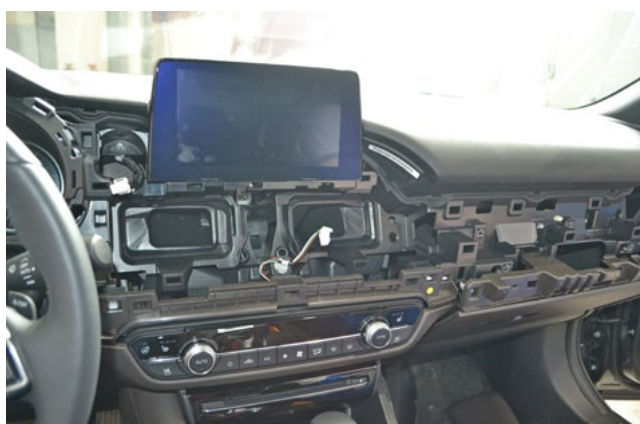
Фото 1.16. Накладка с центральными воздуховодами снята
