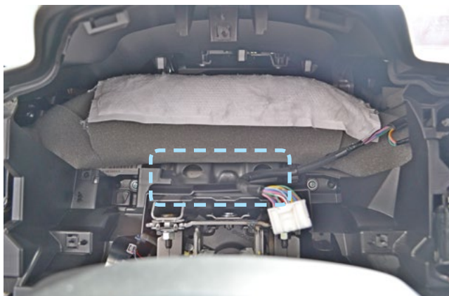
Фото 2.11. Пример расположения центрального блока охранно-телематического комплекса
