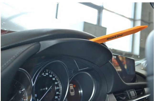
Фото 1.11. Снять верхнюю накладку панели приборов
