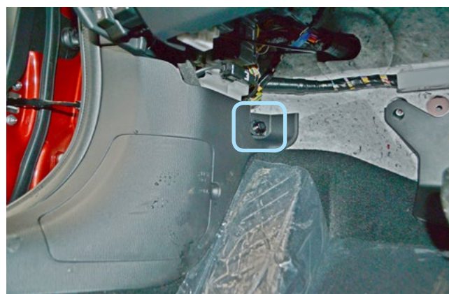
Фото 1.4. Клипса крепления накладки левой кик-панели
