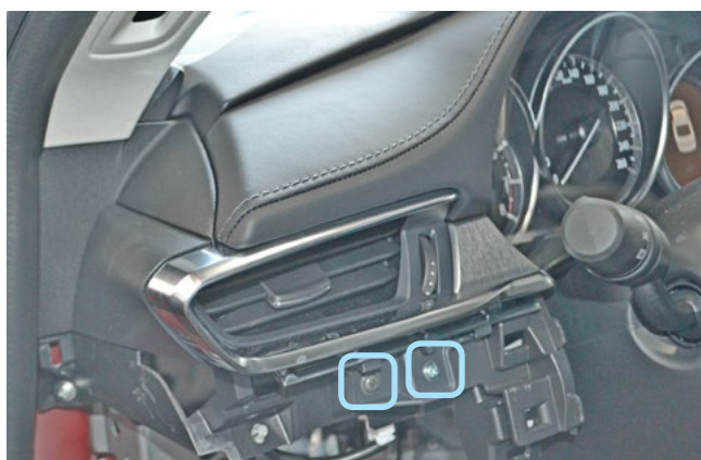
Фото 1.17. Саморезы крепления накладки слева от панели приборов
