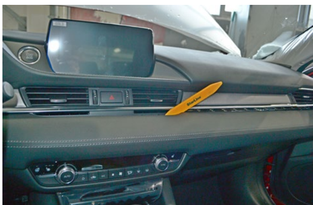
Фото 1.9. Снять декоративную накладку передней панели
