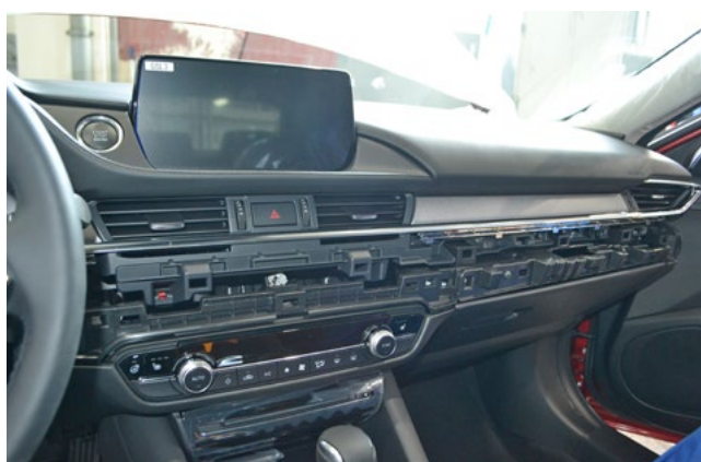
Фото 1.10. Декоративная накладка передней панели снята
