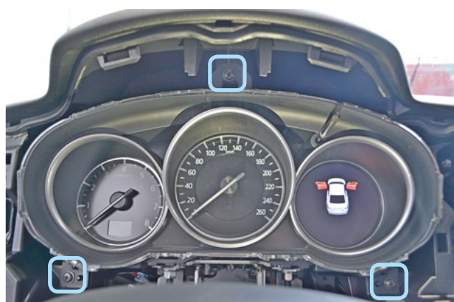
Фото 1.20. Саморезы крепления панели приборов
