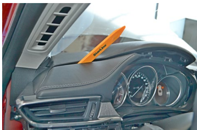
Фото 1.18. Снять декоративную накладку слева от панели приборов
