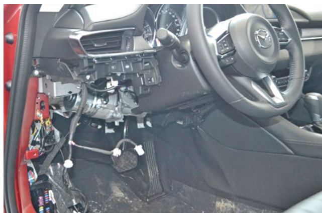
Фото 1.8. Накладка под рулевой колонкой снята
