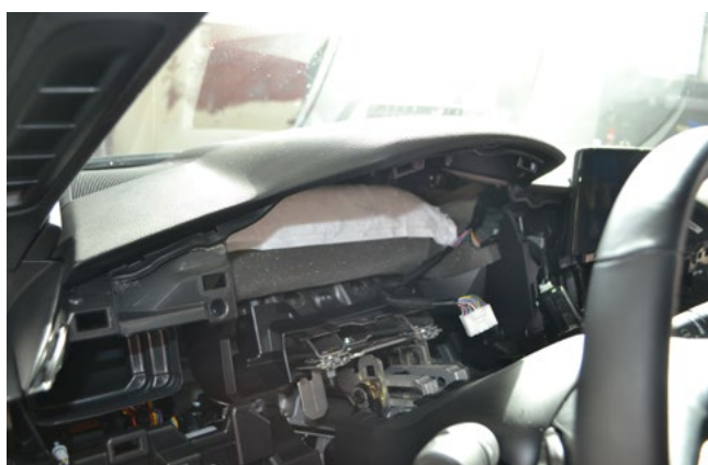
Фото 1.21. Панель приборов снята
