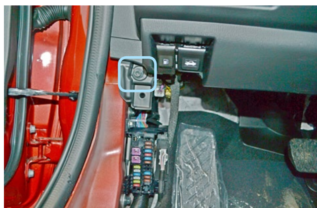
Фото 1.6. Пластиковая накладка левой кик-панели снята. Болт крепления
