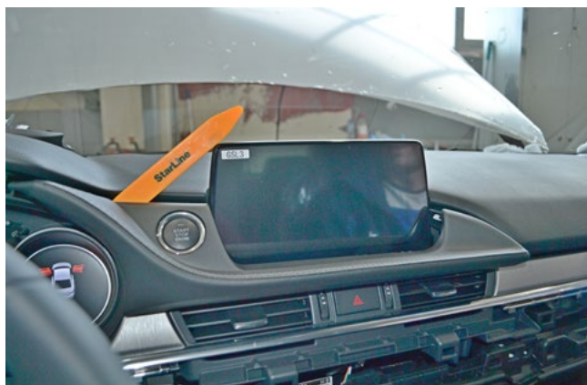
Фото 1.13. Снять накладку под монитором
