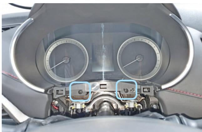
Фото 1.10. Верхняя часть кожуха снята. Саморезы крепления
