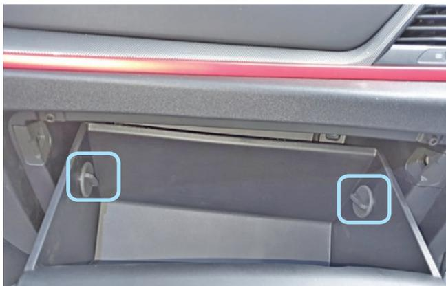
Фото 1.18. Фиксаторы крепления перчаточного ящика
