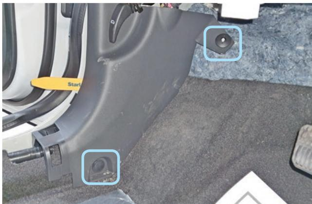
Фото 1.3. Снять накладку порога двери водителя. Клипсы крепления
