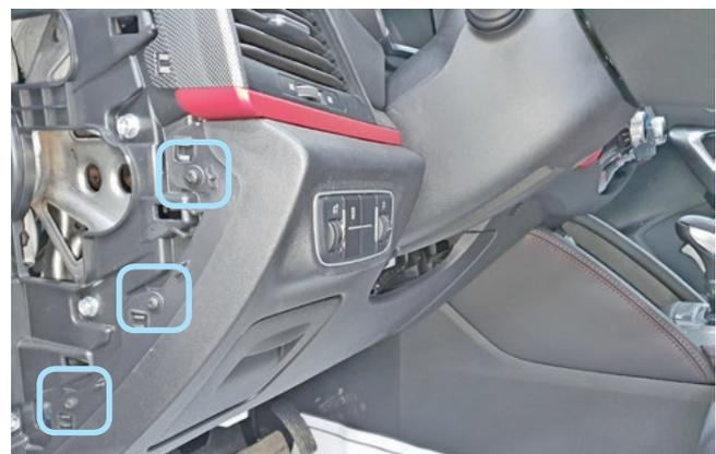
Фото 1.6. Левая накладка передней панели снята. Саморезы крепления
