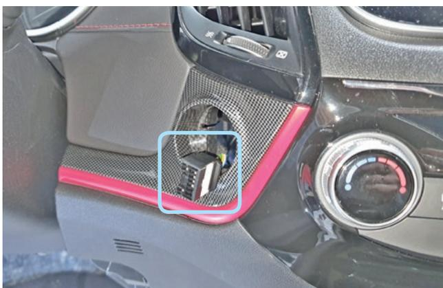
Фото 3.9. Местоположение разъёма кнопки Старт-Стоп
