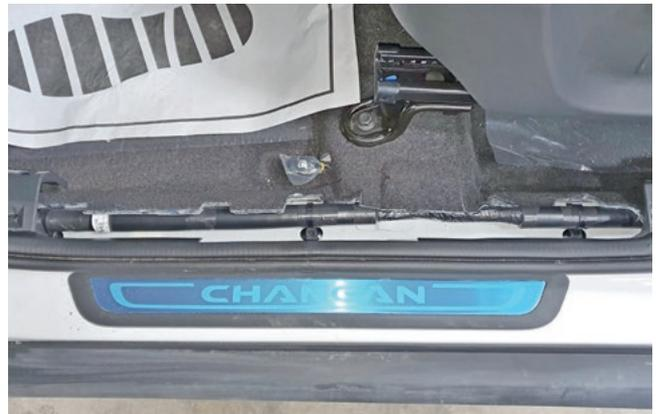
Фото 1.2. Накладка порога двери водителя снята
