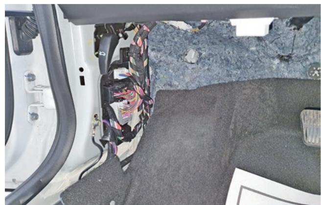
Фото 1.4. Накладка порога двери водителя снята
