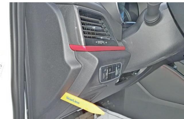
Фото 1.5. Снять левую накладку передней панели
