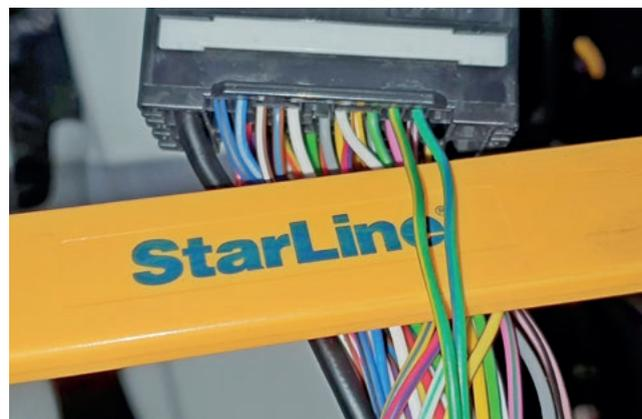
Фото 3.8. Управление центральным замком (зелёно-синий и зелёно-жёлтый)
