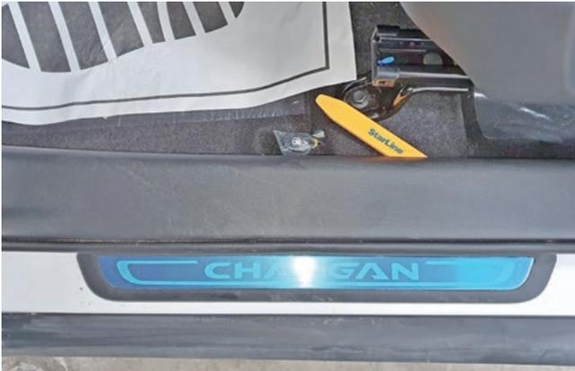
Фото 1.1. Снять накладку порога двери водителя
