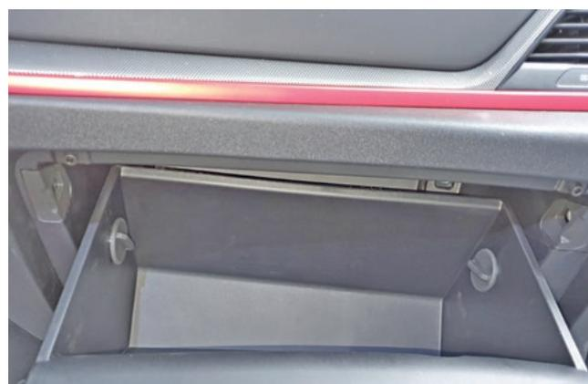
Фото 1.17. Фиксаторы крепления перчаточного ящика
