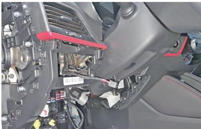
Фото 1.7. Накладка под рулевой колонкой снята
