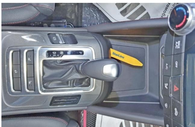
Фото 1.14. Снять накладку центрального тоннеля
