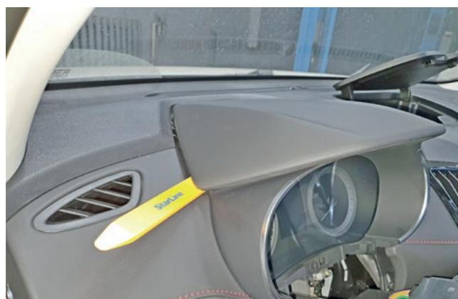
Фото 1.11. Снять верхнюю накладку панели приборов
