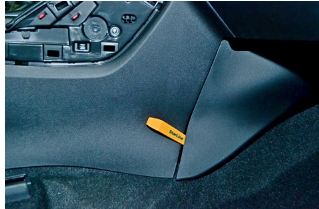
Фото 1.14. Снять нижнюю правую накладку центрального тоннеля
