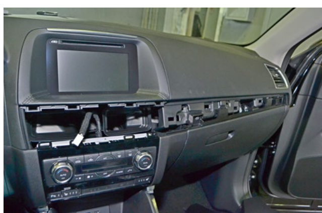
Фото 1.16. Декоративная накладка передней панели снята
