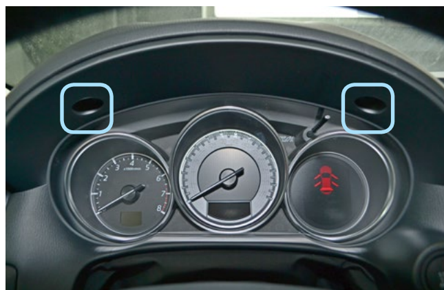
Фото 1.20. Клипсы крепления накладки панели приборов
