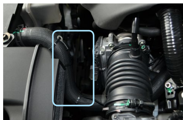
Фото 2.4. Крепление датчика температуры двигателя
