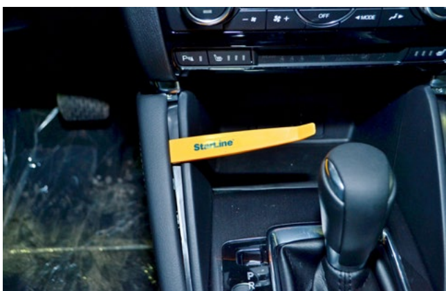
Фото 1.9. Снять левую накладку центрального тоннеля возле рычага коробки передач
