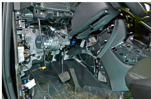
Фото 1.18. Накладка под рулевой колонкой снята
