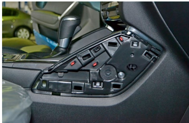
Фото 1.12. Правая накладка центрального тоннеля возле рычага коробки передач снята
