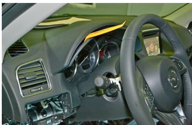
Фото 1.21. Снять декоративную накладку панели приборов
