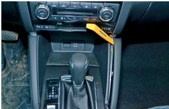
Фото 1.11. Снять правую накладку центрального тоннеля возле рычага коробки передач
