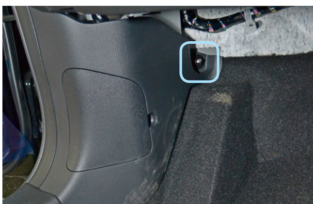
Фото 1.3. Клипса крепления накладки левой кик-панели
