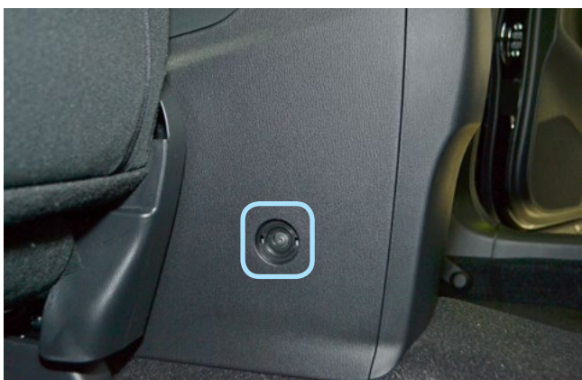
Фото 1.7. Саморез крепления центрального тоннеля
