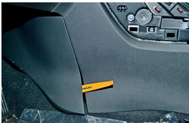
Фото 1.13. Снять нижнюю левую накладку центрального тоннеля
