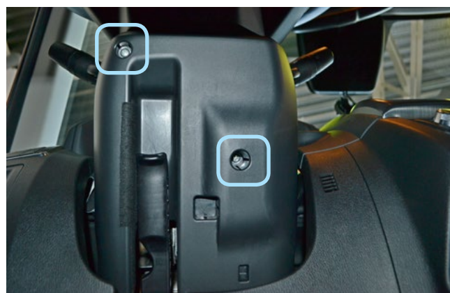
Фото 1.22. Саморезы крепления нижней части кожуха рулевого вала
