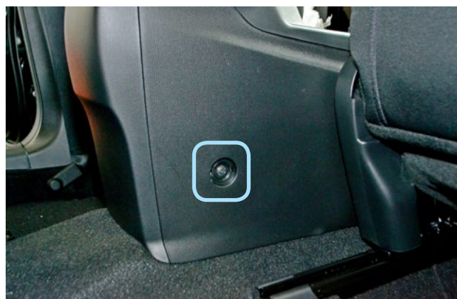
Фото 1.8. Саморез крепления центрального тоннеля
