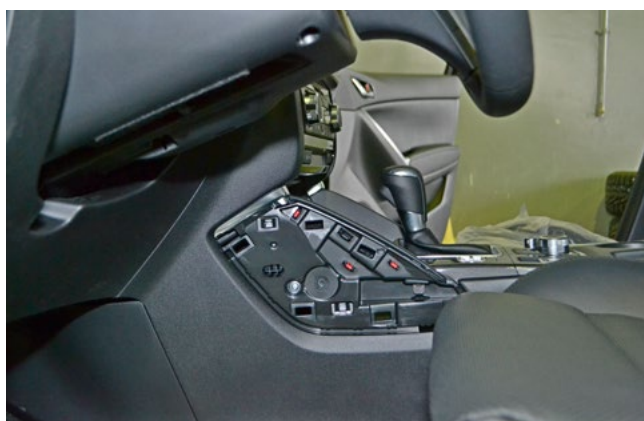
Фото 1.10. Левая накладка центрального тоннеля возле рычага коробки передач снята
