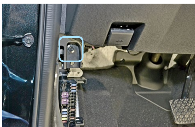
Фото 1.4. Болт крепления накладки под рулевой колонкой
