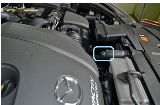
Фото 2.3. Место установки датчика температуры двигателя
