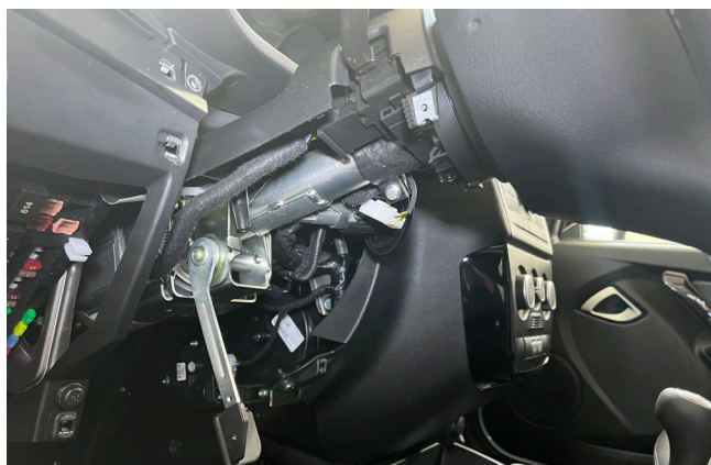
Фото 1.7. Кожух рулевого вала снят
