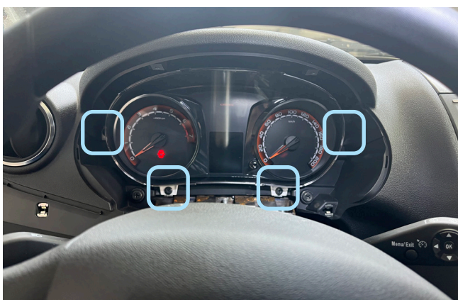
Фото 1.11. Декоративная накладка снята. Саморезы крепления панели приборов
