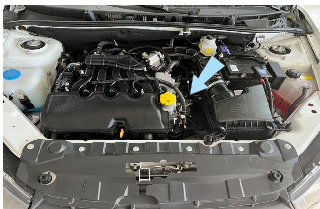
Фото 2.4. Место установки датчика температуры двигателя
