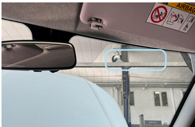
Фото 2.1. Возможное место установки антенного модуля
