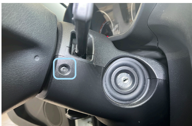
Фото 1.5. Саморез крепления кожуха рулевого вала. Справа
