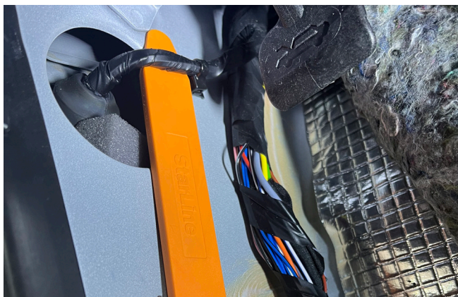
Фото 3.4. Местоположение жгута выходящего из двери водителя
