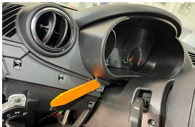
Фото 1.10. Снять декоративную накладку приборной панели
