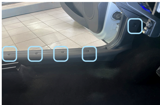
Фото 1.8. Саморезы крепления накладки порога водителя
