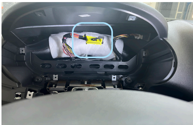
Фото 3.2. Местоположение разъёма панели приборов
