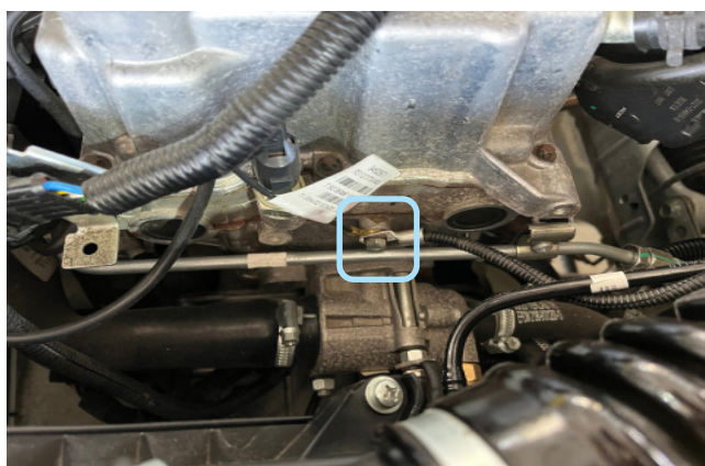
Фото 2.5. Установка датчика температуры двигателя
