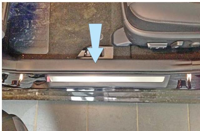
Фото 1.2. Снять накладку порога двери водителя
