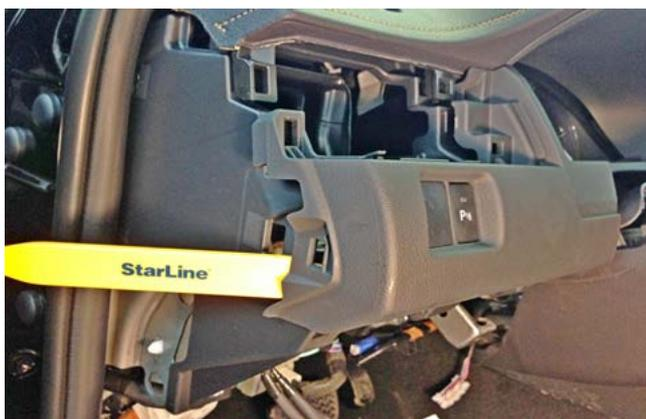
Фото 1.17. Снять декоративную накладку передней панели
