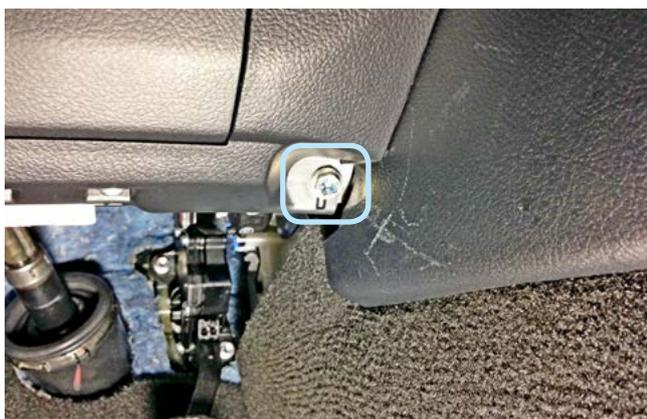
Фото 1.7. Болт крепления накладки под рулевой колонкой справа
