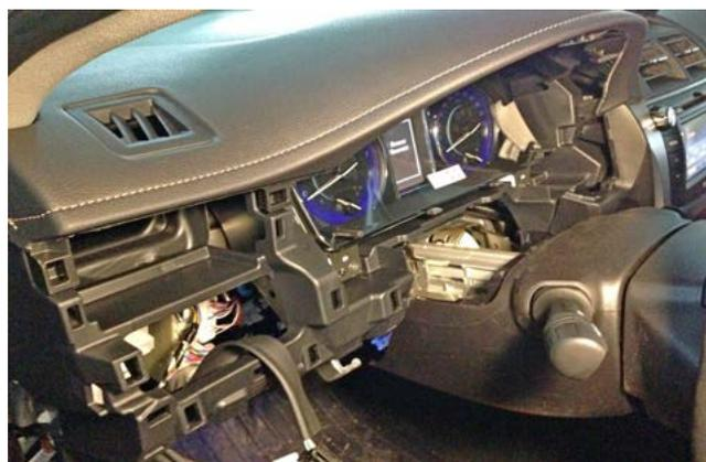
Фото 1.18. Декоративная накладка передней панели снята
