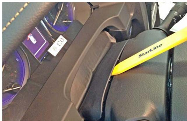
Фото 1.11. Снять пылезащитный чехол кожуха рулевого вала
