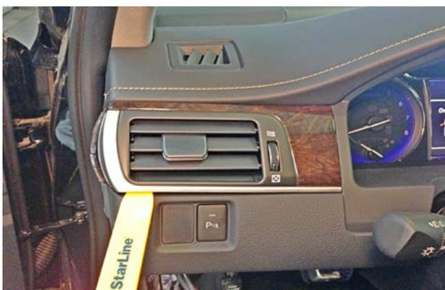
Фото 1.15. Снять левый воздуховод
