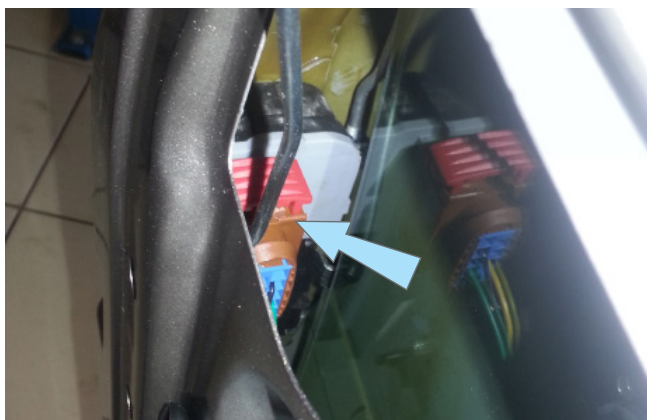
Фото 3.13. Местоположение разъема замка в двери водителя
