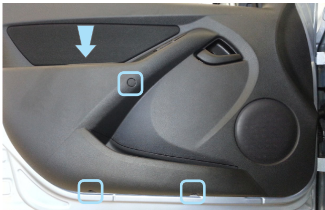
Фото 3.11. Саморезы крепления обшивки двери водителя
