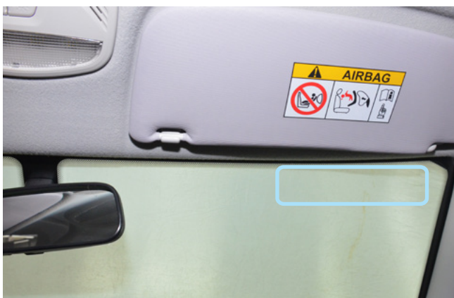
Фото 2.1. Возможное место установки антенного модуля
