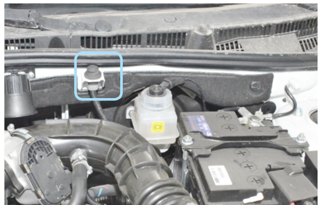
Фото 2.8. Крепление концевика капота
