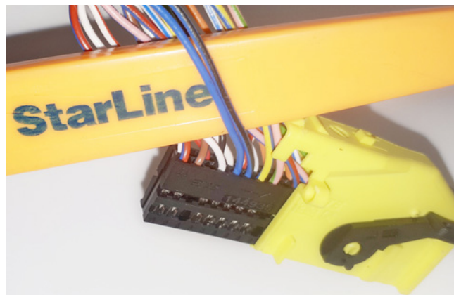
Фото 3.6. Управление световыми сигналами (синий и сине-чёрный)
