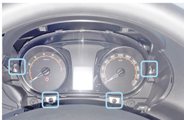
Фото 1.11. Саморезы крепления панели приборов
