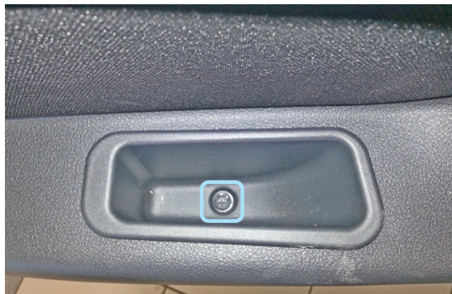
Фото 3.12. Саморез крепления обшивки двери водителя
