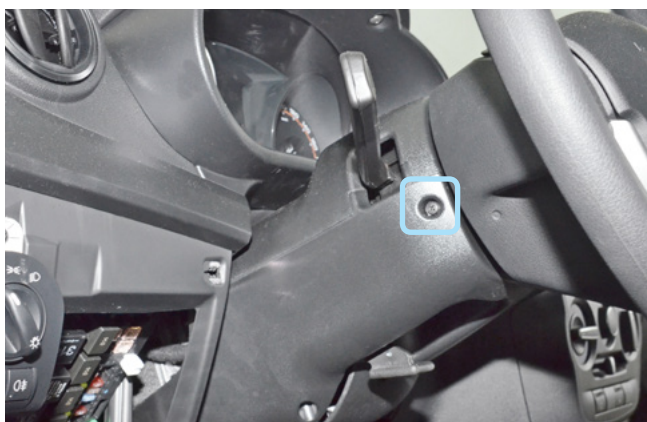
Фото 1.4. Саморез крепления кожуха рулевого вала слева
