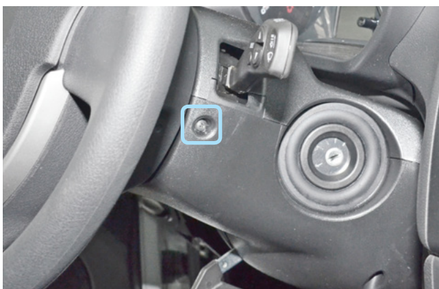
Фото 1.5. Саморез крепления кожуха рулевого вала справа
