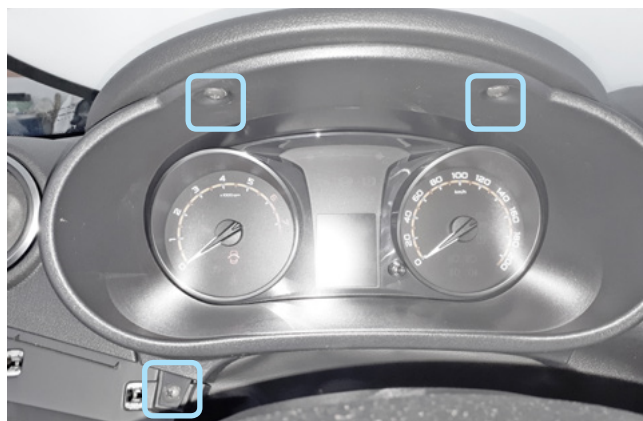
Фото 1.9. Саморезы крепления наклейки панели приборов
