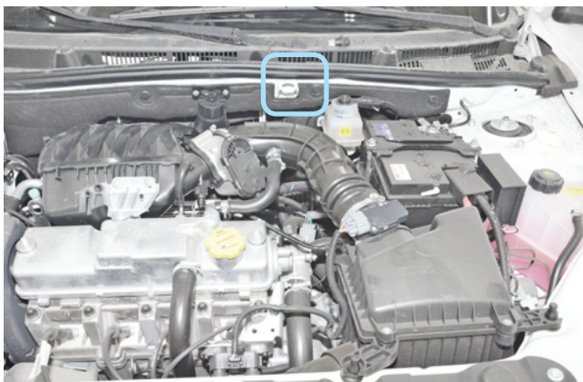
Фото 2.7. Возможное место установки концевика капота
