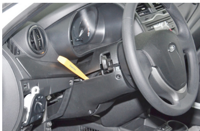
Фото 1.7. Снять кожух рулевого вала
