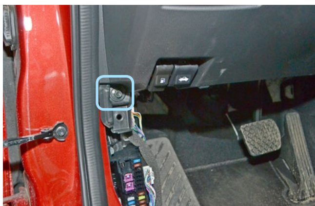
Фото 1.26. Болт крепления накладки под рулевой колонкой
