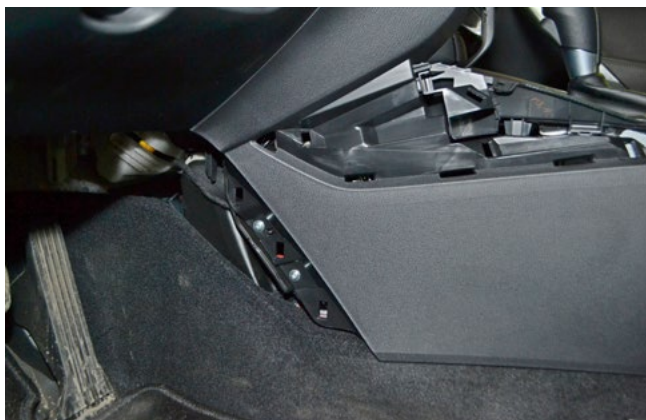
Фото 1.11. Нижняя левая накладка центрального тоннеля снята
