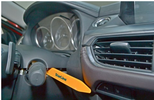
Фото 1.22. Снять верхнюю часть кожура рулевого вала
