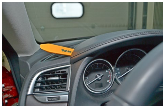
Фото 1.21. Снять декоративную накладку панели приборов
