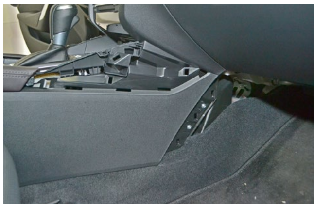
Фото 1.13. Нижняя правая накладка центрального тоннеля снята
