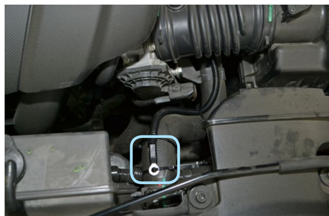
Фото 2.6. Крепление датчика температуры двигателя
