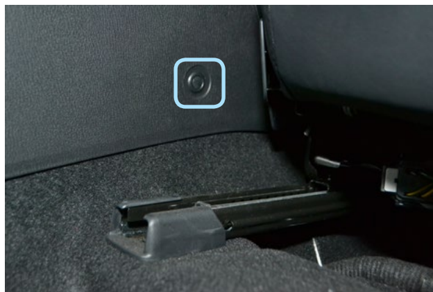
Фото 1.18. Левая клипса крепления центрального тоннеля
