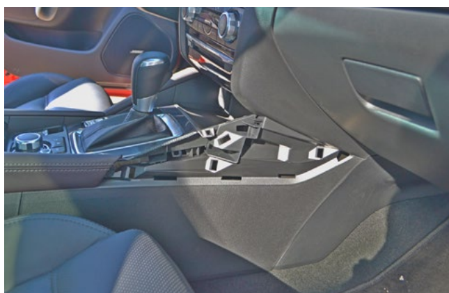
Фото 1.9. Правая накладка снята
