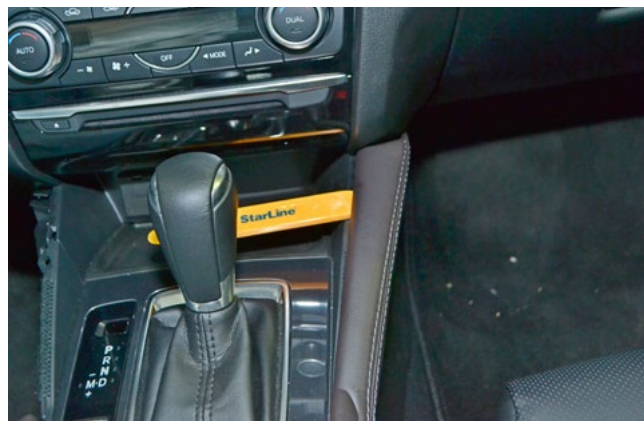
Фото 1.8. Снять накладку справа от рычага коробки передач
