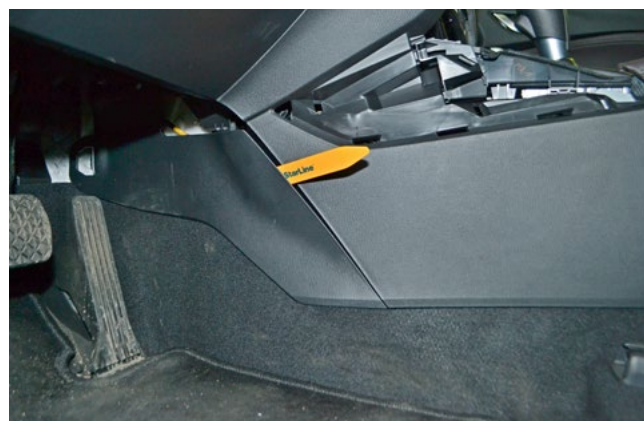
Фото 1.10. Снять нижнюю левую накладку центрального тоннеля
