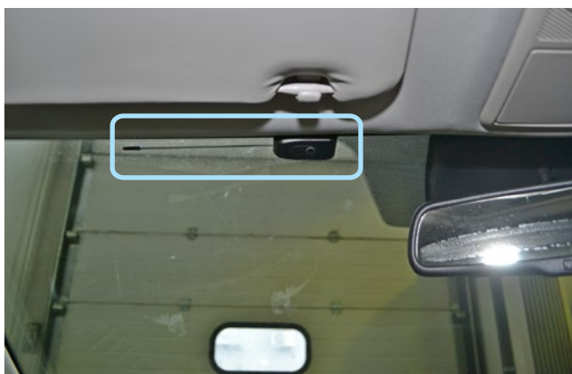
Фото 2.1. Возможное место установки антенного модуля
