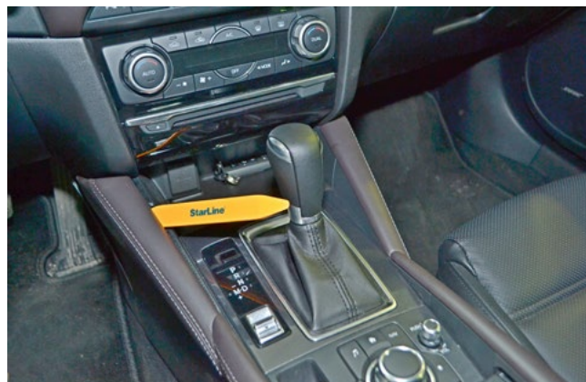
Фото 1.6. Снять накладку слева от рычага коробки передач
