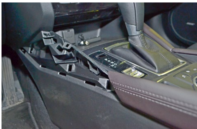
Фото 1.7. Левая накладка снята
