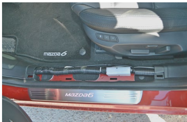
Фото 1.2. Накладка порога двери водителя снята
