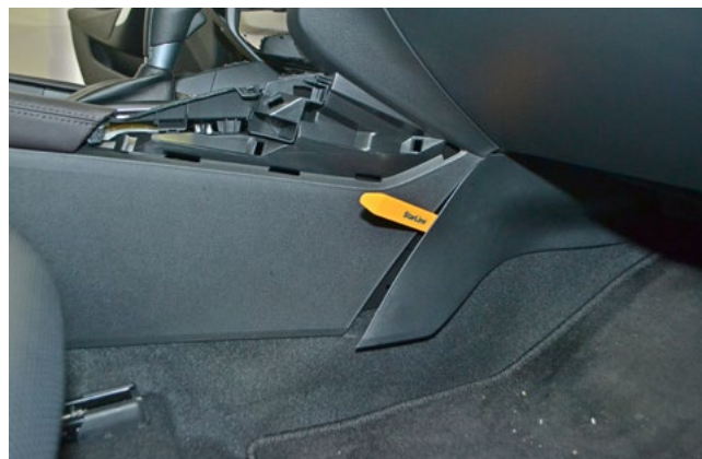
Фото 1.12. Снять нижнюю правую накладку центрального тоннеля
