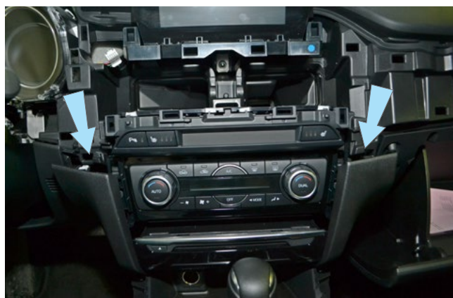
Фото 1.27. Сдвинуть переднюю часть центрального тоннеля
