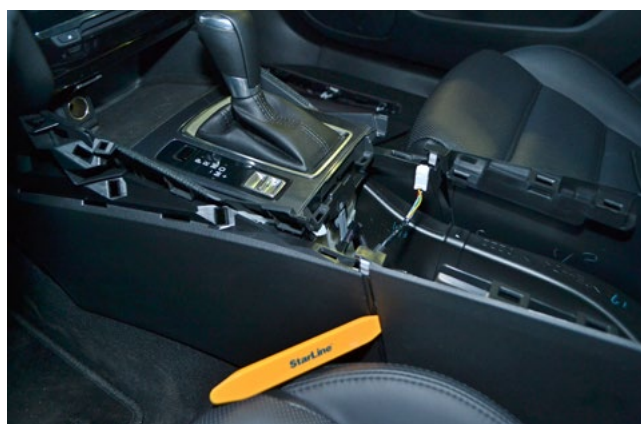
Фото 1.19. Снять заднюю часть центрального тоннеля
