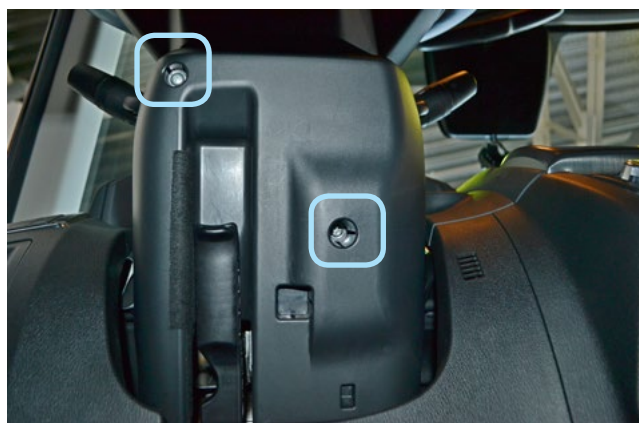
Фото 1.29. Саморезы крепления нижней части кожуха рулевого вала
