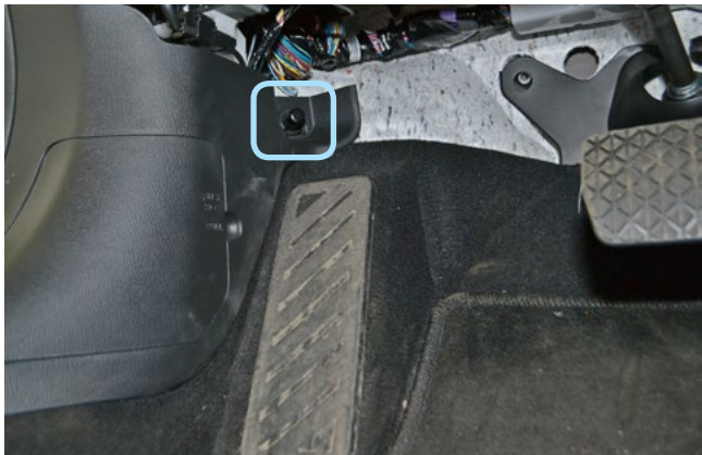
Фото 1.3. Клипса крепления накладки левой кик-панели
