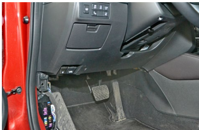
Фото 1.20. Пластиковая накладка под рулевой колонкой. Общий вид
