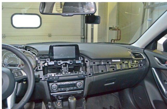
Фото 1.25. Декоративная накладка передней панели снята
