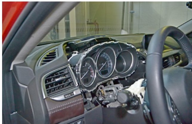
Фото 1.23. Верхняя часть кожура рулевого вала и накладка панели приборов сняты
