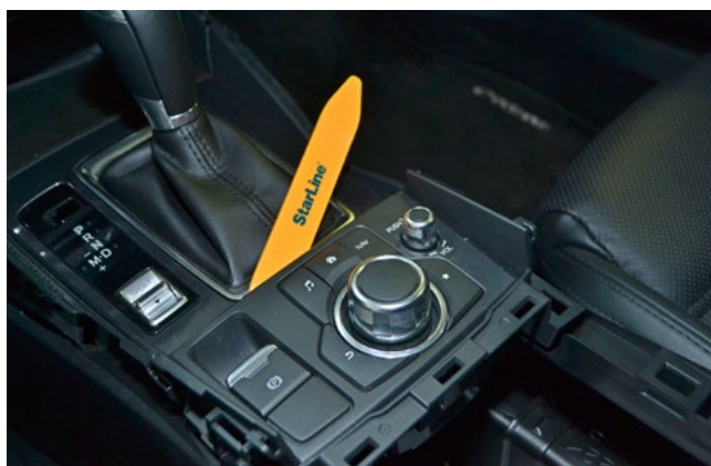
Фото 1.16. Снять блок кнопок
