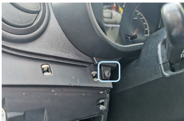
Фото 1.7. Саморезы крепления декоративной накладки
