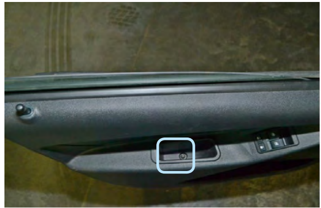
Фото 1.14. Саморез крепления внутренней обшивки двери водителя
