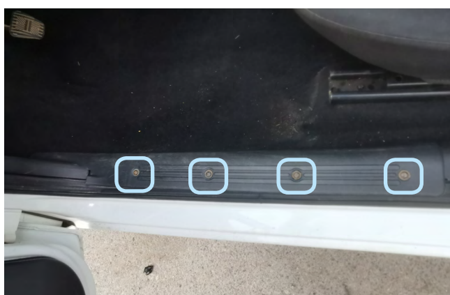
Фото 1.11. Саморезы крепления накладки порога водителя
