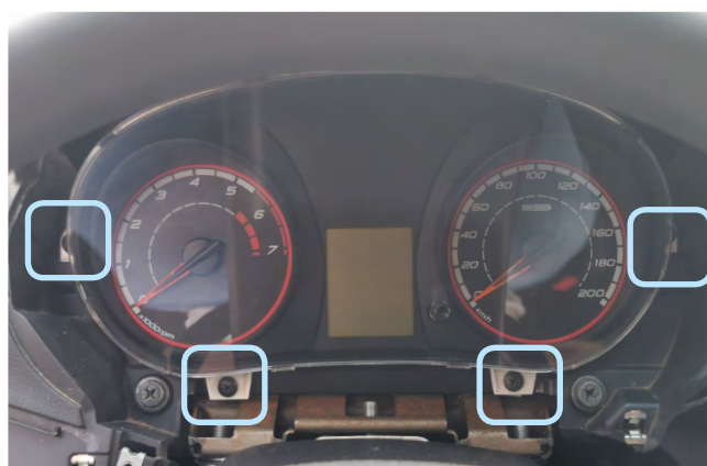
Фото 1.9. Декоративная накладка снята. Саморезы крепления панели приборов
