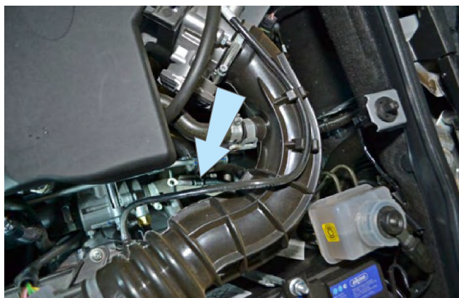
Фото 2.4. Место установки датчика температуры двигателя
