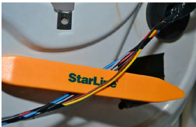
Фото 3.9. Управление центральным замком (красно-зелёный и жёлтый)
