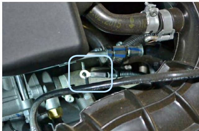
Фото 2.5. Крепление датчика температуры двигателя
