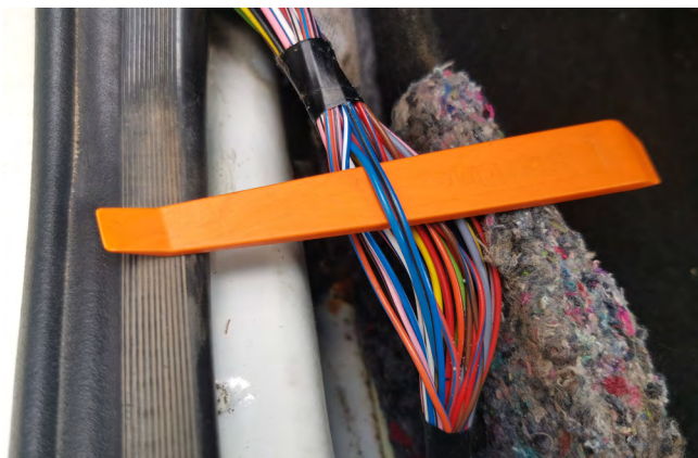
Фото 3.4. Управление световыми сигналами (синий и сине-чёрный)
