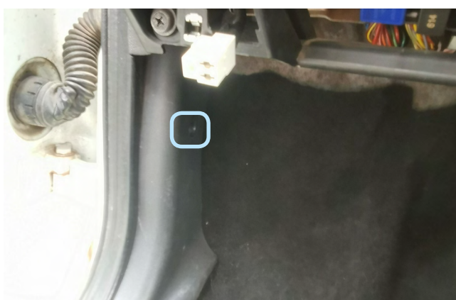
Фото 1.12. Саморез крепления накладки порога водителя
