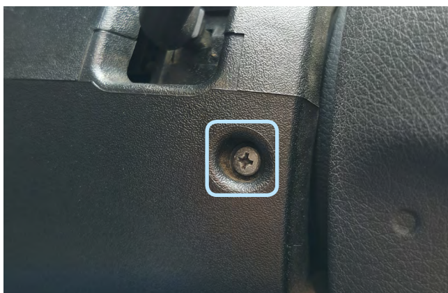
Фото 1.3. Саморез крепления кожуха рулевого вала. Слева
