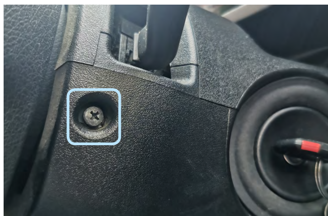
Фото 1.4. Саморез крепления кожуха рулевого вала. Справа
