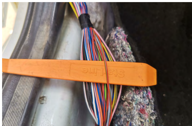
Фото 3.5. Контроль концевиков дверей (красно-зелёный)
