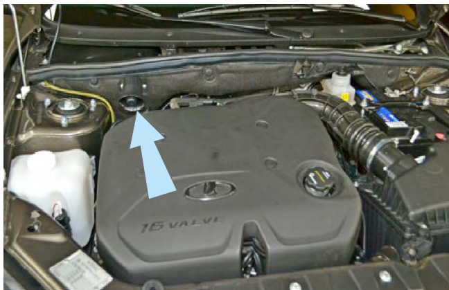
Фото 2.2. Возможное место установки сирены
