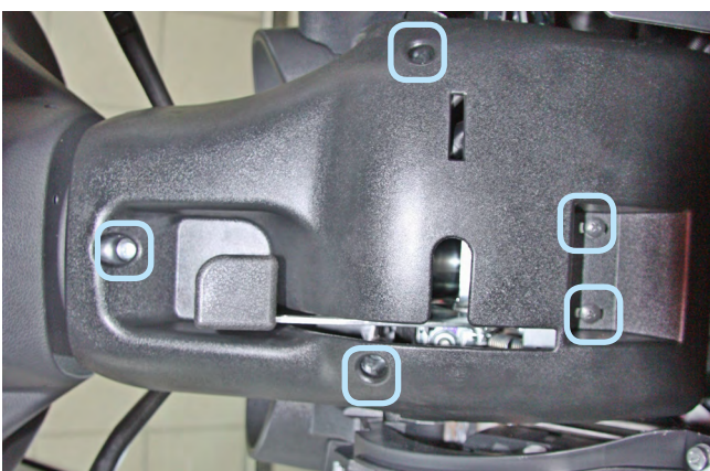
Фото 1.5. Саморезы крепления кожуха рулевого вала. Снизу
