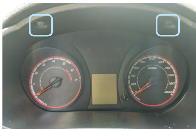
Фото 1.8. Саморезы крепления декоративной накладки
