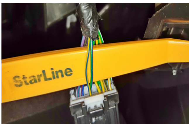
Фото 3.4. Шина CAN-B (жёлто-синий и зелёно-синий)
