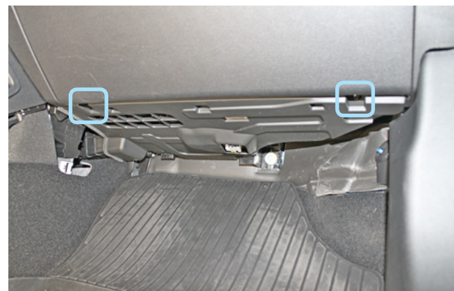
Фото 1.6. Саморезы крепления декоративной накладки
