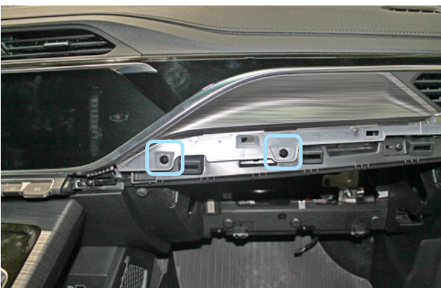
Фото 1.16. Накладка снята. Саморезы крепления
