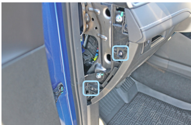
Фото 1.30. Накладка снята. Саморезы
