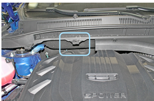
Фото 2.6. Возможное место установки сирены
