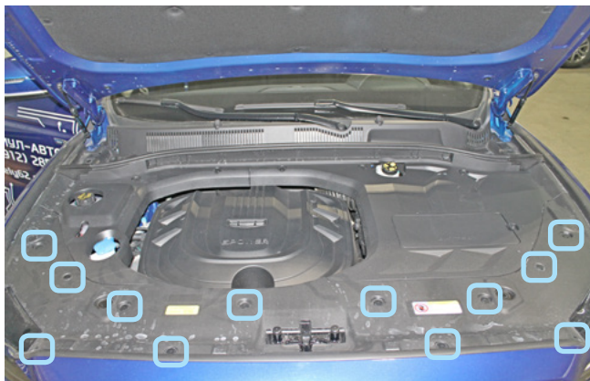
Фото 2.2. Клипсы крепления декоративной накладки
