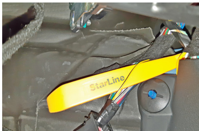
Фото 3.6. Управление центральным замком (жёлто-чёрный)
