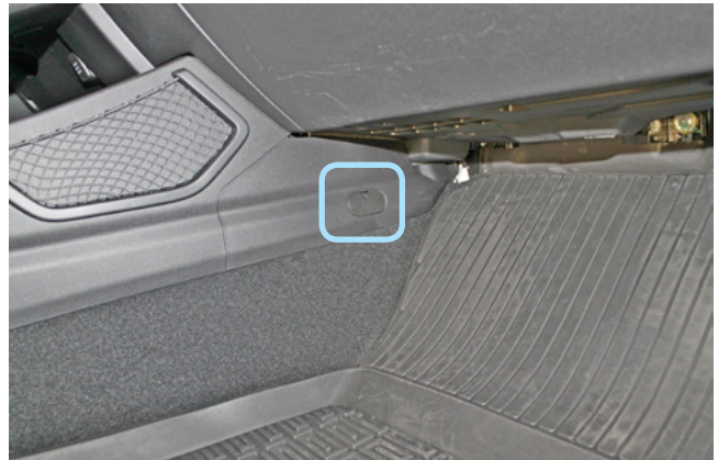
Фото 1.2. Заглушка на накладке центрального тоннеля
