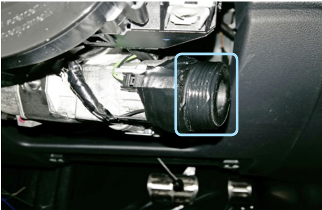
Фото 3.15. Расположение антенны BP-03 на замке зажигания
