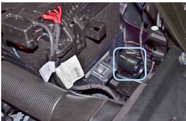
Фото 2.3. Возможное место установки сирены
