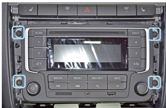
Фото 1.2. Саморезы крепления магнитолы
