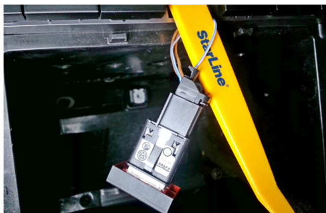
Фото 3.8. Управление световыми сигналами (бело-синий)
