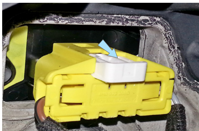
Фото 1.17. Отсоединить разъём подушки безопасности
