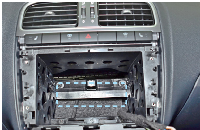
Фото 2.9. Пример расположения центрального блока охранно-телематического комплекса
