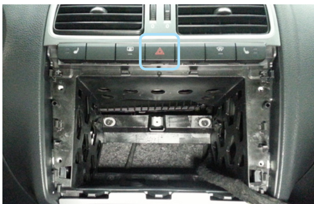
Фото 3.7. Местоположение кнопки аварийной сигнализации
