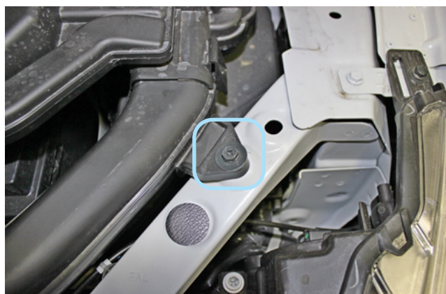
Фото 2.3. Болт крепления воздуховода
