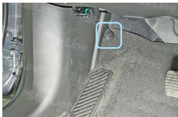
Фото 1.3. Клипса крепления наклейки кик-панели
