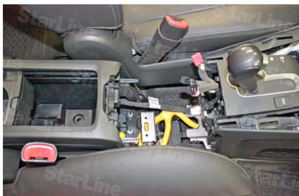
Фото 3.9. Задняя часть центрального тоннеля снята
