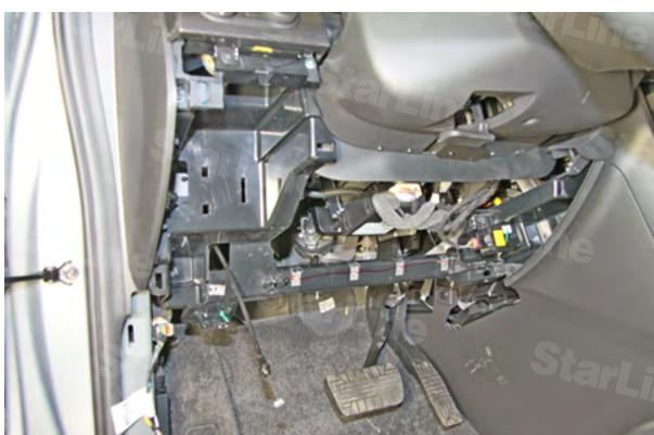
Фото 1.6. Пластиковая наклейка под рулевой колонкой снята
