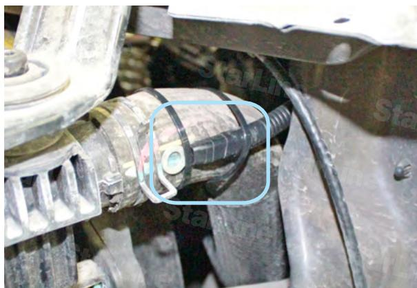
Фото 5.6. Крепление датчика температуры двигателя
