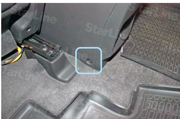
Фото 3.6. Болт крепления задней части центрального тоннеля слева
