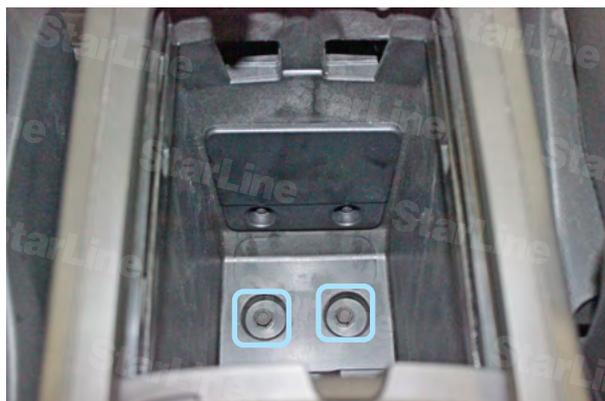
Фото 3.4. Болты крепления задней части центрального тоннеля
