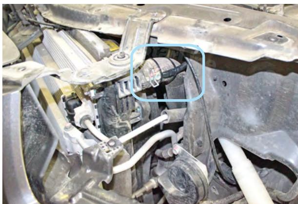
Фото 5.5. Место установки датчика температуры двигателя
