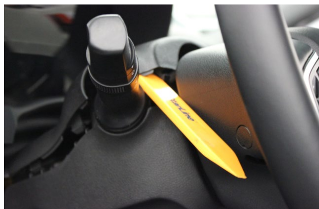
Фото 1.8. Снять верхнюю часть кожуха рулевого вала
