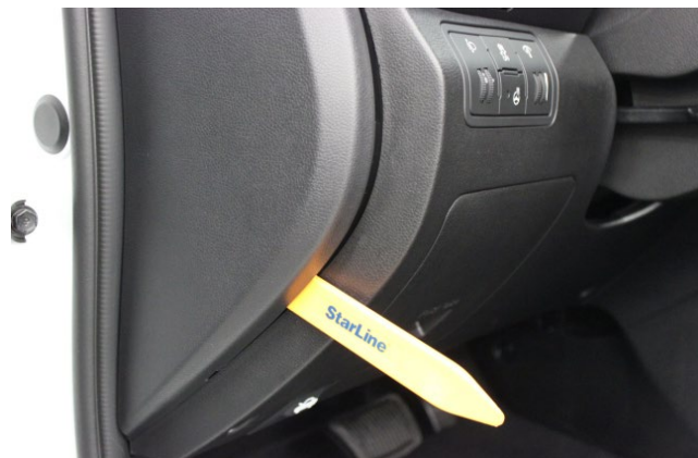
Фото 1.2. Снять левую боковую накладку передней панели
