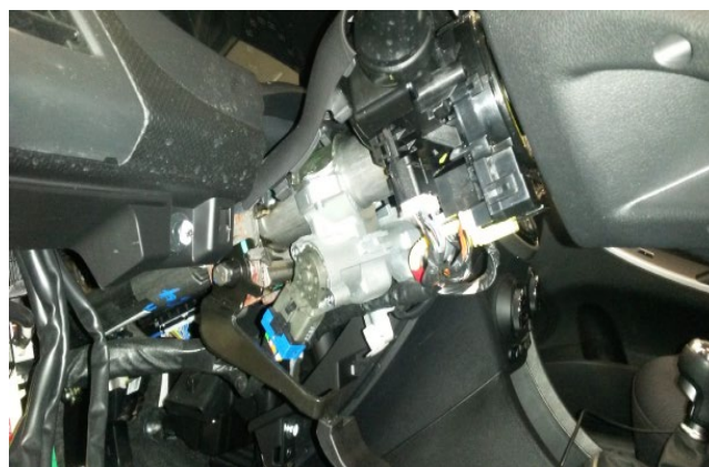
Фото 1.12. Кожух рулевого вала снят
