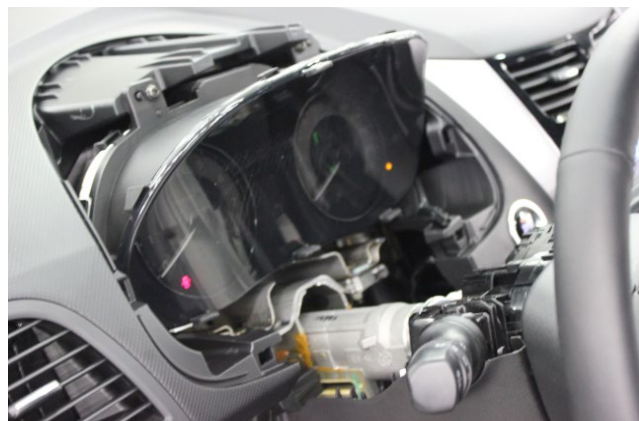
Фото 1.14. Накладка панели приборов снята
