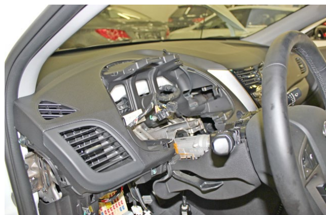
Фото 1.16. Панель приборов снята
