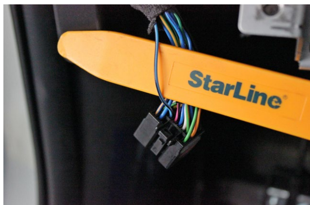
Фото 3.11. Шина данных штатного иммобилайзера (сине-чёрный)
