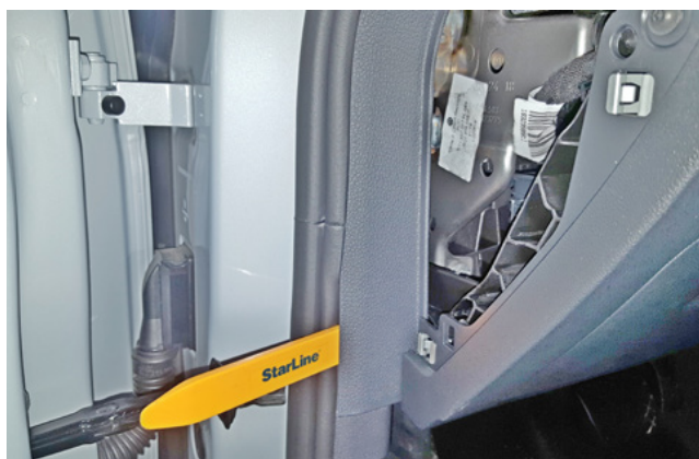
Фото 1.4. Снять накладку левой стойки
