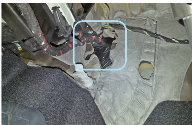
Фото 2.6. Штатный уплотнитель. Вид со стороны салона
