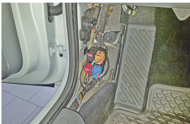
Фото 1.9. Накладка левой кик-панели снята
