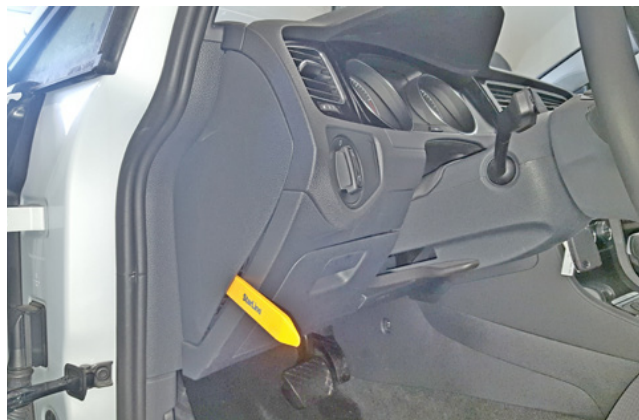
Фото 1.2. Снять боковую накладку передней панели
