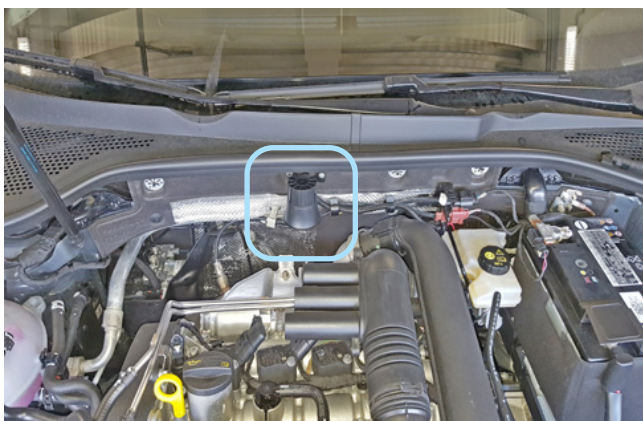
Фото 2.2. Возможное место установки сирены
