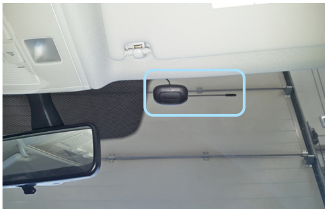
Фото 2.1. Возможное место установки антенного модуля
