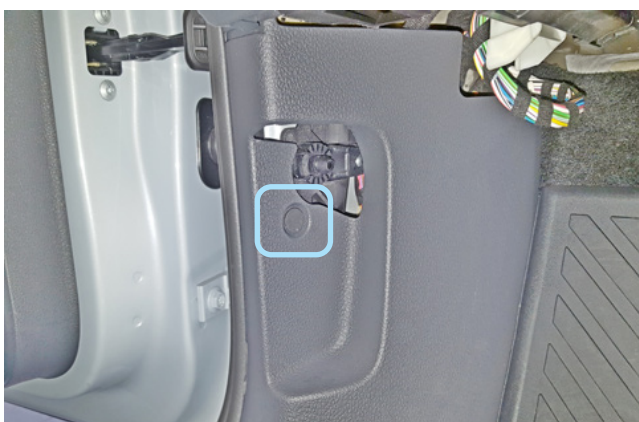
Фото 1.6. Ручка снята. Клипса крепления накладки левой кик-панели
