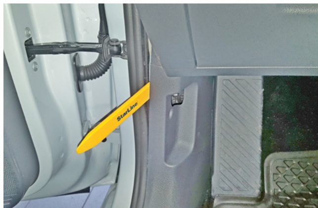
Фото 1.8. Снять накладку левой кик-панели
