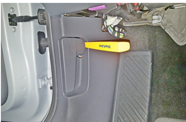
Фото 1.5. Снять ручку отпирания капота
