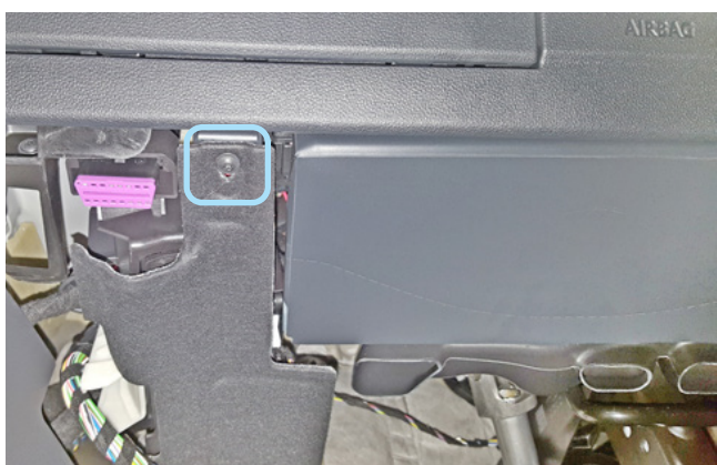
Фото 1.10. Саморез крепления наклада педального узла
