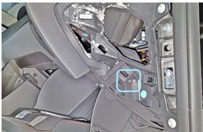
Фото 1.3. Боковая накладка снята. Саморез
