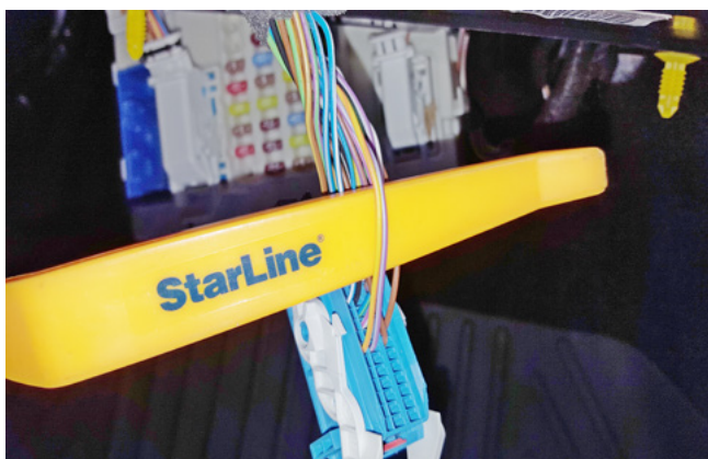
Фото 3.6. Шина данных штатного иммобилайзера (фиолетово-серый и жёлто-оранжевый)
