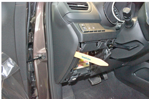
Фото 1.3. Снять боковую накладку передней панели
