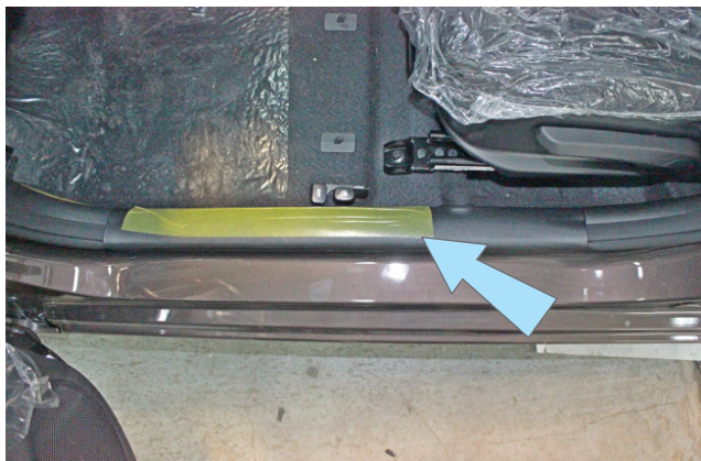
Фото 1.11. Накладка порога двери водителя
