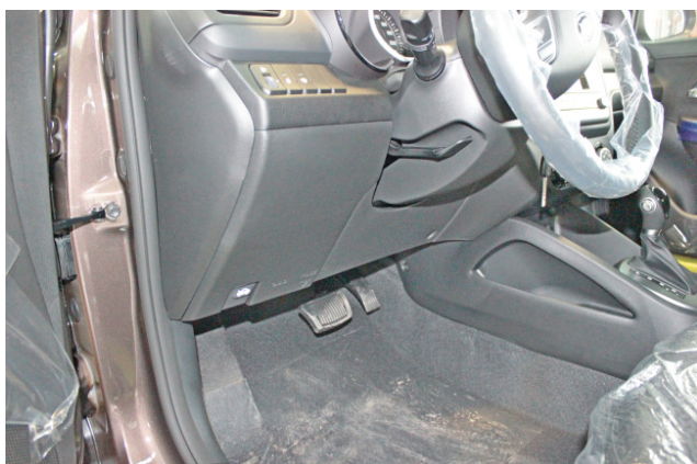
Фото 1.1. Пластиковая накладка под рулевой колонкой. Общий вид
