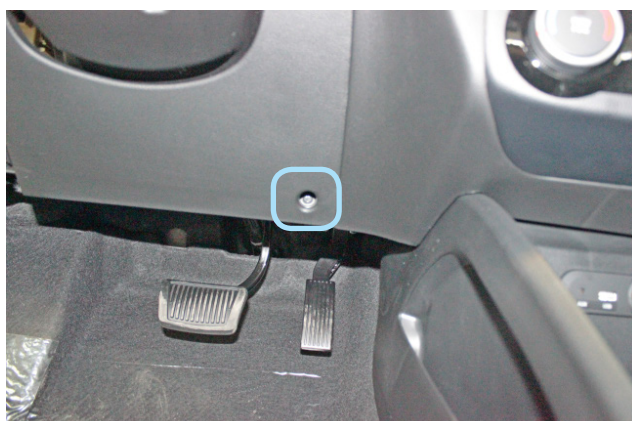
Фото 1.10. Саморез крепления пластиковой накладки под рулевой колонкой
