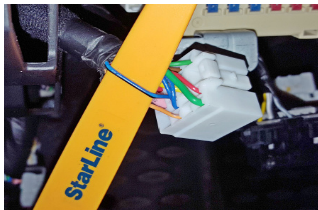
Фото 3.9. Шина данных штатного иммобилайзера (сине-чёрный)
