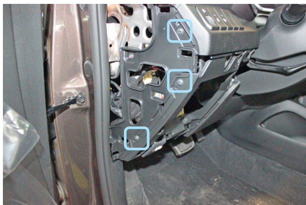
Фото 1.4. Накладка снята. Саморезы
