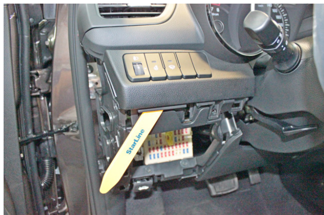
Фото 1.6. Снять блок кнопок слева от рулевой колонки
