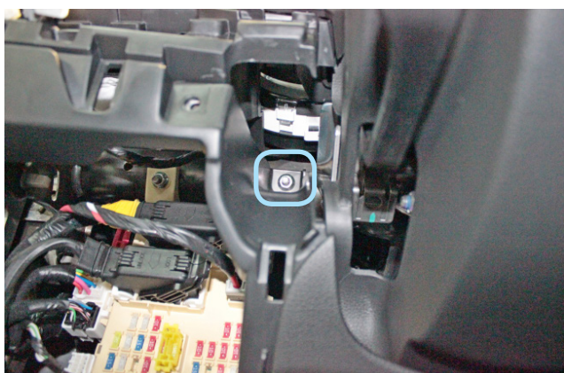
Фото 1.9. Гайка крепления пластиковой накладки под рулевой колонкой
