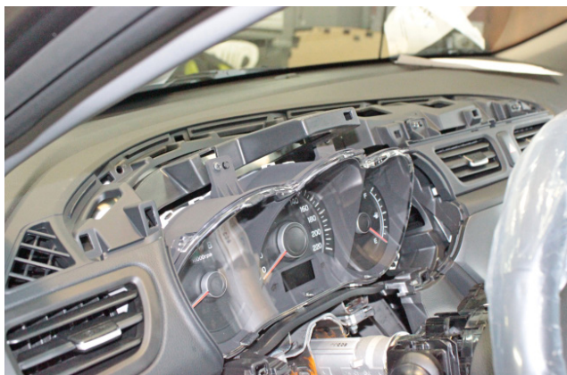
Фото 1.18. Накладка панели приборов снята
