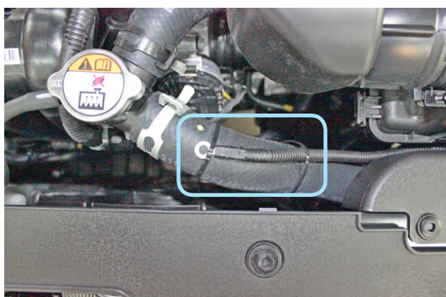
Фото 2.4. Крепление датчика температуры двигателя
