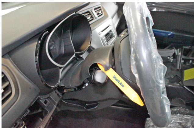
Фото 1.16. Снять верхнюю часть кожуха рулевого вала
