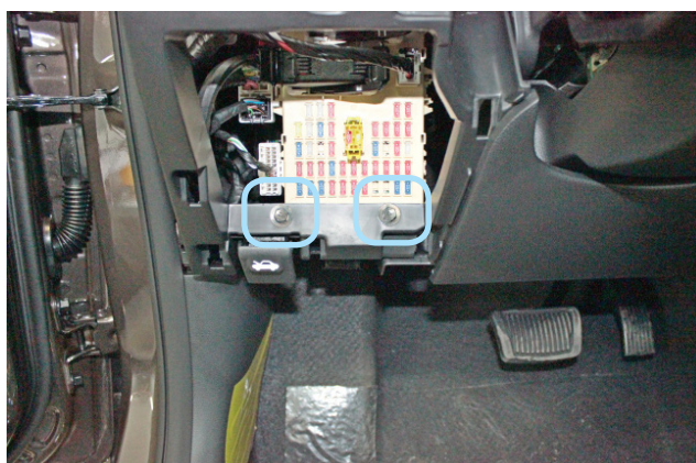
Фото 1.8. Болты крепления пластиковой накладки под рулевой колонкой
