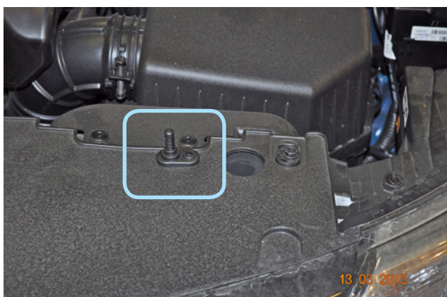
Фото 2.5. Возможное место установки концевика капота
