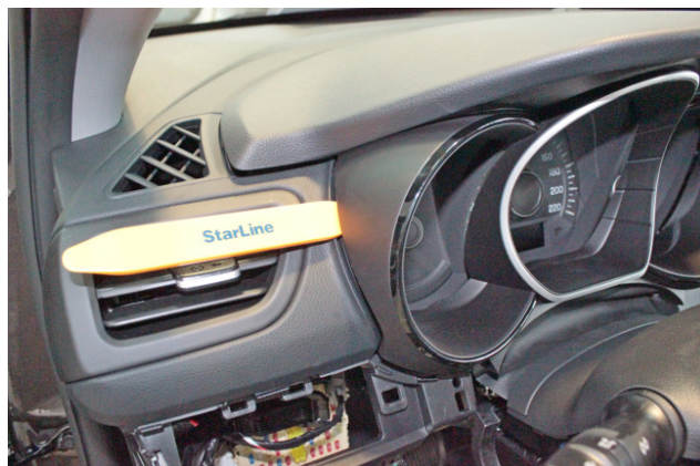
Фото 1.17. Снять декоративную накладку панели приборов
