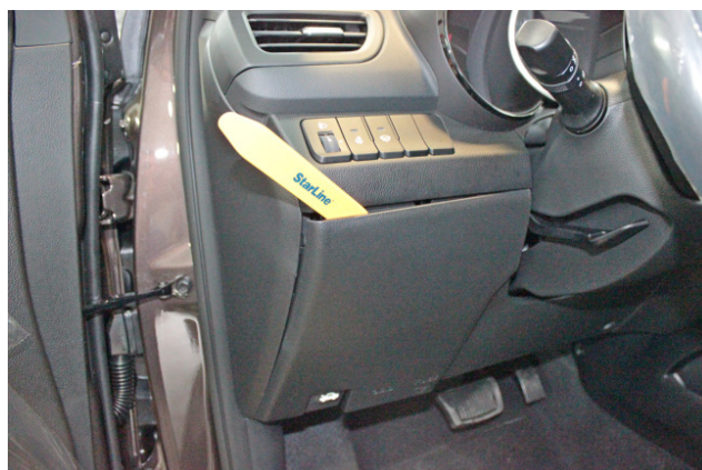
Фото 1.2. Снять крышку монтажного блока предохранителей
