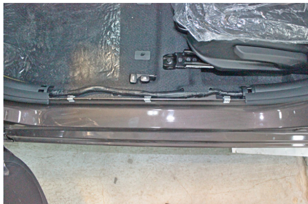
Фото 1.12. Накладка порога двери водителя снята
