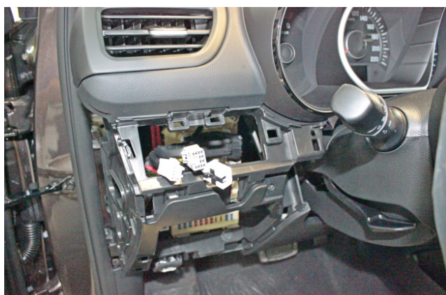
Фото 1.7. Блок кнопок управления снят
