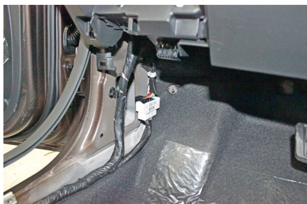
Фото 1.14. Накладка левой кик-панели снята
