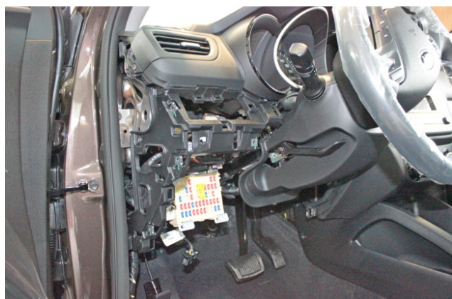
Фото 1.15. Пластиковая накладка под рулевой колонкой снята
