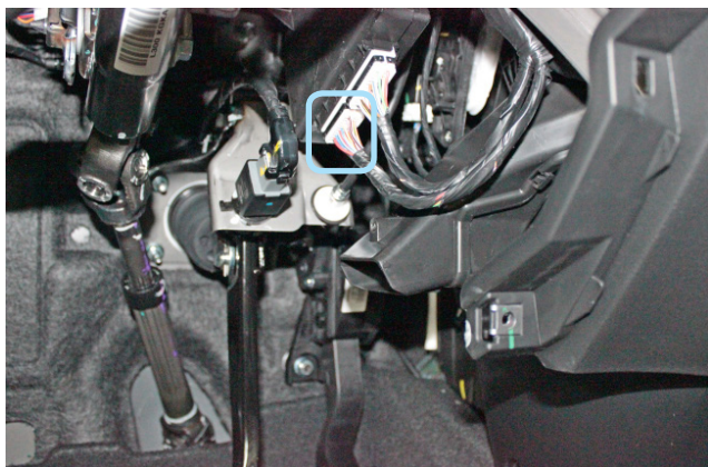
Фото 3.2. Местоположение разъёма на блоке BCM
