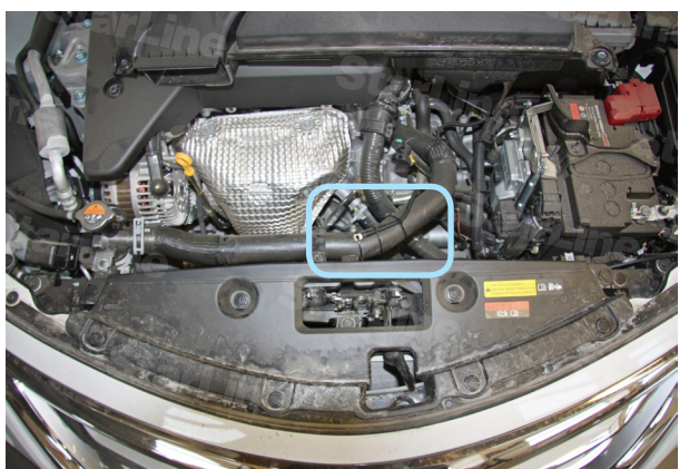
Фото 5.3. Место установки датчика температуры двигателя
