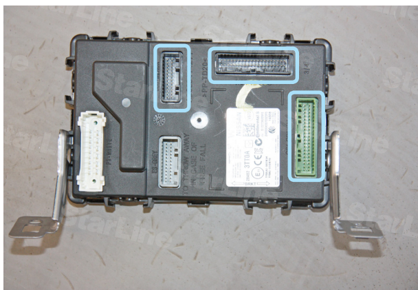
Фото 8. Местоположение разъёмов на блоке BCM
