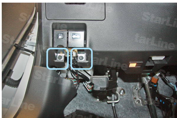
Фото 1.6. Болты крепления ручки отпирания капота и лючка топливного бака
