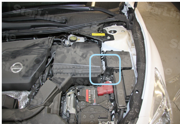
Фото 5.5. Возможное место установки блока R6
