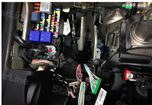
Фото 3.3. Блок BCM снят
