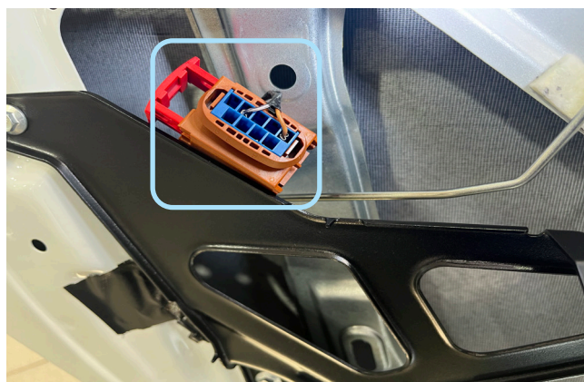
Фото 3.9. Разъём замка двери водителя
