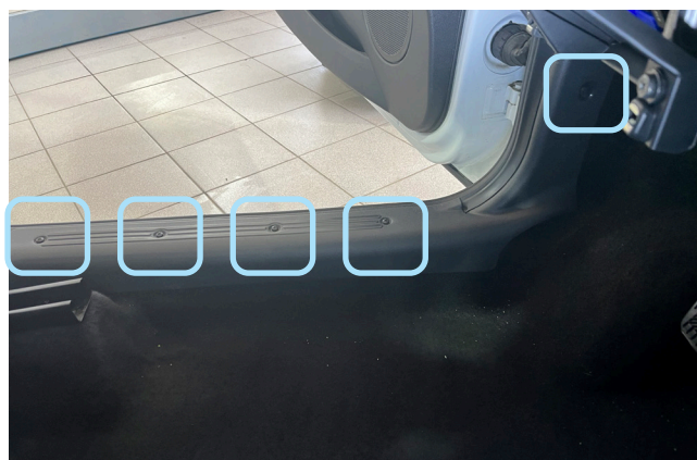
Фото 1.8. Саморезы крепления накладки порога водителя
