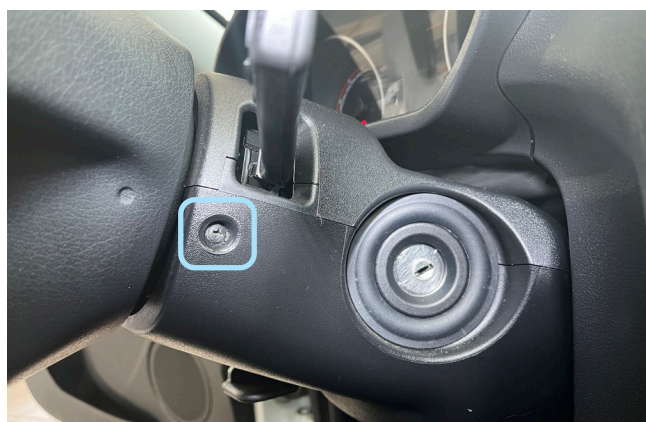
Фото 1.5. Саморез крепления кожуха рулевого вала. Справа
