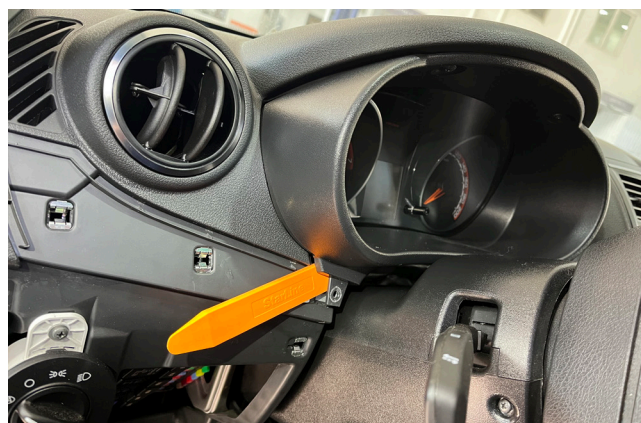
Фото 1.10. Снять декоративную накладку приборной панели
