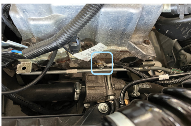
Фото 2.5. Установка датчика температуры двигателя
