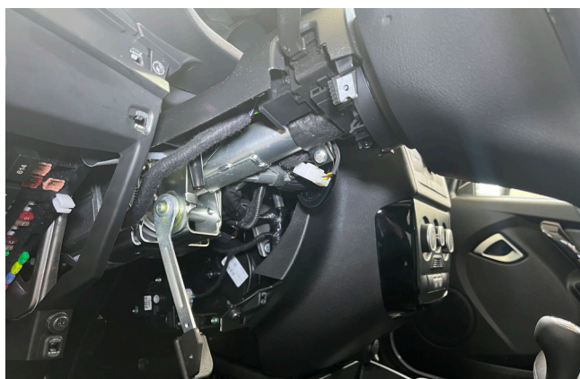
Фото 1.7. Кожуха рулевого вала снят
