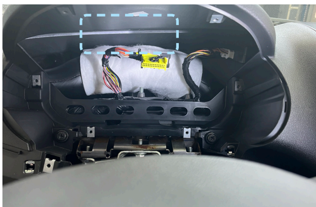
Фото 2.6. Пример расположения центрального блока охранно-телематического комплекса
