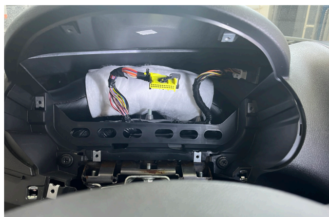
Фото 1.12. Приборная панель снята
