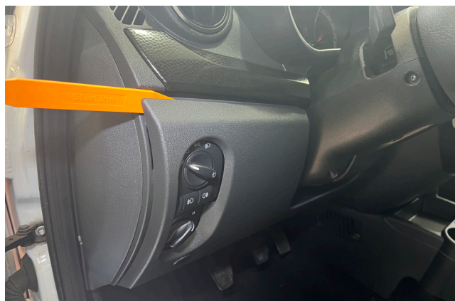
Фото 1.2. Снять пластиковую накладку
