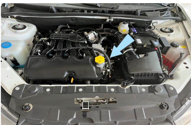
Фото 2.4. Место установки датчика температуры двигателя
