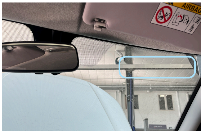
Фото 2.1. Возможное место установки антенного модуля
