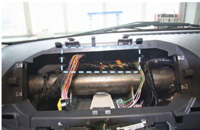
Фото 2.9. Пример расположения центрального блока охранно-телематического комплекса
