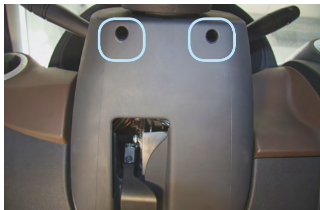
Фото 1.2. Саморезы крепления нижней части
