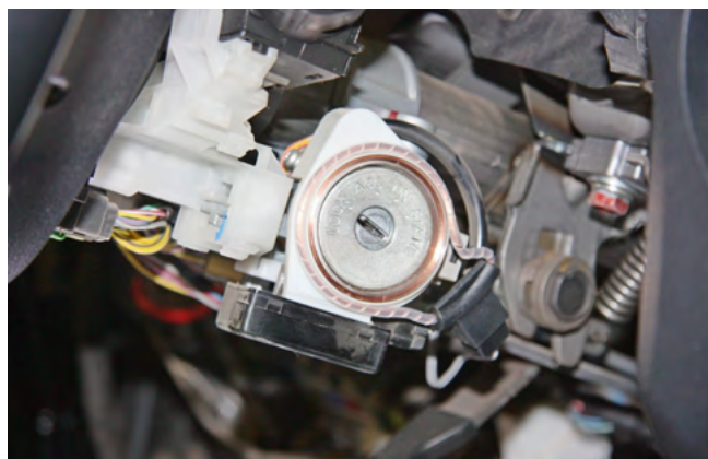
Фото 3.7. Размещение антенны модуля BP-03 на замке зажигания
