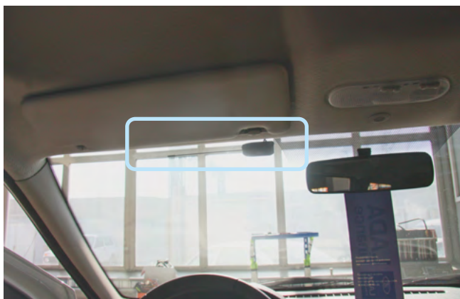
Фото 2.1. Возможное место установки антенного модуля
