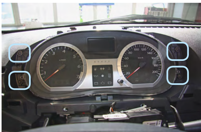
Фото 1.13. Саморезы крепления панели приборов
