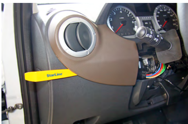
Фото 1.9. Снять левую декоративную накладку панели приборов
