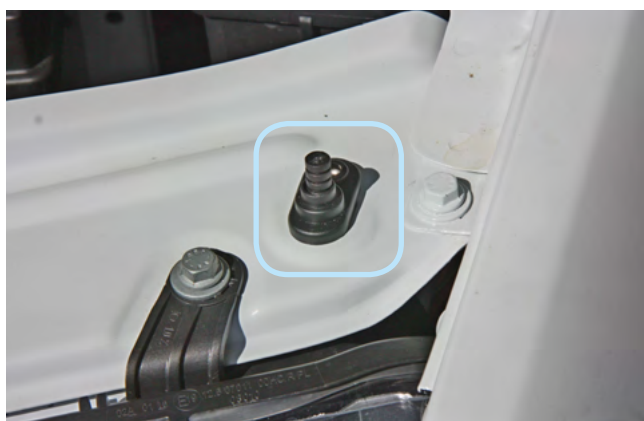
Фото 2.7. Возможное место установки концевика капота
