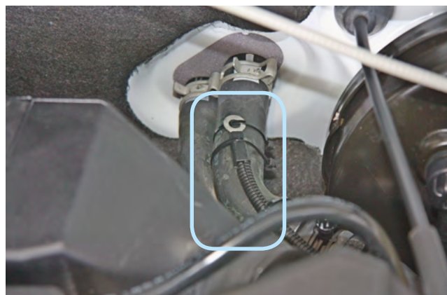
Фото 2.6. Крепление датчика температуры двигателя
