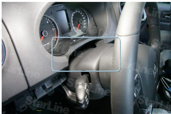
Фото 3.1. Верхняя накладка рулевого кожуха и нижняя накладкая панели приборов
