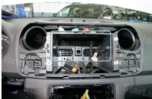
Фото 8. Место установки блока сигнализации
