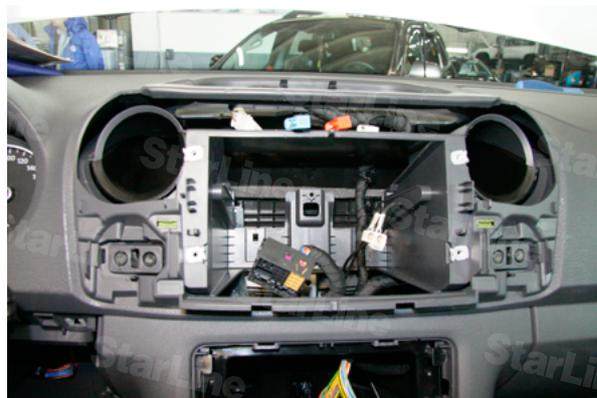
Фото 4.6. Магнитола снята.
