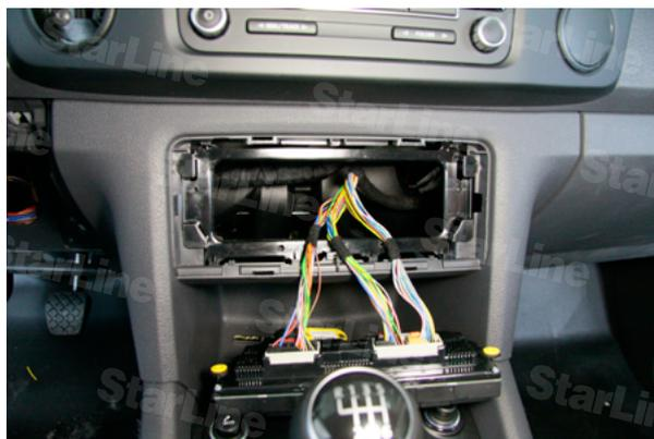
Фото 2.3. Блок климат-контроля снят
