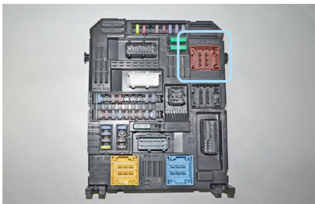
Фото 3.6. Местоположение коричневого разъёма на блоке BSI
