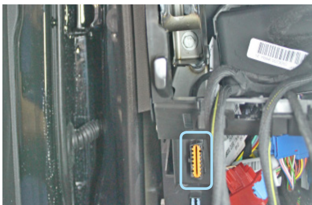
Фото 3.4. Местоположение диагностического разъёма
