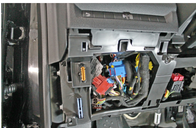
Фото 1.3. Пластиковая накладка под рулевой колонкой снята
