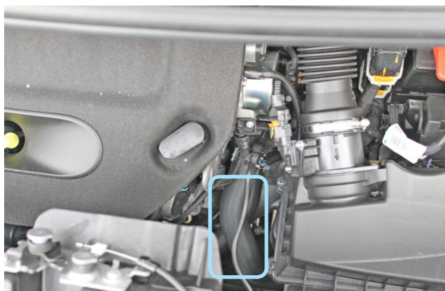
Фото 2.3. Место установки датчика температуры двигателя
