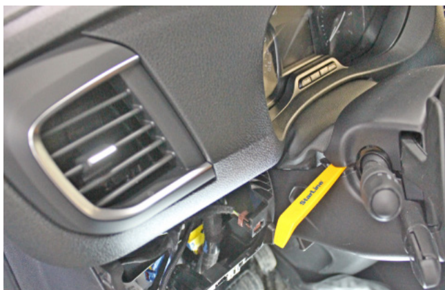
Фото 1.9. Снять нижнюю часть кожуха рулевого вала
