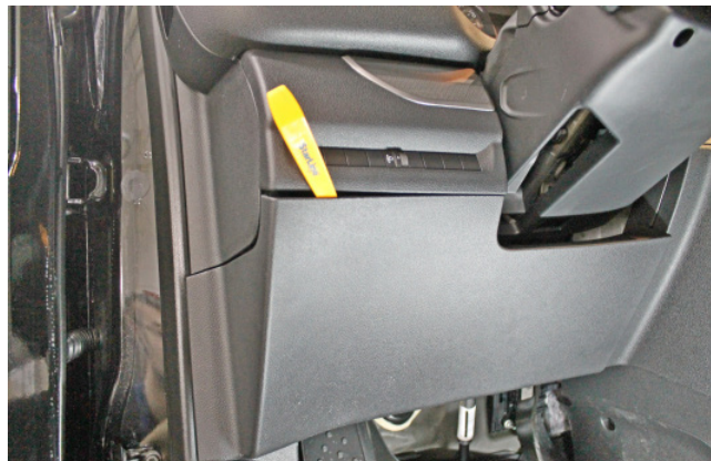
Фото 1.2. Снять пластиковую накладку под рулевой колонкой
