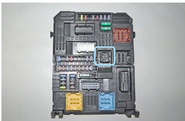
Фото 3.18. Местоположение чёрного разъёма на блоке BSI
