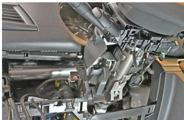
Фото 1.10. Нижняя часть кожуха рулевого вала снята
