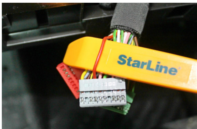
Фото 3.8. Контроль концевика сдвижной левой двери (красный)
