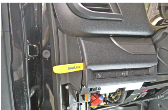
Фото 1.5. Снять блок кнопок
