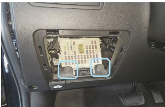
Фото 1.5. Болты крепления пластиковой накладки
