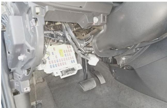
Фото 1.7. Пластиковая накладка снята
