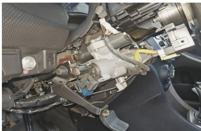
Фото 1.13. Кожух рулевого вала снят
