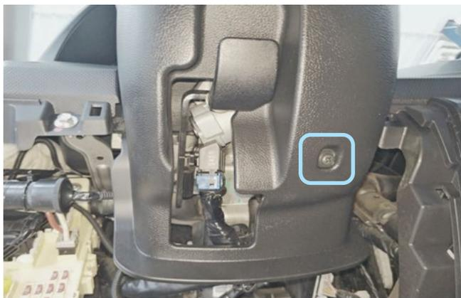
Фото 1.12. Саморез крепления кожуха рулевого вала снизу
