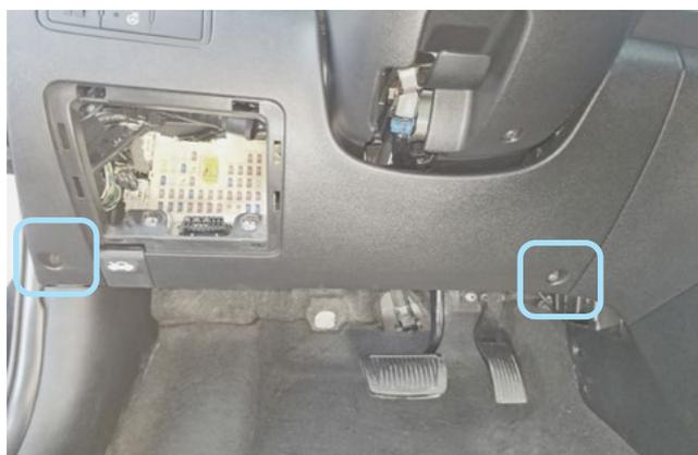
Фото 1.6. Саморезы крепления пластиковой накладки
