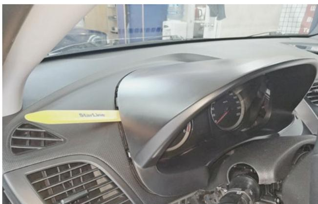
Фото 1.14. Снять декоративную накладку панели приборов
