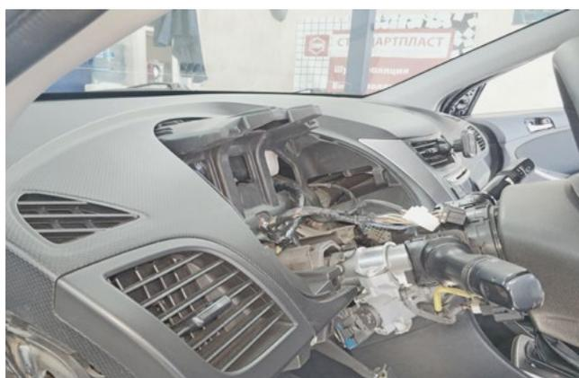
Фото 1.17. Панель приборов снята
