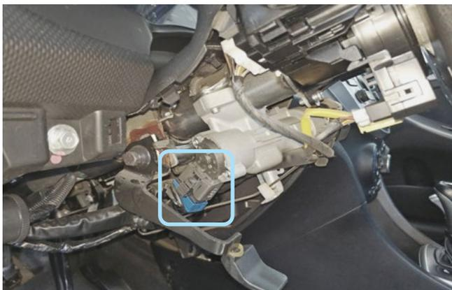
Фото 3.14. Местоположение разъёма
