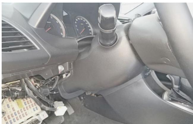
Фото 1.8. Защитный кожух рулевого вала. Общий вид
