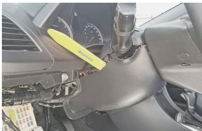
Фото 1.9. Снять верхнюю часть кожуха рулевого вала
