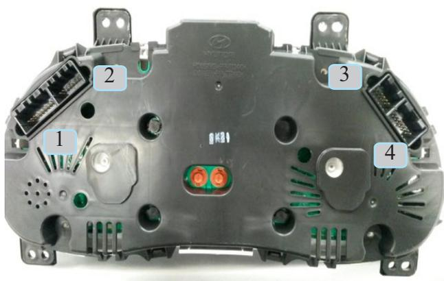
Фото 3.2. Нумерация разъёмов панели приборов
