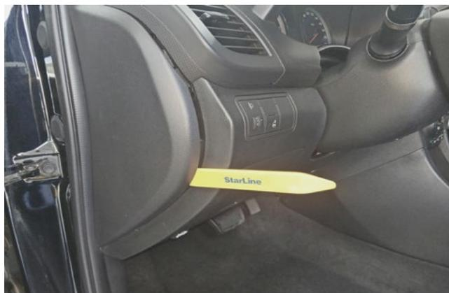
Фото 1.2. Снять левую накладку передней панели
