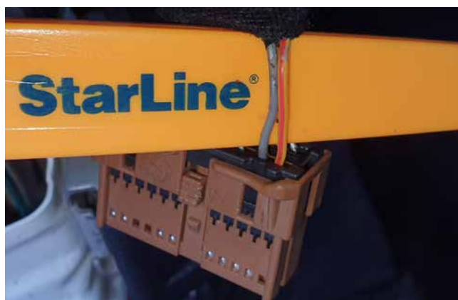
Фото 3.9. Управление центральным замком (жёлто-оранжевый и серый)
