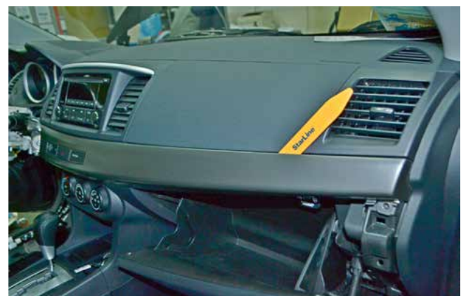
Фото 1.22. Снять продольную декоративную накладку передней панели
