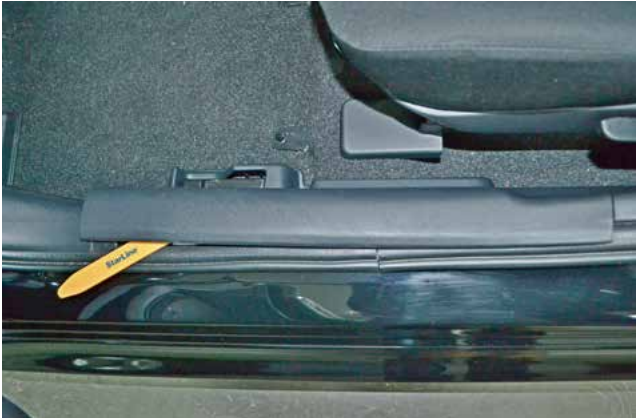
Фото 1.1. Снять накладку порога двери водителя
