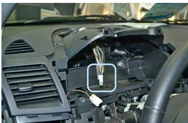
Фото 3.2. Местоположение разъёма панели приборов
