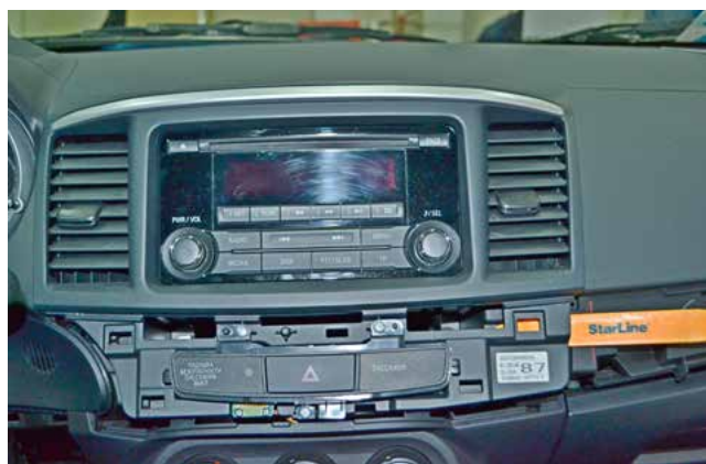
Фото 1.26. Снять декоративную накладку магнитолы
