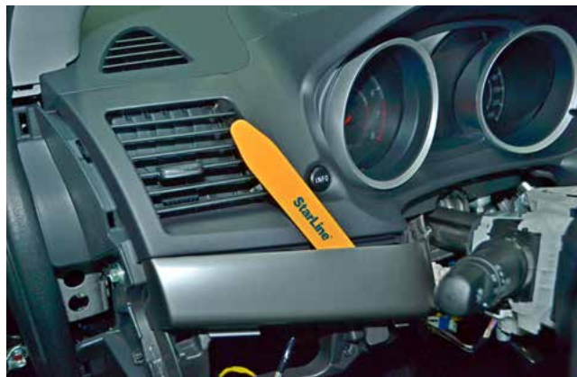
Фото 1.24. Снять левую декоративную накладку передней панели
