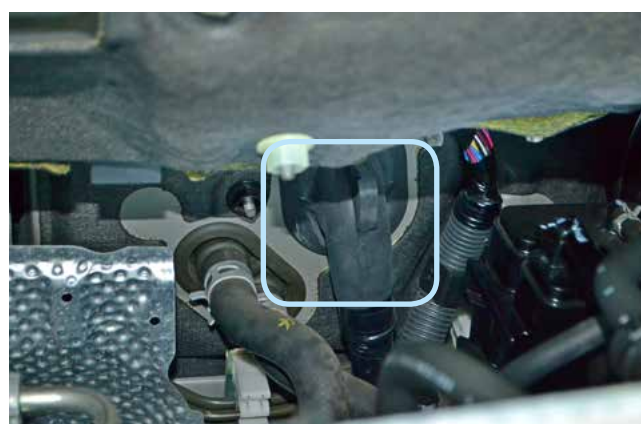
Фото 2.7. Штатный уплотнитель. Вид со стороны капота
