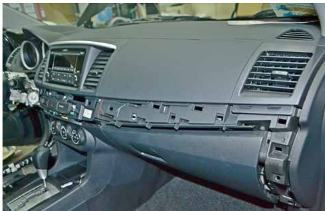
Фото 1.23. Продольная накладка передней панели снята
