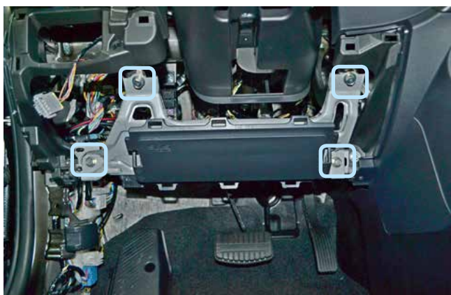
Фото 1.12. Болты крепления коленной подушки безопасности водителя
