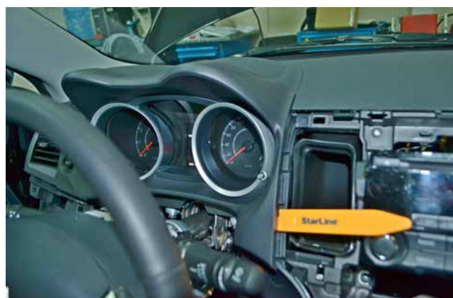
Фото 1.28. Снять пластиковую накладку панели приборов
