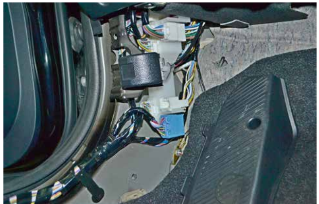
Фото 1.4. Пластиковая накладка левой кик-панели снята
