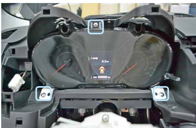
Фото 1.31. Саморезы крепления панели приборов
