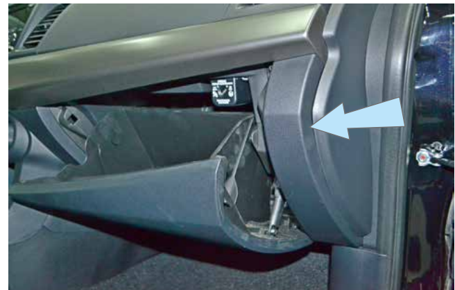
Фото 1.20. Пластиковая накладка справа от перчаточного ящика
