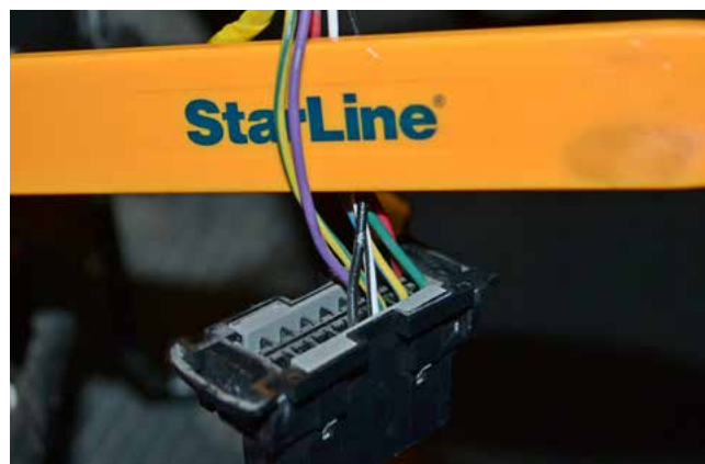
Фото 3.5. Шина CAN-B (жёлто-зелёный и фиолетовый)
