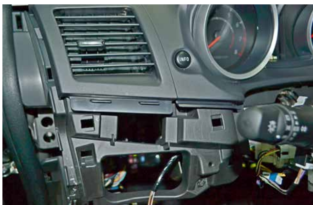
Фото 1.25. Левая накладка передней панели снята
