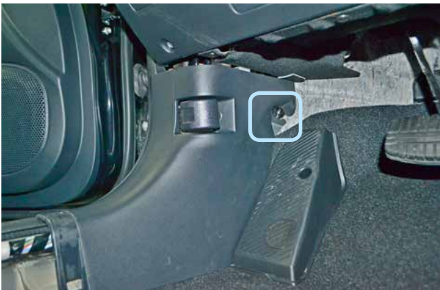
Фото 1.3. Клипса крепления накладки левой кик-панели
