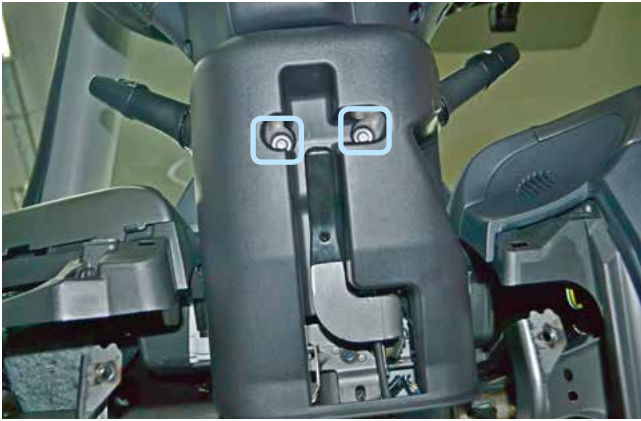
Фото 1.17. Саморезы крепления нижней части кожуха рулевого вала
