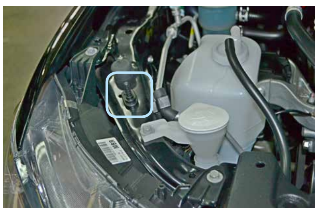
Фото 2.6. Возможное место установки концевика капота
