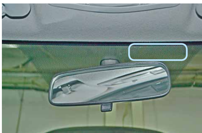
Фото 2.1. Возможное место установки антенного модуля
