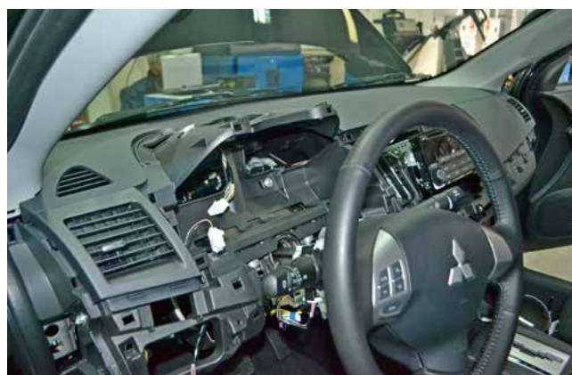
Фото 1.32. Панель приборов снята
