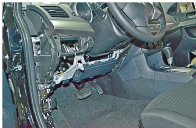
Фото 1.11. Накладка под рулевой колонкой снята
