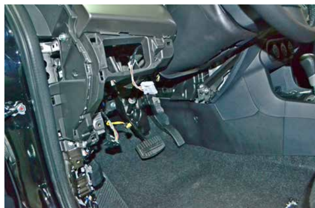
Фото 1.13. Подушка безопасности снята
