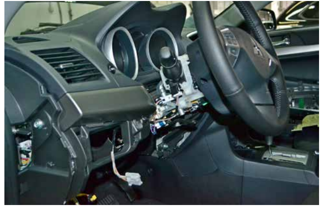
Фото 1.18. Кожух рулевого вала снят
