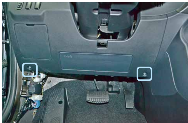
Фото 1.10. Саморезы крепления накладки под рулевой колонкой
