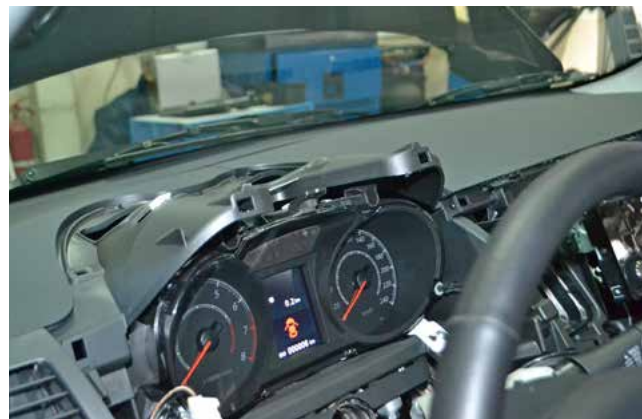
Фото 1.30. Верхняя накладка панели приборов снята
