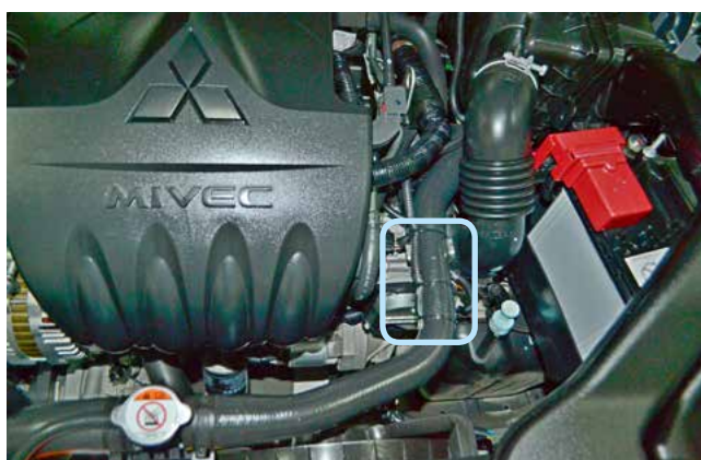
Фото 2.4. Место установки датчика температуры двигателя
