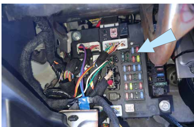
Фото 1.14. Местоположение блока ETACS
