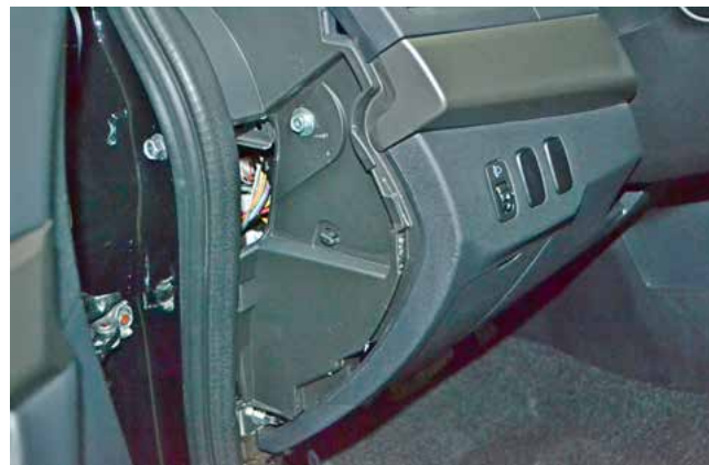
Фото 1.9. Левая боковая накладка передней панели снята
