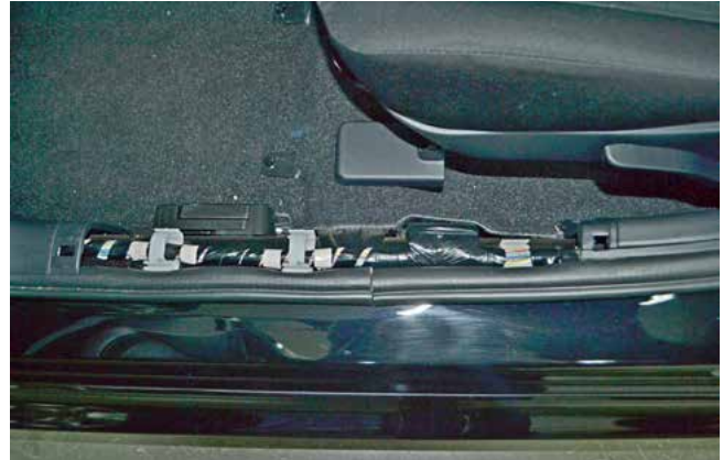
Фото 1.2. Накладка порога двери водителя снята
