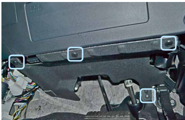
Фото 1.6. Клипсы крепления накладки педального узла
