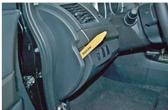
Фото 1.8. Снять левую боковую накладку передней панели
