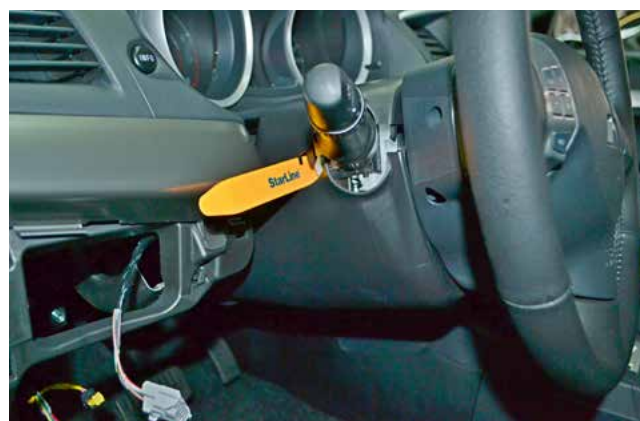
Фото 1.16. Снять верхнюю часть кожуха рулевого вала
