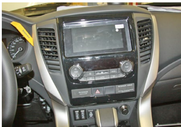
Фото 1.11. Снять блок управления системой климат-контроля
