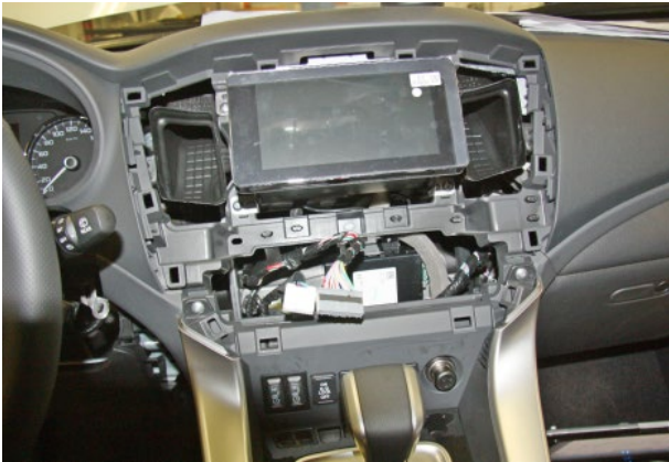
Фото 1.12. Блок управления системой климат-контроля снят
