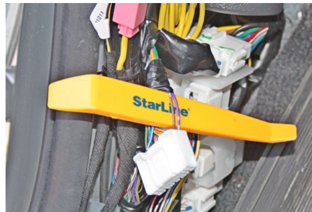
Фото 3.7. Управление центральным замком (фиолетовый и коричневый)
