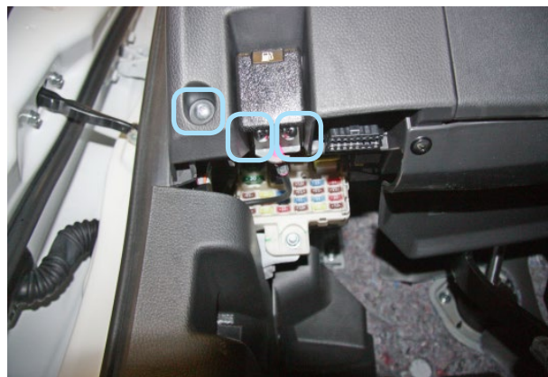
Фото 1.4. Саморезы крепления ручки отпирания лючка и пластиковой наклейки
