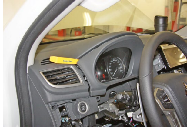
Фото 1.13. Снять декоративную накладку
