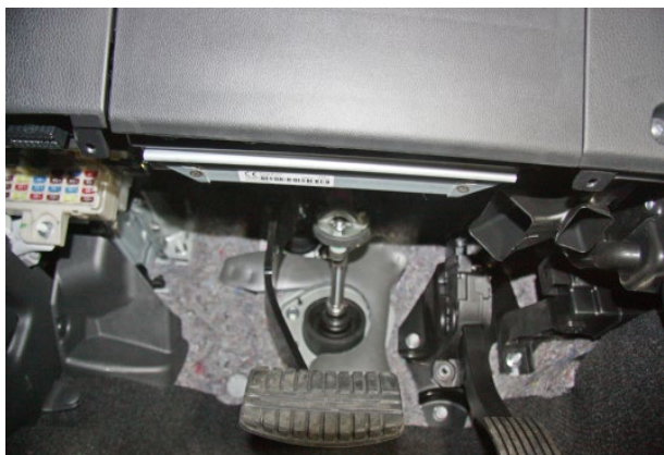
Фото 1.3. Защитная накладка снята
