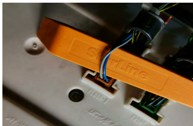
Фото 3.3. Шина CAN-A (серый и синий)
