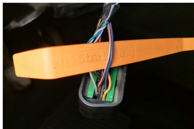
Фото 3.5. Шина CAN-B (серо-красный и сине-красный)
