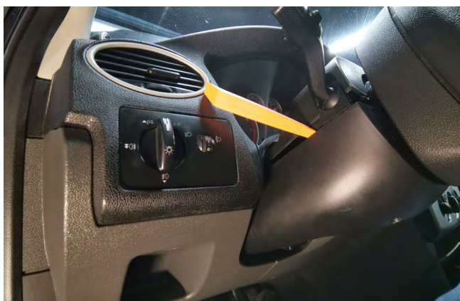
Фото 1.7. Снять нижнюю часть кожуха рулевой колонки
