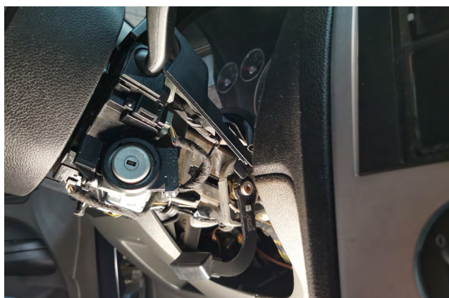
Фото 1.8. Нижняя часть кожуха рулевой колонки снята.
