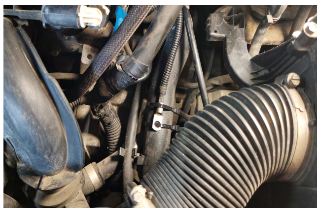
Фото 2.5. Крепление датчика температуры двигателя
