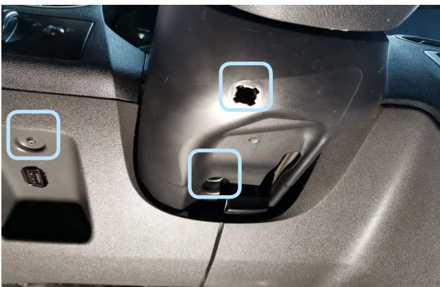
Фото 1.5. Саморезы крепления пластиковой наклейки и рулевой колонкой.
