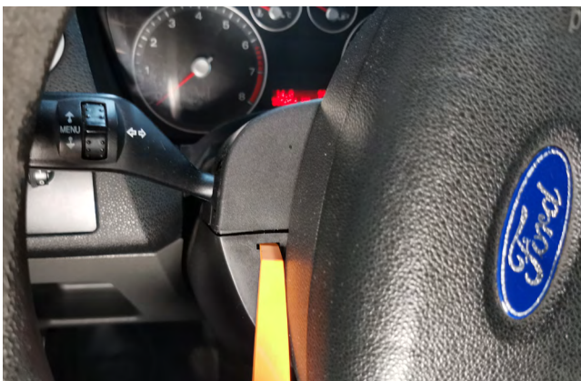
Фото 1.6. Снять верхнюю кожу рулевой колонки.
