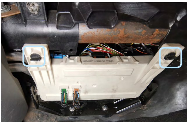
Фото 1.3. Клипсы крепления блока GEM.
