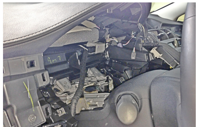
Фото 1.34. Панель приборов снята
