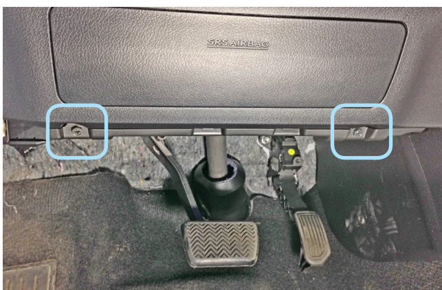
Фото 1.5. Саморезы крепления накладки педального узла
