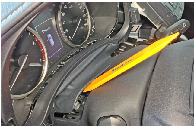
Фото 1.19. Снять пылезащитный кожух рулевой колонки
