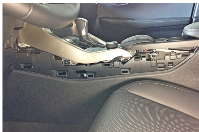
Фото 1.10. Левая боковая накладка центрального тоннеля снята
