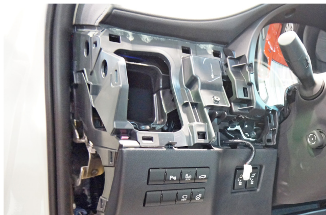
Фото 1.8. Левый воздуховод снят
