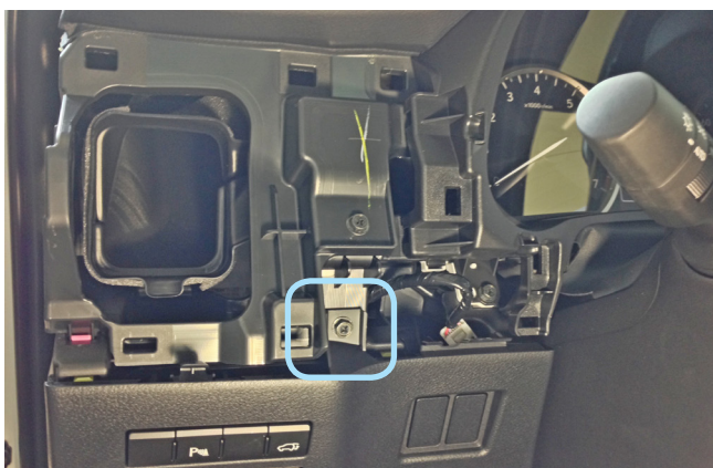
Фото 1.11. Саморез крепления накладки под рулевой колонкой
