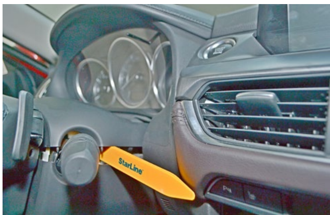
Фото 1.22. Снять верхнюю часть кожану рулевого вала
