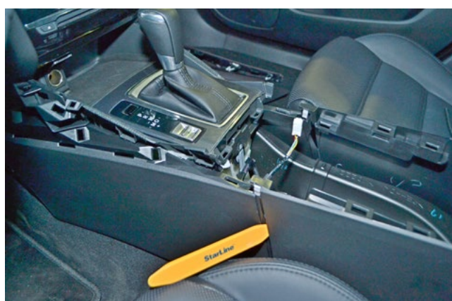
Фото 1.19. Снять заднюю часть центрального тоннеля
