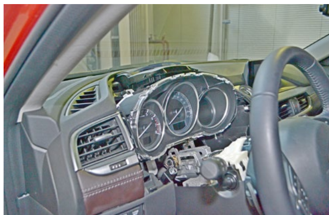
Фото 1.23. Верхняя часть кожану рулевого вала и накладка панели приборов сняты
