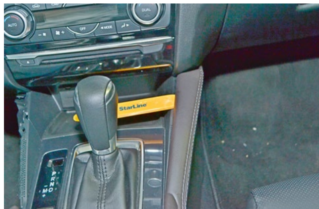
Фото 1.8. Снять накладку справа от рычага коробки передач
