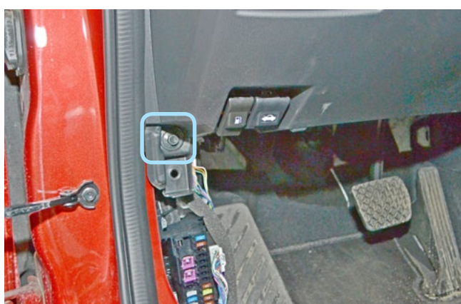
Фото 1.26. Болт крепления накладки под рулевой колонкой
