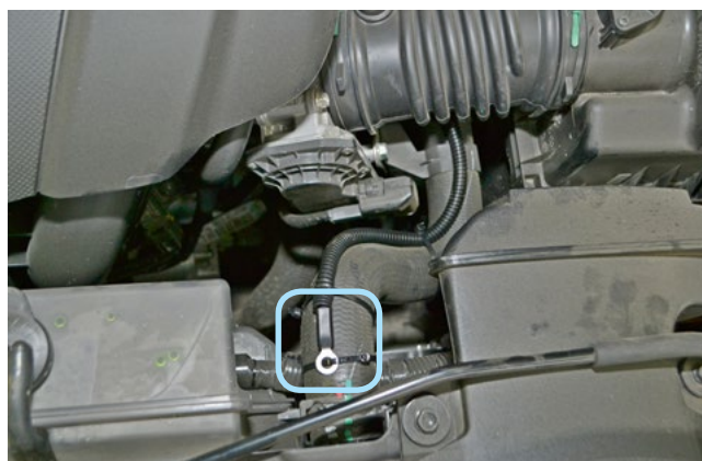
Фото 2.6. Крепление датчика температуры двигателя
