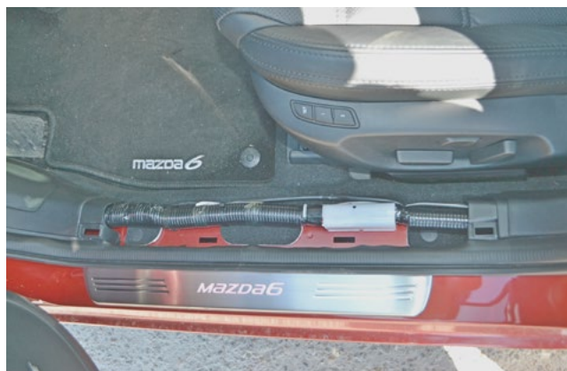
Фото 1.2. Накладка порога двери водителя снята
