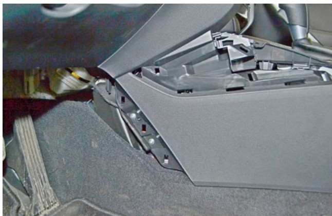
Фото 1.11. Нижняя левая накладка центрального тоннеля снята
