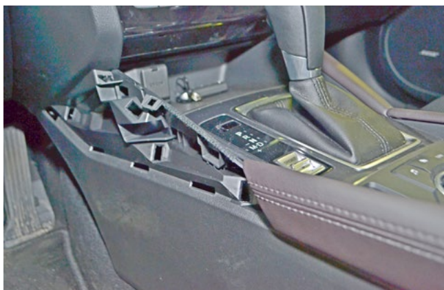
Фото 1.7. Левая накладка снята
