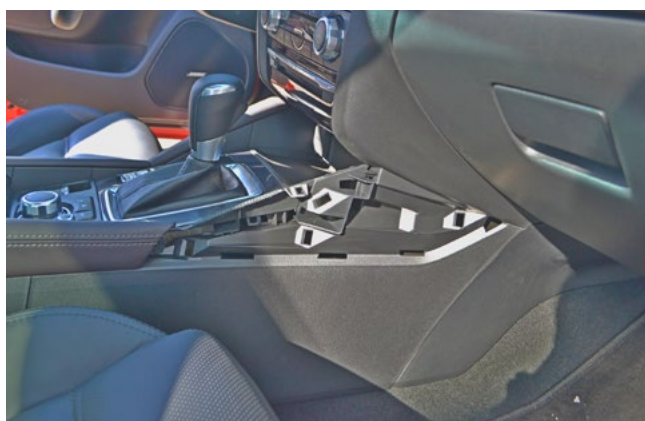
Фото 1.9. Правая накладка снята
