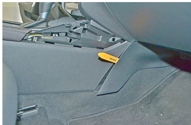
Фото 1.12. Снять нижнюю правую накладку центрального тоннеля
