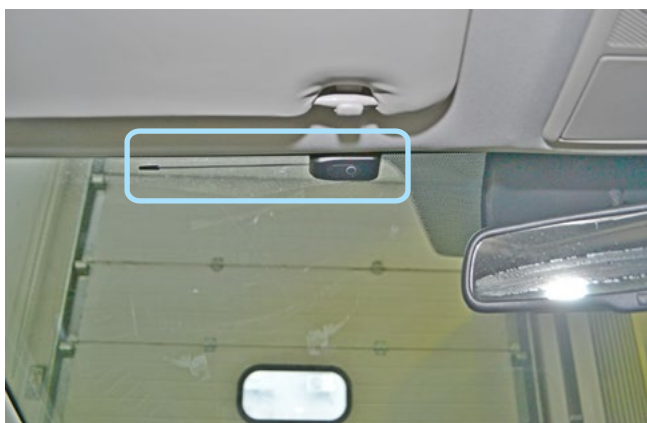
Фото 2.1. Возможное место установки антенного модуля
