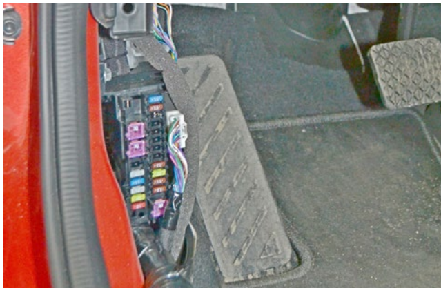
Фото 1.4. Пластиковая накладка левой кик-панели снята
