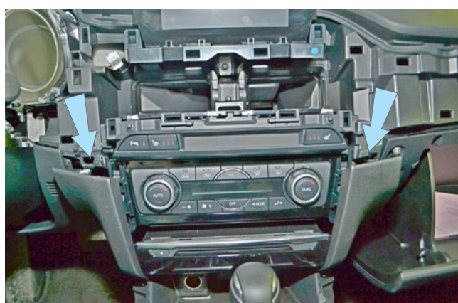
Фото 1.27. Сдвинуть переднюю часть центрального тоннеля
