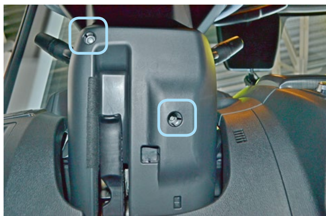
Фото 1.29. Саморезы крепления нижней части кожуха рулевого вала
