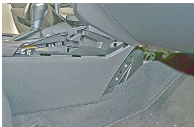
Фото 1.13. Нижняя правая накладка центрального тоннеля снята
