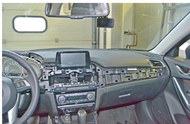
Фото 1.25. Декоративная накладка передней панели снята
