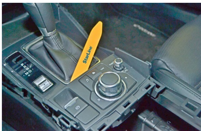
Фото 1.16. Снять блок кнопок
