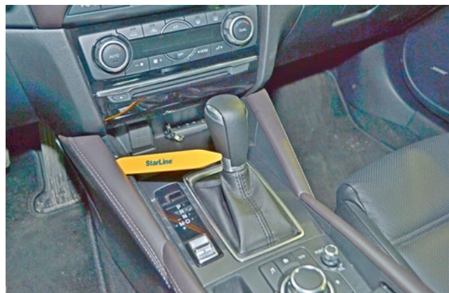
Фото 1.6. Снять накладку слева от рычага коробки передач
