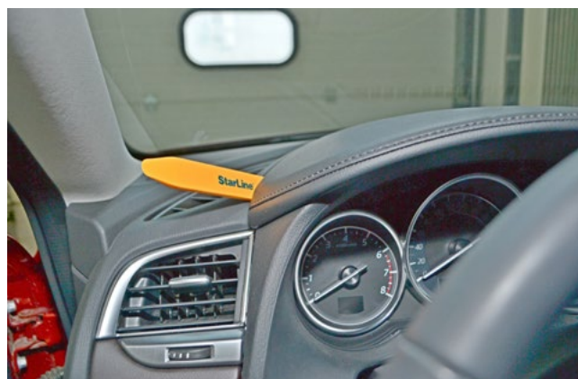
Фото 1.21. Снять декоративную накладку панели приборов
