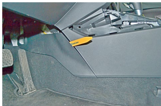
Фото 1.10. Снять нижнюю левую накладку центрального тоннеля
