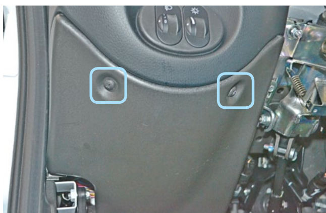
Фото 1.15. Саморезы крепления пластиковой накладки
