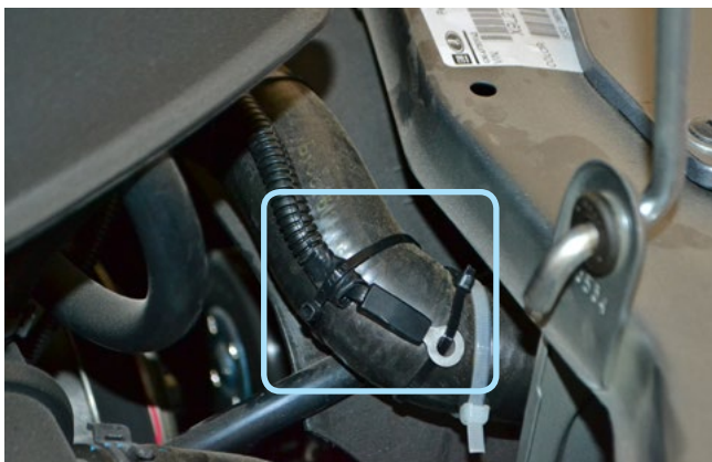
Фото 2.6. Крепление датчика температуры двигателя
