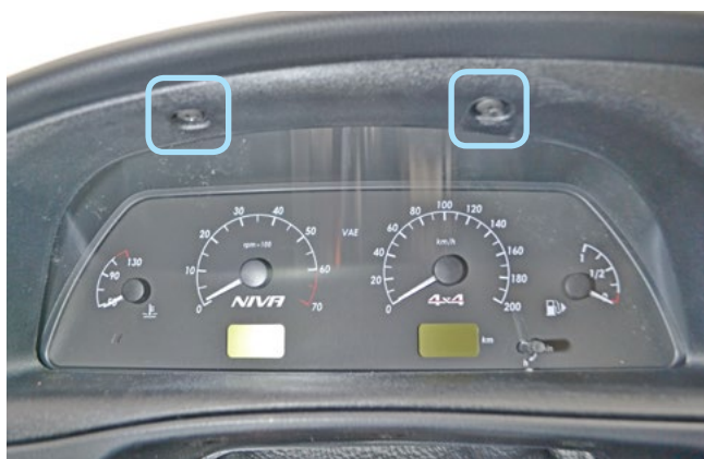
Фото 1.9. Саморезы крепления декоративной накладки панели приборов
