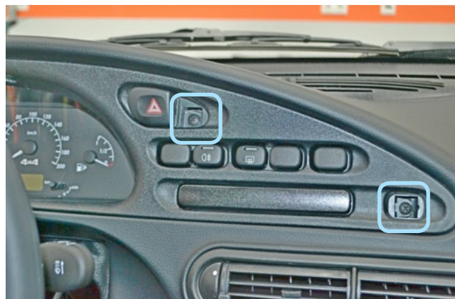
Фото 1.8. Саморезы крепления декоративной накладки панели приборов
