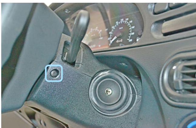
Фото 1.3. Саморез крепления нижней части рулевого кожуха
