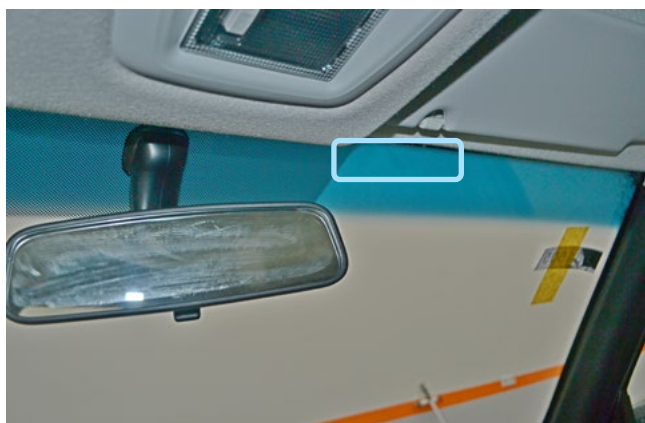
Фото 2.1. Возможное место установки антенного модуля
