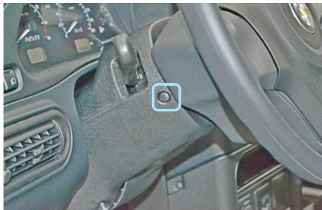
Фото 1.2. Саморез крепления нижней части рулевого кожуха
