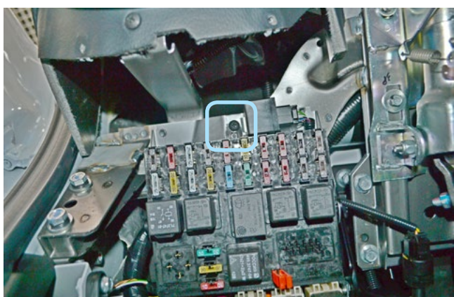
Фото 1.17. Саморез крепления монтажного блока
