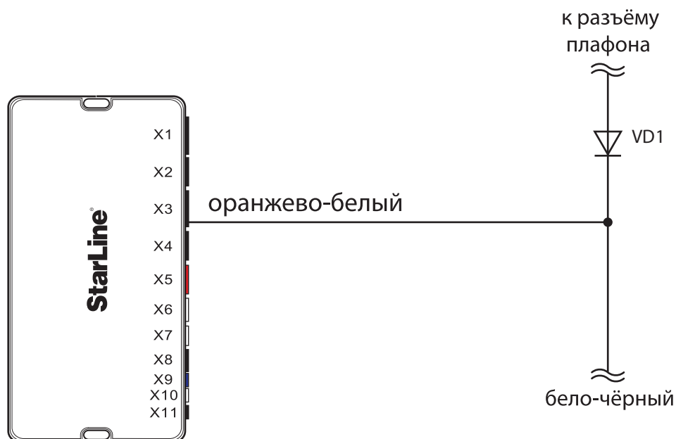
Схема 4. Подключение концевика багажника
