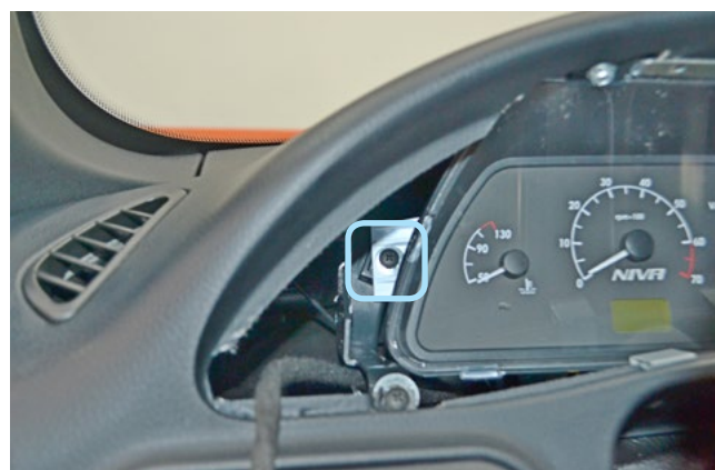
Фото 1.12. Саморез крепления панели приборов слева
