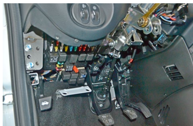
Фото 1.16. Пластиковая накладка снята
