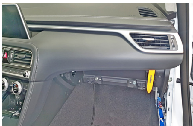
Фото 1.12. Снять продольную накладку передней панели
