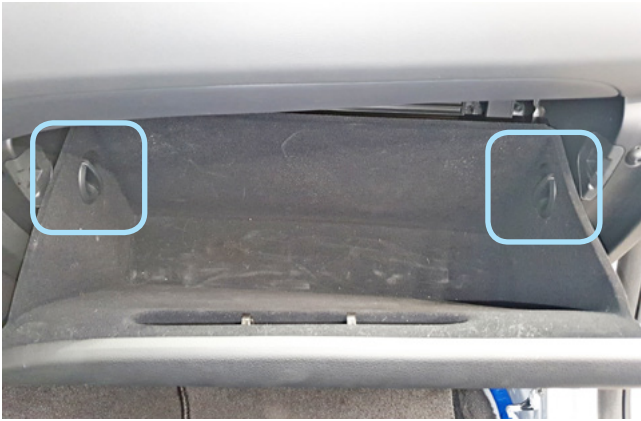
Фото 1.7. Фиксаторы перчаточного ящика сверху
