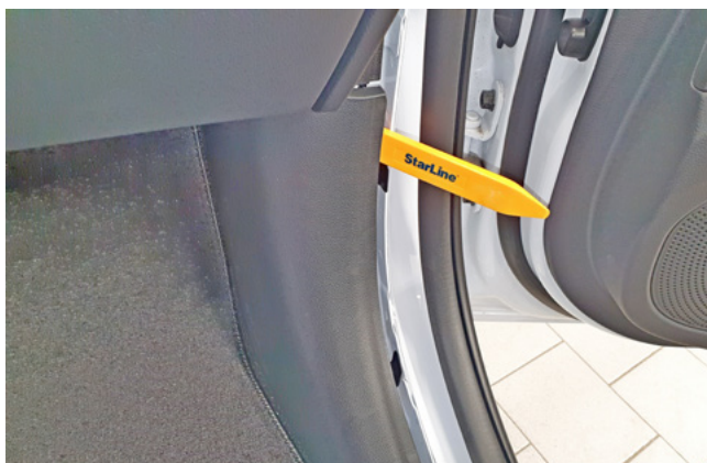
Фото 1.3. Снять накладку правой кик-панели
