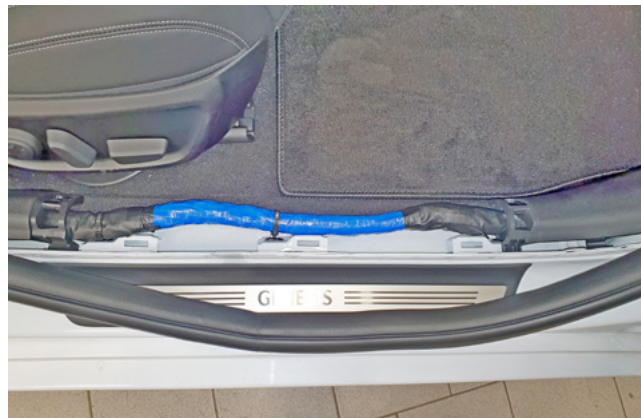
Фото 1.2. Накладка порога двери пассажира снята
