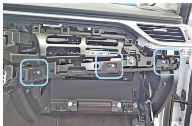
Фото 1.13. Накладка снята. Саморезы
