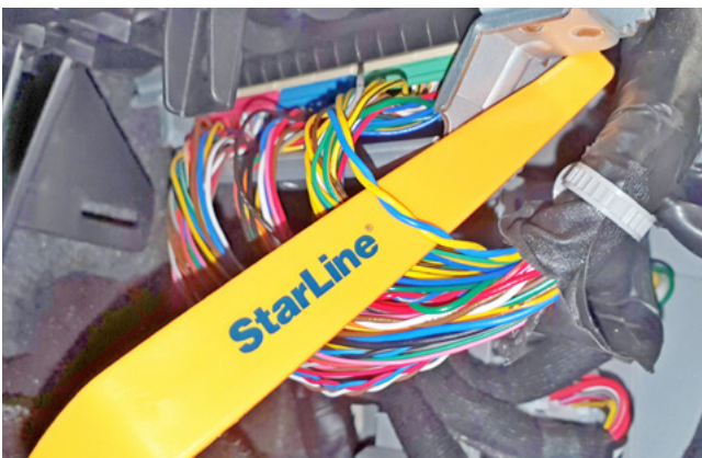
Фото 3.5. Шина CAN-B (жёлтый и синий)
