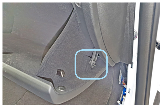
Фото 1.6. Снять ограничитель открытия перчаточного ящика
