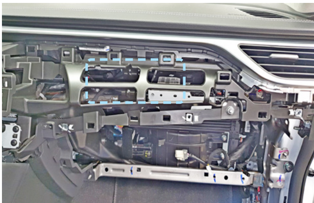
Фото 2.7. Пример расположения центрального блока охранно-телематического комплекса
