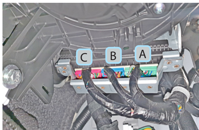
Фото 3.2. Заводское обозначение разъёмов блока IBU
