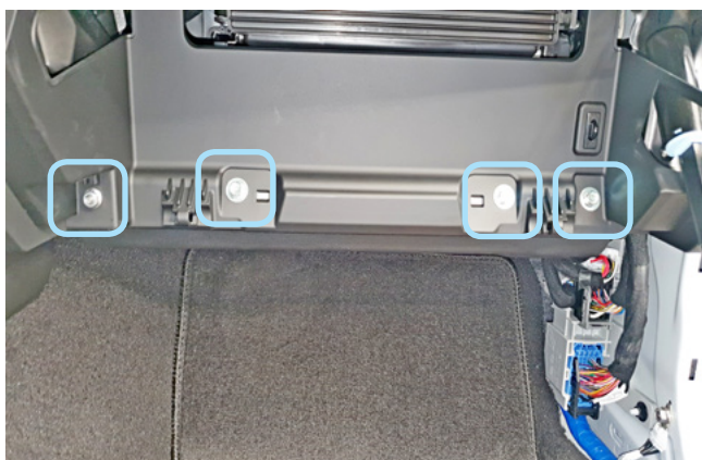
Фото 1.14. Гайка и болты крепления в нижней части накладки
