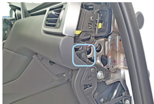
Фото 1.11. Саморез крепления продольной накладки передней панели
