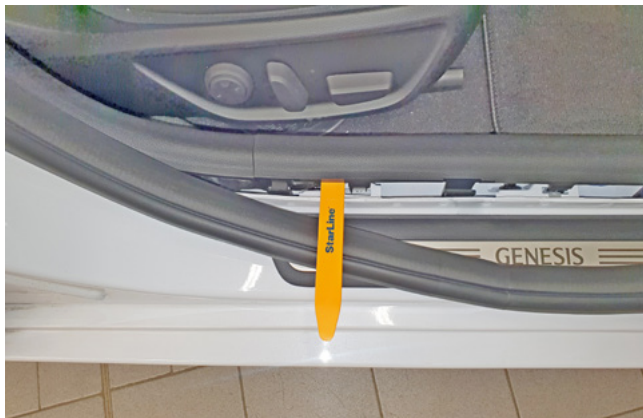
Фото 1.1. Снять накладку порога двери пассажира
