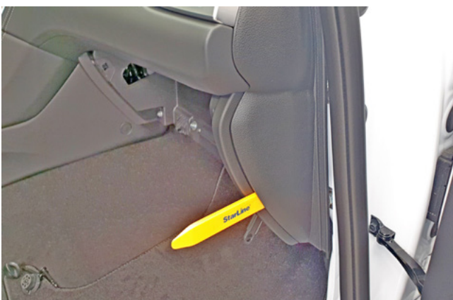
Фото 1.10. Снять правую боковую накладку передней панели
