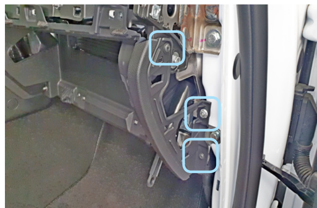
Фото 1.15. Гайка и саморезы крепления накладки справа
