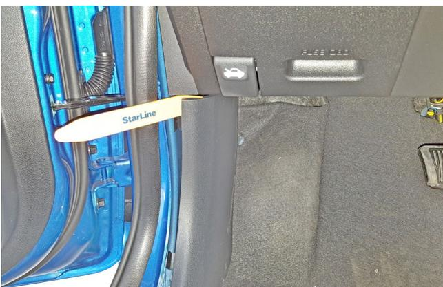
Фото 1.5. Снять накладку левой кик-панели
