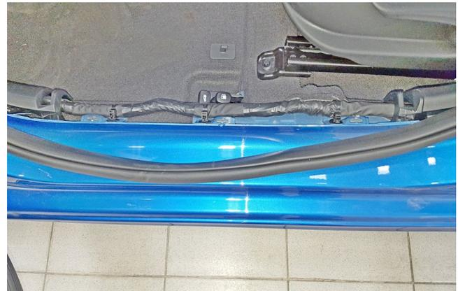
Фото 1.4. Накладка порога двери водителя снята
