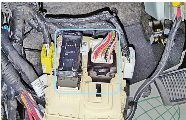
Фото 3.6. Местоположение разъёмов на задней стороне монтажного блока предохранителей
