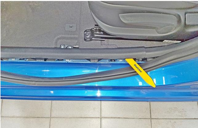
Фото 1.3. Снять накладку порога двери водителя
