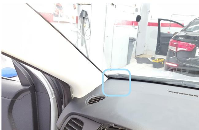
Фото 2.3. Место установки антенны GPS+GLONASS
