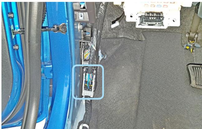
Фото 3.4. Местоположение разъёма
