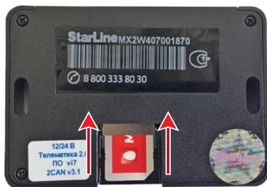
**Внимание!** Извлекать и устанавливать SIM-карту разрешается только при отключенном питании охранно-мониторингового комплекса.
