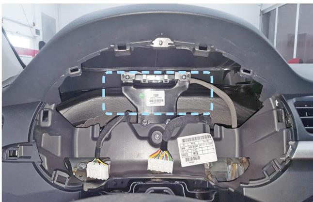
Фото 2.4. Пример расположения центрального блока охранно-мониторингового комплекса
