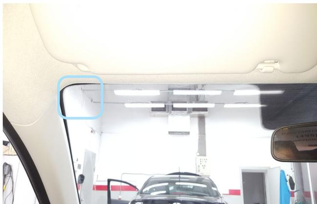
Фото 2.1. Возможное место установки микрофона
