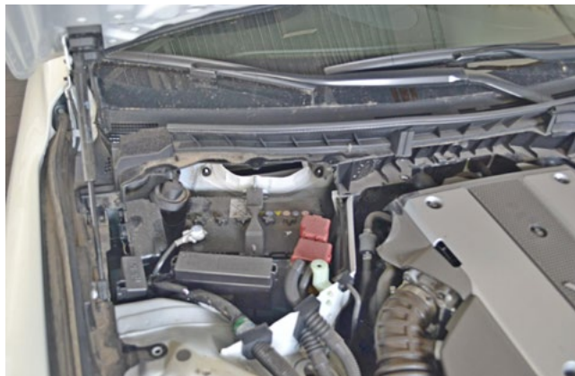
Фото 1.14. Пластиковая накладка снята
