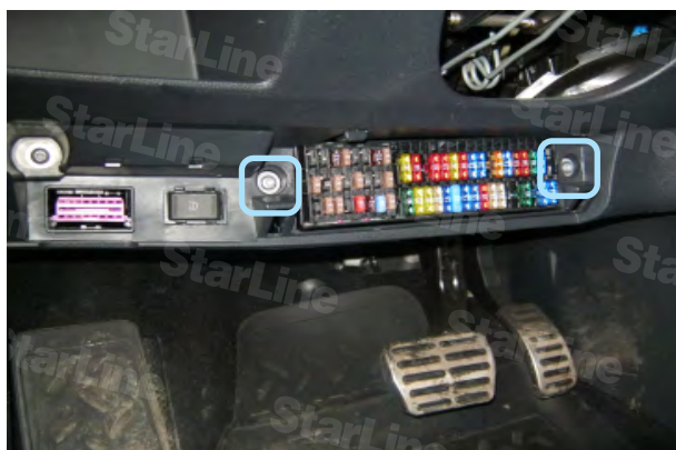
Фото 12.1. Крепление монтажного блока
