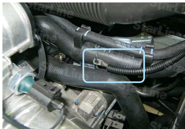
Фото 4.2. Место установки датчика температуры двигателя
