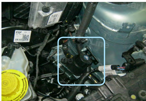
Фото 4.1. Возможное место установки сирены
