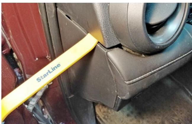
Фото 1.27. Снять верхнюю накладку передней панели
