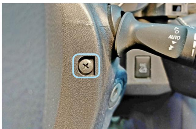
Фото 1.17. Саморез крепления кожуха рулевого вала справа
