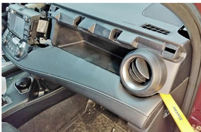
Фото 1.28. Снять верхнюю накладку передней панели
