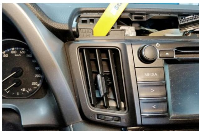
Фото 1.9. Снять воздуховод слева от магнитолы
