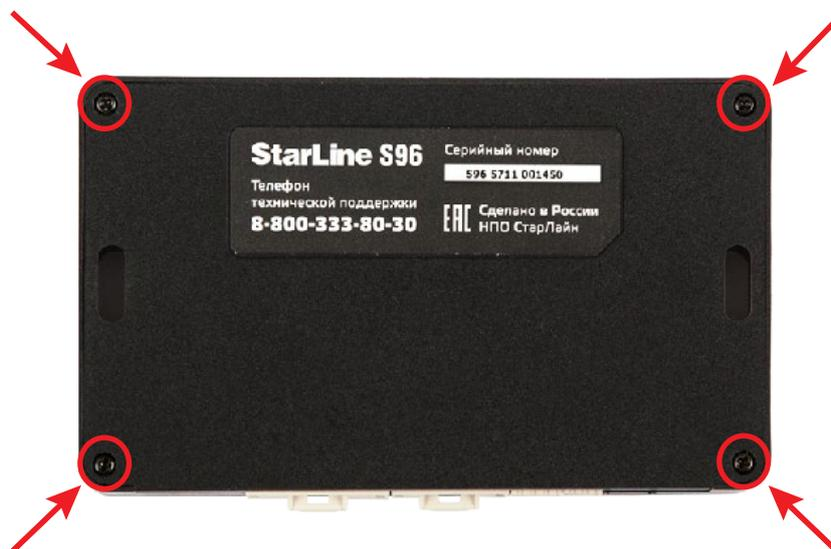
2. Извлечь плату центрального блока. Вынуть установленную и установить другую SIM-карту до упора в направлении, указанном стрелками на рисунке.
