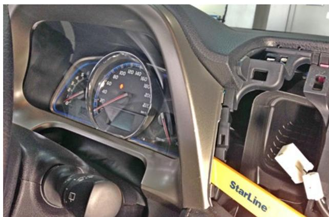
Фото 1.13. Снять декоративную накладку панели приборов
