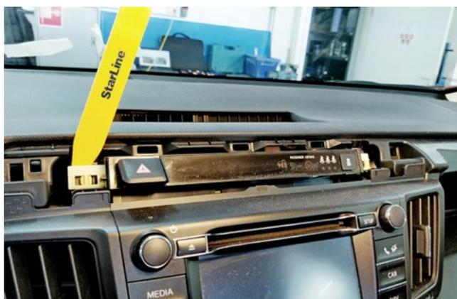
Фото 1.8. Снять панель индикации
