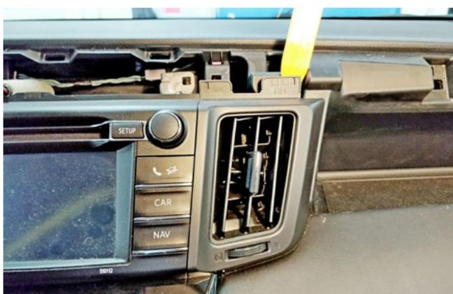
Фото 1.10. Снять воздуховод справа от магнитолы
