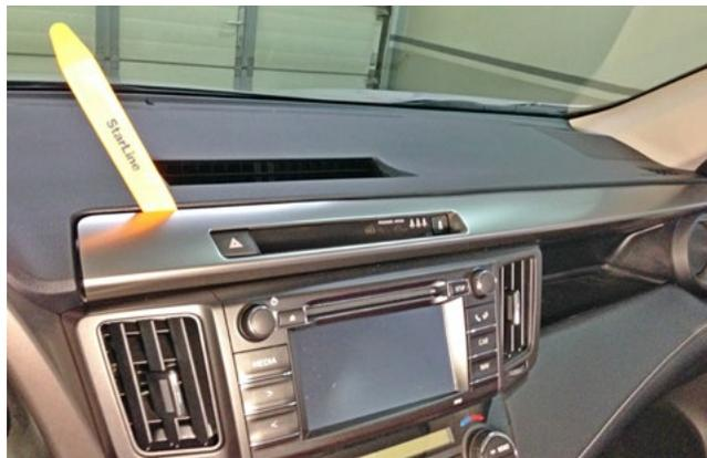
Фото 1.7. Снять декоративную накладку
