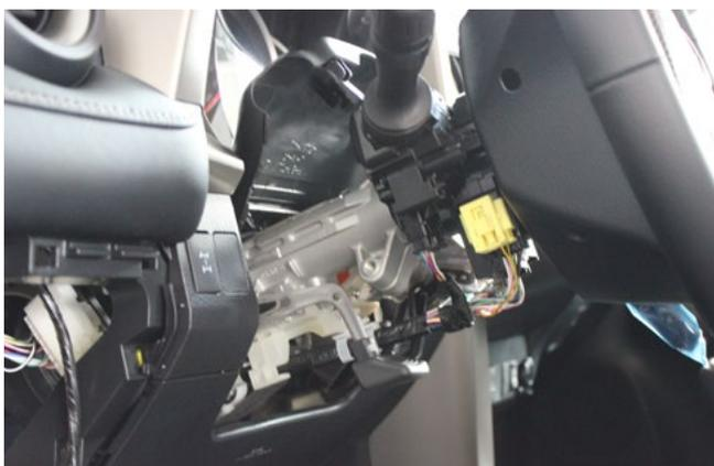
Фото 1.18. Кожух рулевого вала снят
