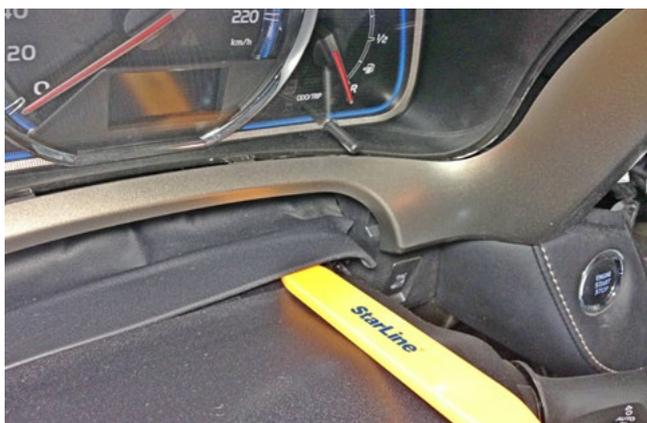
Фото 1.12. Снять пылезащитный чехол
