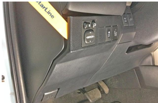
Фото 1.4. Снять декоративную накладку слева от рулевой колонки
