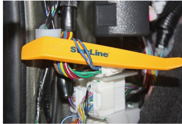
Фото 3.7. Управление центральным замком (синий и сине-чёрный)
