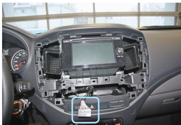
Фото 3.4. Разъём кнопки аварийной сигнализации
