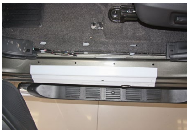
Фото 1.7. Накладка порога снята
