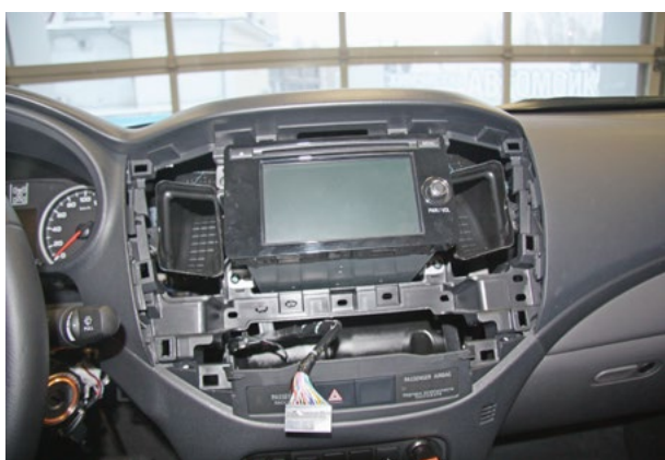
Фото 1.16. Блок управления климат-контроля снят
