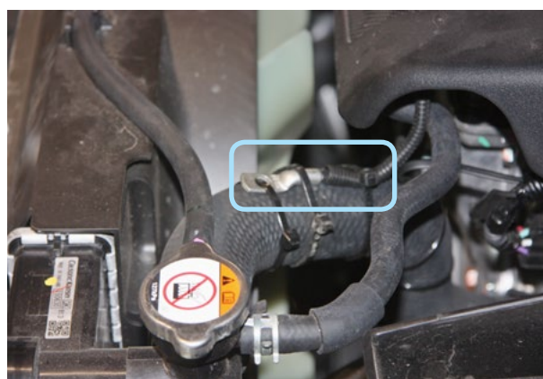
Фото 2.4. Крепление датчика температуры двигателя
