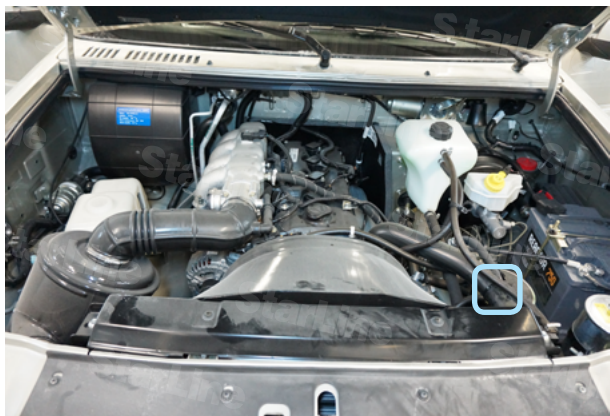
Фото 5.3. Место установки датчика температуры двигателя
