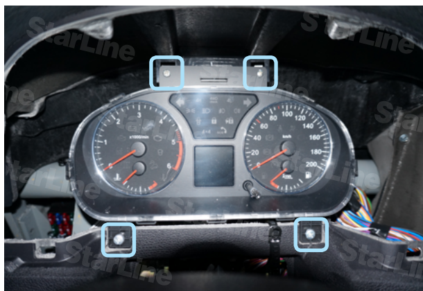
Фото 3.3. Саморезы крепления панели приборов
