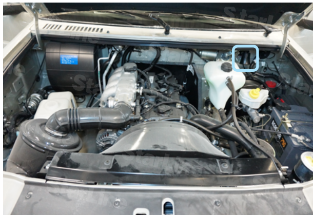
Фото 5.1. Возможное место установки сирены
