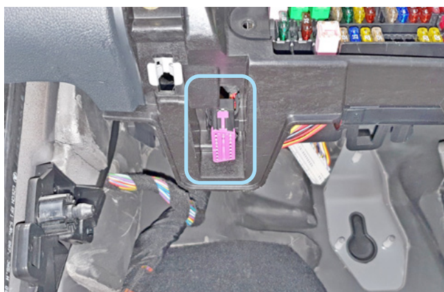
Фото 3.4. Местоположение диагностического разъёма
