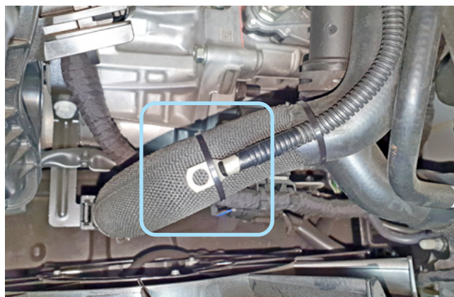
Фото 2.5. Крепление датчика температуры двигателя
