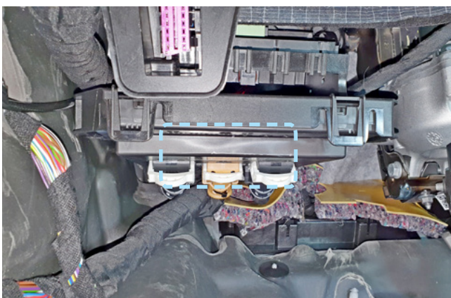
Фото 2.8. Пример расположения центрального блока охранно-телематического комплекса
