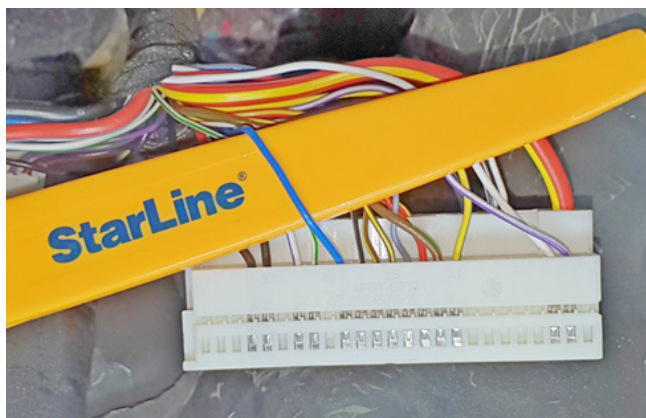
Фото 3.7. Управление центральным замком (синий)
