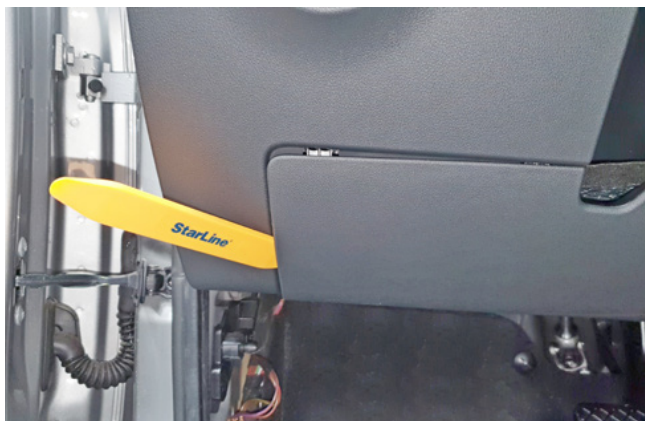
Фото 1.7. Снять крышку монтажного блока предохранителей
