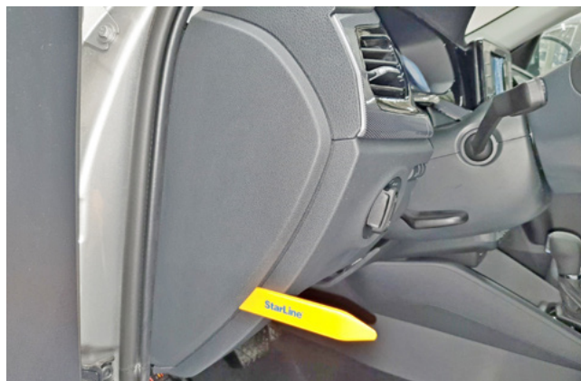
Фото 1.2. Снять левую боковую накладку передней панели
