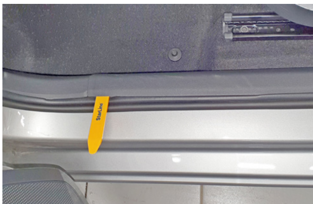
Фото 1.3. Снять накладку порога двери водителя
