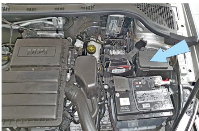
Фото 2.7. Возможное место установки подкапотного блока R6
