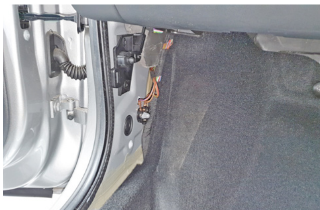
Фото 1.6. Накладка левой кик-панели снята
