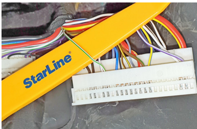
Фото 3.6. Управление световыми сигналами (бело-зелёный)
