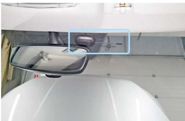
Фото 2.1. Возможное место установки антенного модуля
