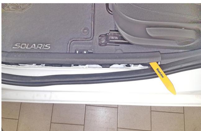
Фото 1.3. Снять накладку порога двери водителя
