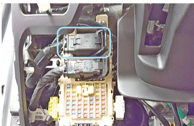
Фото 3.11. Местоположение разъёма на передней стороне монтажного блока предохранителей
