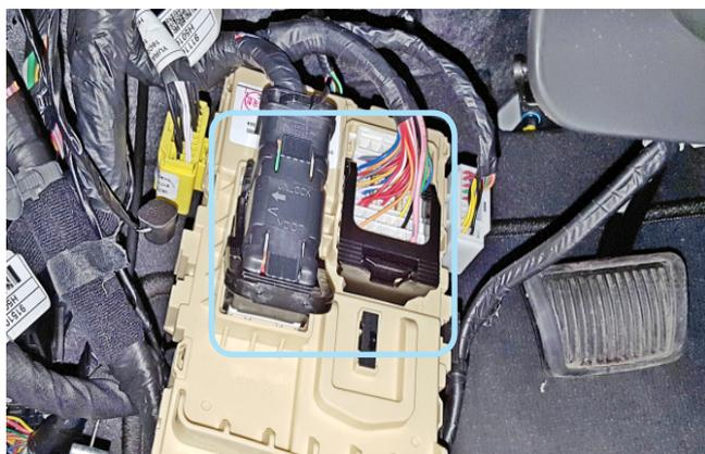
Фото 3.7. Местоположение разъёмов на задней стороне монтажного блока предохранителей
