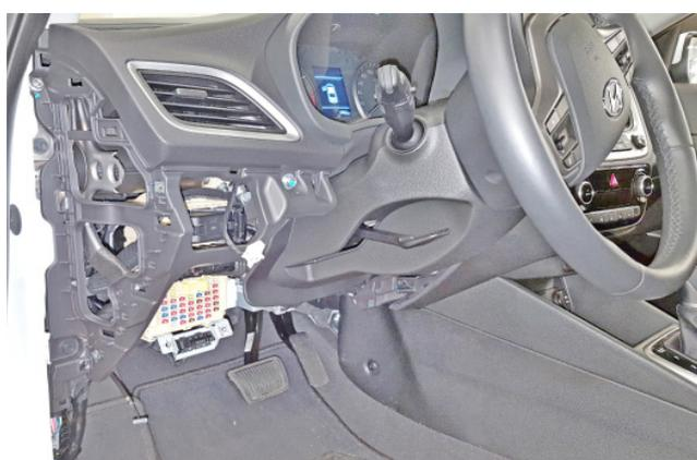
Фото 1.10. Пластиковая накладка под рулевой колонкой снята
