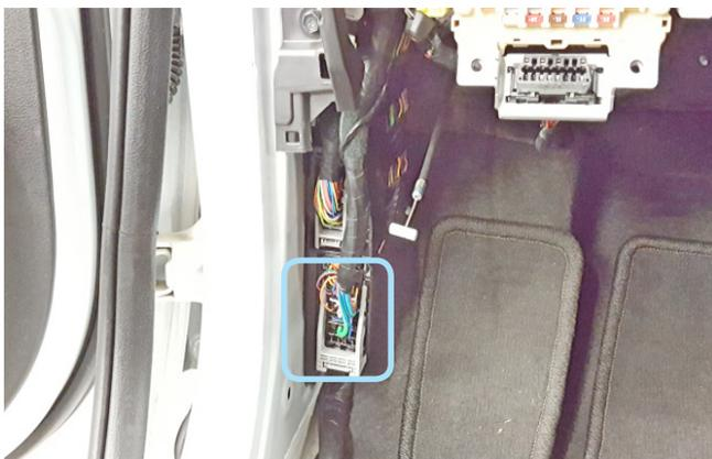
Фото 3.5. Местоположение разъёма
