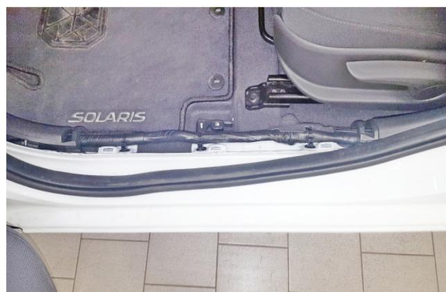
Фото 1.4. Накладка порога двери водителя снята
