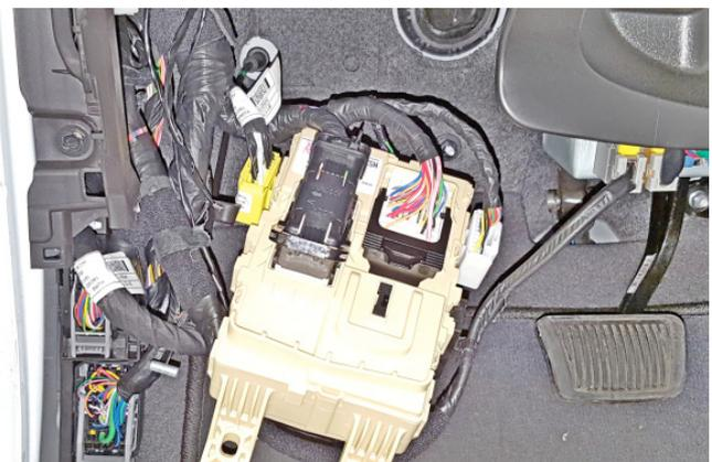
Фото 1.17. Монтажный блок предохранителей снят
