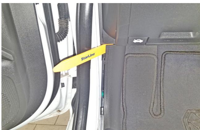
Фото 1.5. Снять накладку левой кик-панели
