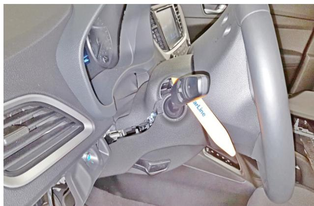
Фото 1.12. Снять верхнюю часть кожуха рулевого вала
