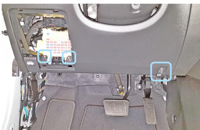
Фото 1.9. Болты и саморез крепления пластиковой накладки под рулевой колонкой
