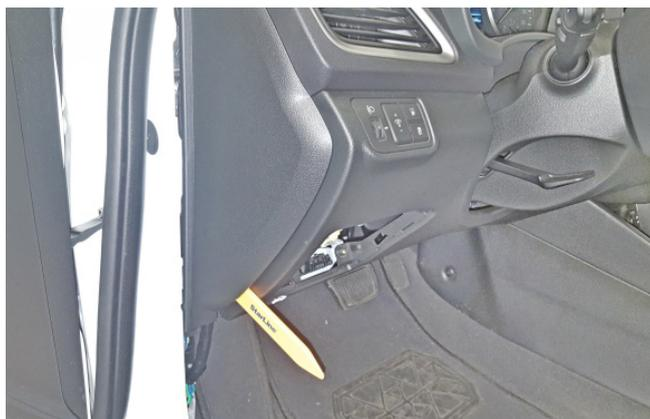
Фото 1.7. Снять левую боковую накладку передней панели
