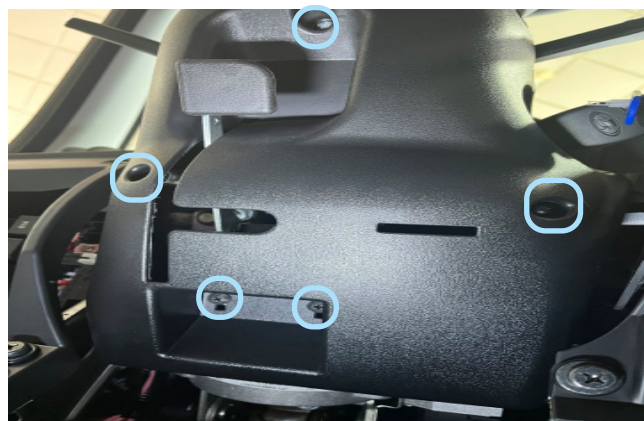
Фото 1.6. Саморезы крепления кожуха рулевого вала. Снизу
