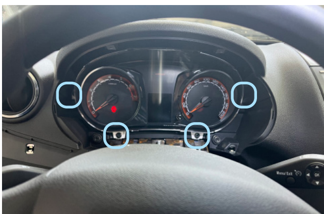
Фото 1.11 Декоративная накладка снята. Саморезы крепления панели приборов
