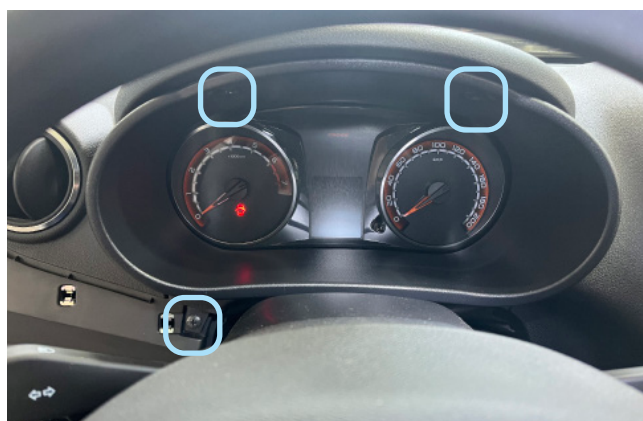
Фото 1.9. Саморезы крепления декоративной накладки
