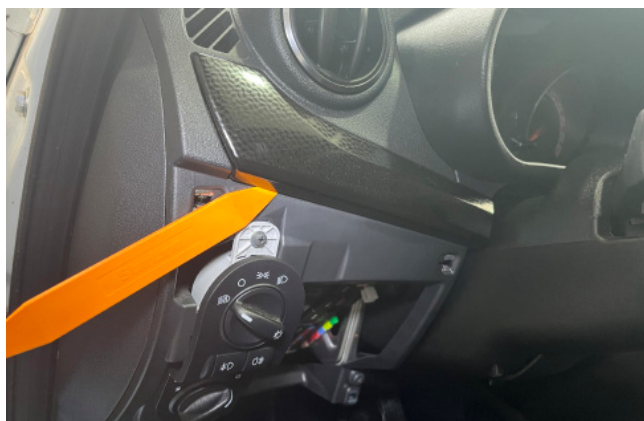
Фото 1.3. Снять декоративную накладку
