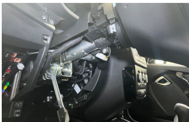
Фото 1.7. Кожух рулевого вала снят
