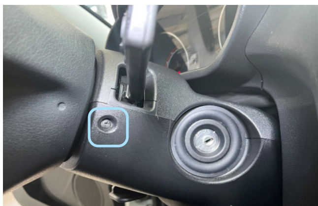
Фото 1.5. Саморез крепления кожуха рулевого вала. Справа
