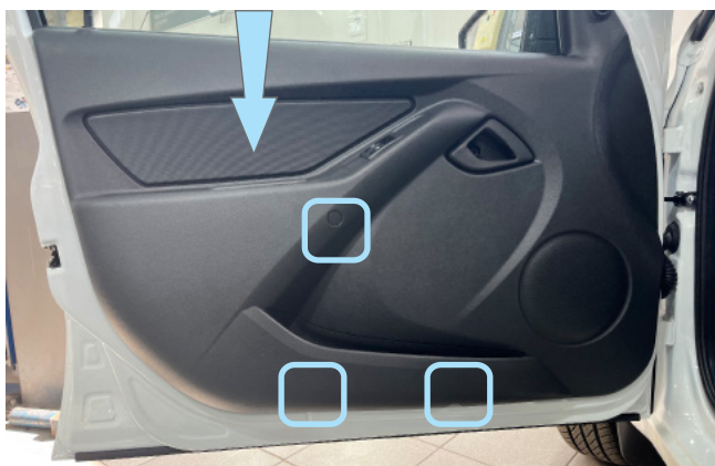
Фото 3.10. Саморезы крепления обшивки двери водителя
