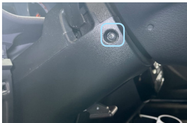
Фото 1.4. Саморез крепления кожуха рулевого вала. Слева
