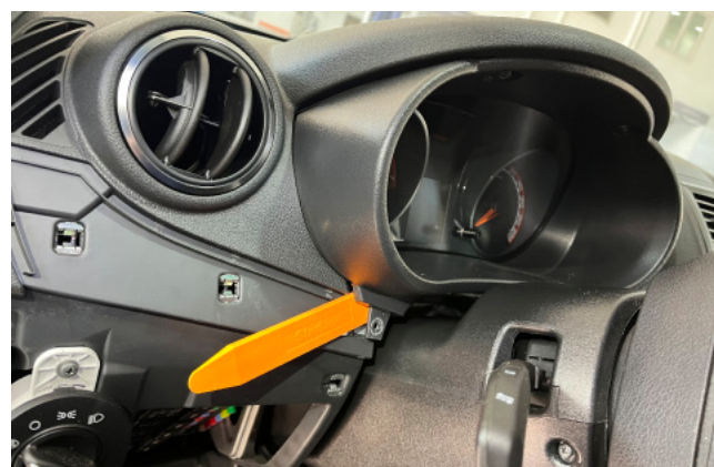
Фото 1.10. Снять декоративную накладку приборной панели
