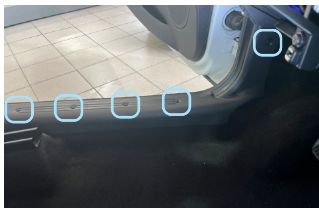
Фото 1.8. Саморезы крепления накладки порога водителя
