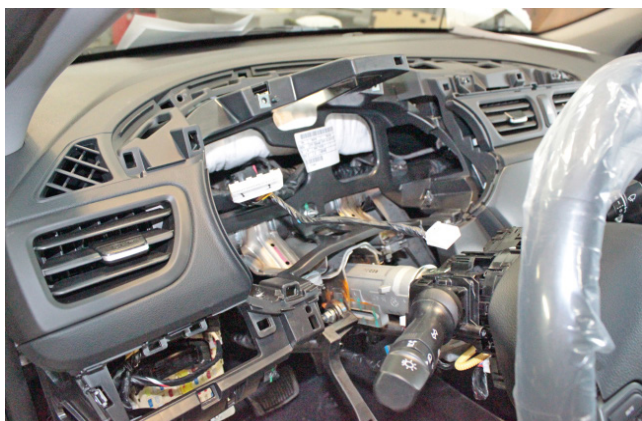
Фото 1.25. Панель приборов снята
