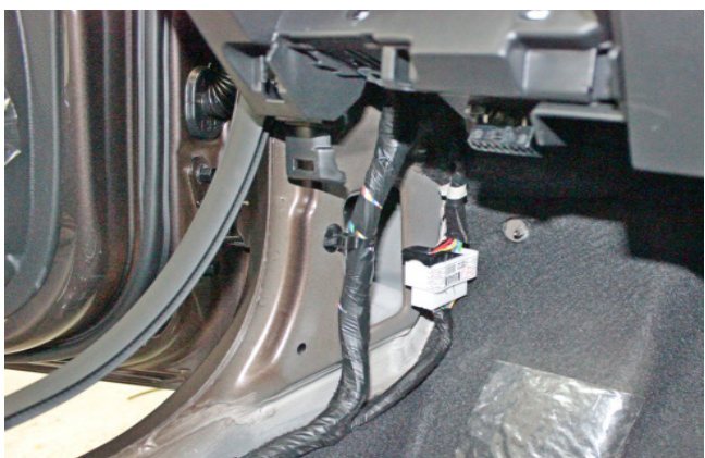
Фото 1.14. Накладка левой кик-панели снята
