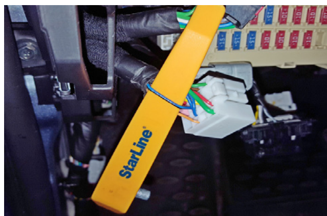
Фото 3.10. Шина данных штатного иммобилайзера (сине-чёрный)
