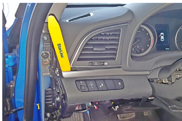
Фото 1.14. Снять декоративную накладку
