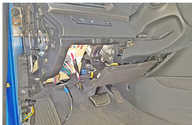
Фото 1.10. Пластиковая накладка под рулевой колонкой снята
