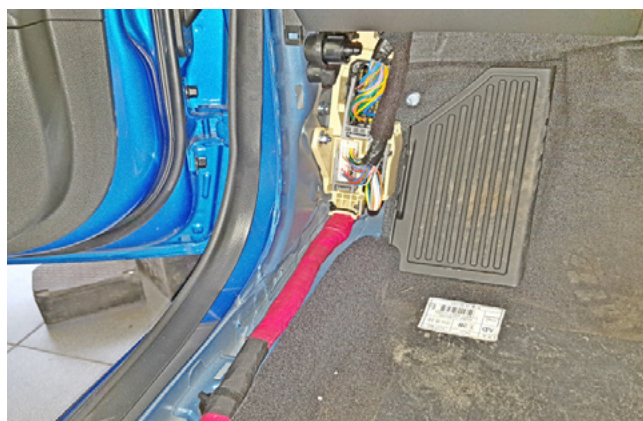
Фото 1.6. Накладка левой кик-панели снята
