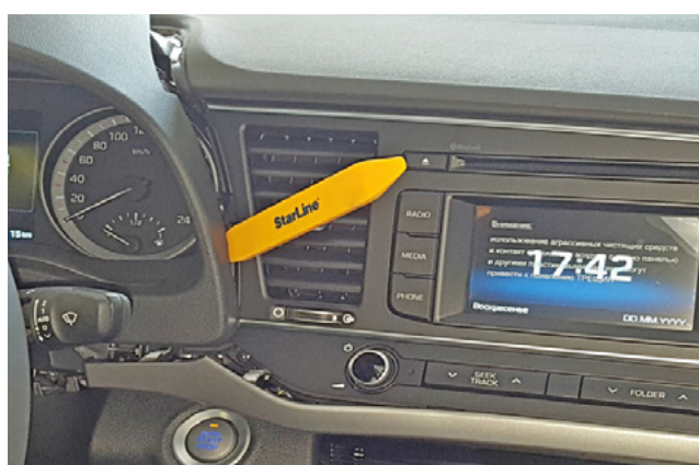
Фото 1.18. Снять накладку панели приборов
