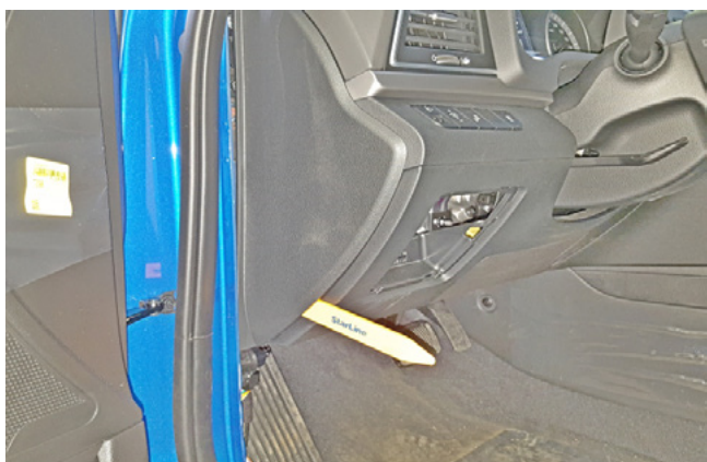
Фото 1.7. Снять боковую накладку передней панели
