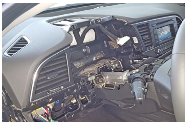
Фото 1.22. Панель приборов снята
