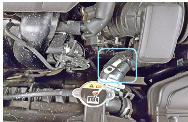
Фото 2.4. Крепление датчика температуры двигателя
