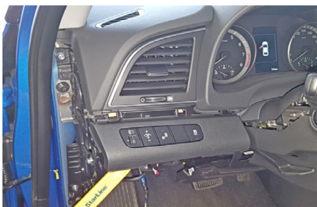
Фото 1.15. Накладка снята. Снять блок кнопок управления
