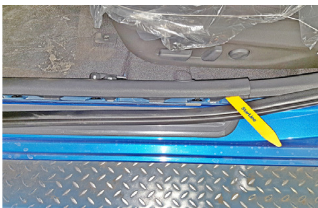
Фото 1.3. Снять накладку порога двери водителя
