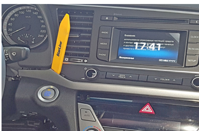
Фото 1.17. Снять продольную декоративную накладку передней панели
