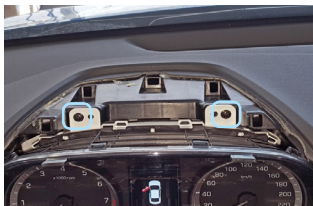
Фото 1.20. Саморезы крепления панели приборов
