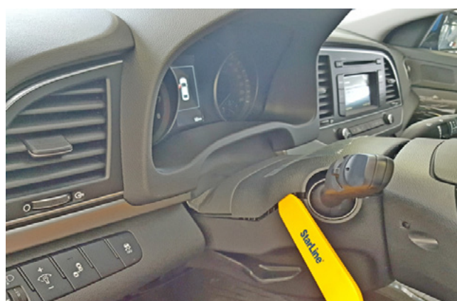
Фото 1.12. Снять верхнюю часть кожуха рулевого вала
