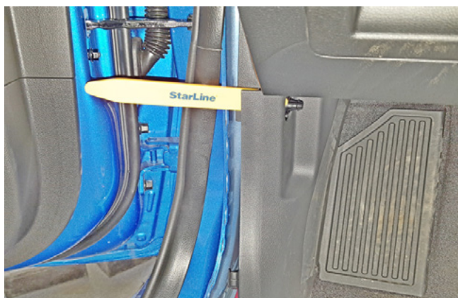
Фото 1.5. Снять накладку левой кик-панели
