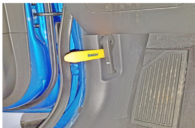
Фото 1.4. Снять ручку отпирания капота
