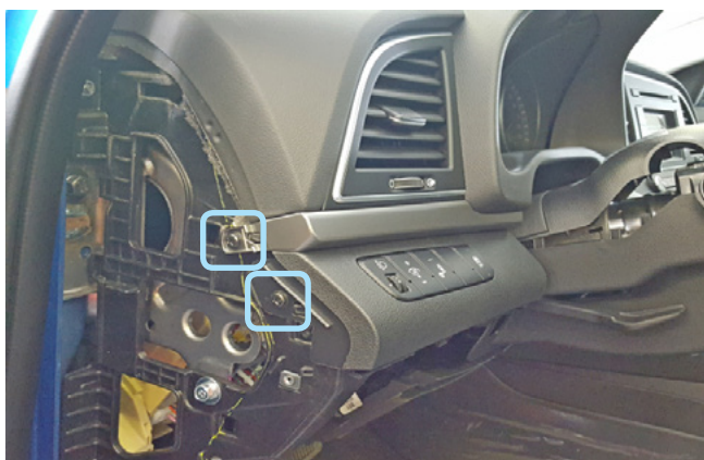
Фото 1.13. Саморезы крепления декоративной накладки и блока кнопок управления
