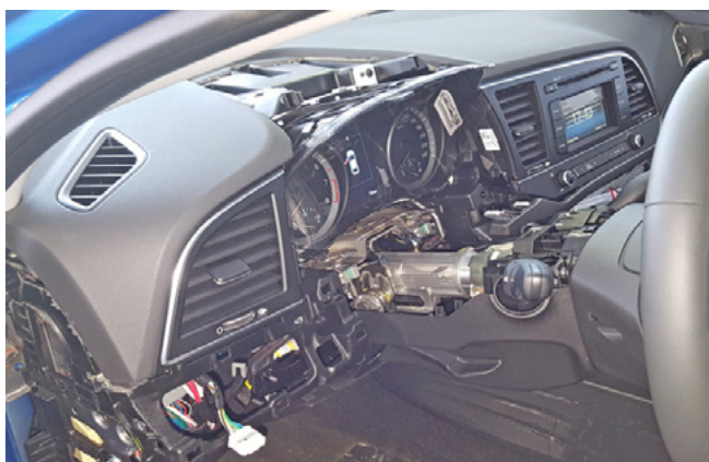
Фото 1.19. Накладка панели приборов снята
