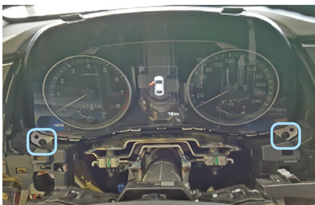
Фото 1.21. Саморезы крепления панели приборов
