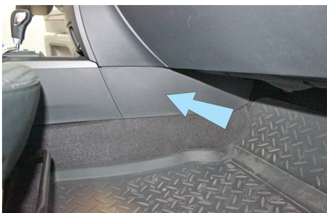
Фото 3.6. Правая нижняя накладка центрального тоннеля
