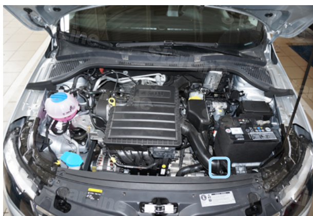
Фото 5.3. Место установки датчика температуры двигателя
