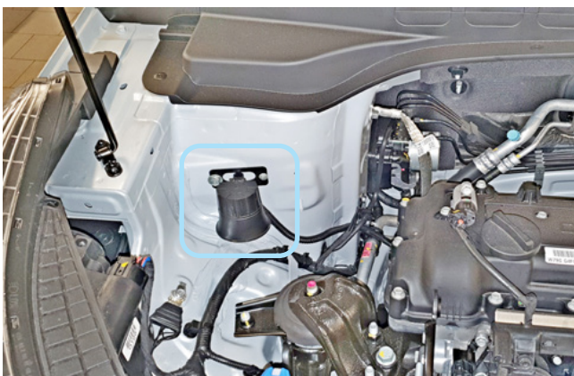
Фото 2.2. Возможное место установки сирены
