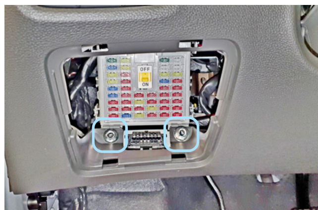
Фото 1.10. Болты крепления накладки под рулевой колонкой
