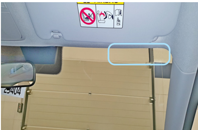
Фото 2.1. Возможное место установки антенного модуля
