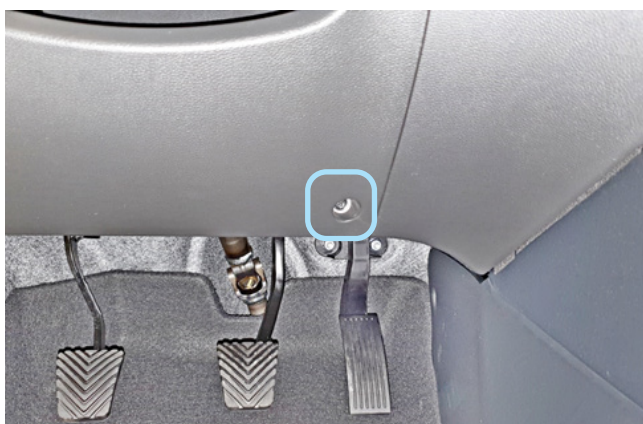
Фото 1.9. Саморез крепления накладки под рулевой колонкой
