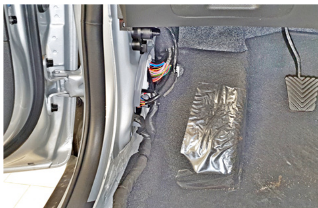
Фото 1.6. Накладка левой кик-панели снята
