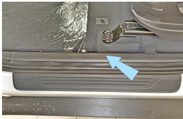
Фото 1.2. Накладка порога двери водителя
