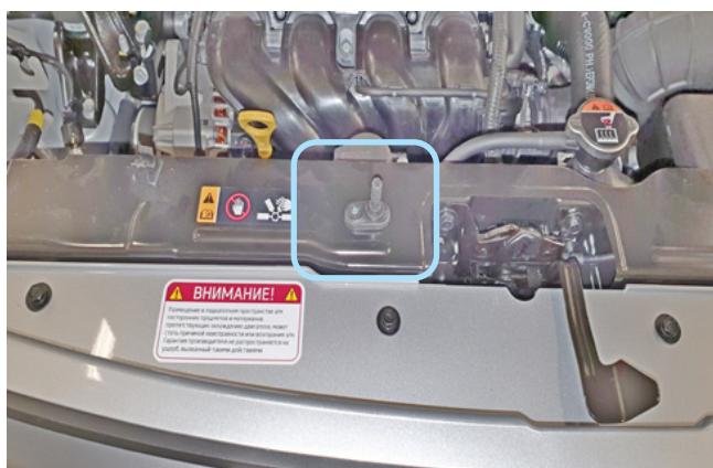
Фото 2.6. Возможное место установки концевика капота
