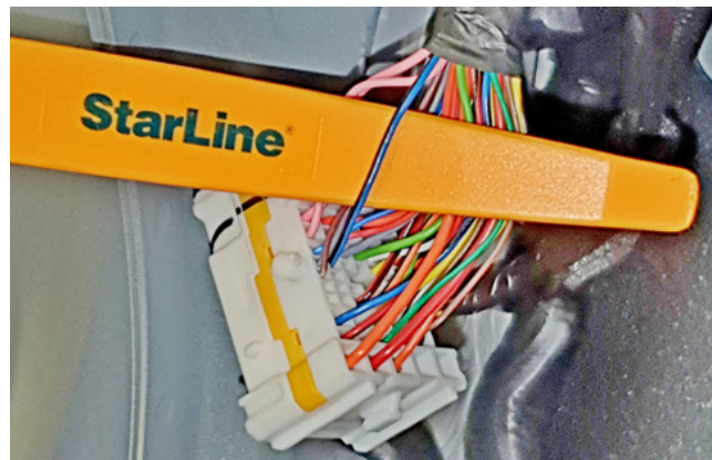
Фото 3.6. Шина данных штатного иммобилайзера (сине-чёрный)
