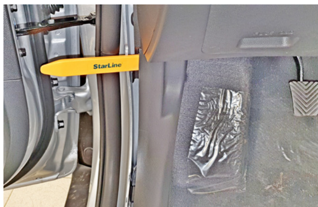
Фото 1.5. Снять накладку левой кик-панели
