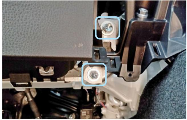
Фото 1.25. Болты крепления подушки безопасности справа
