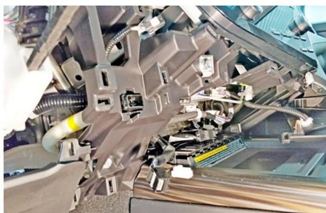
Фото 1.23. Накладка под мультимедийной системой снята
