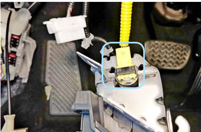
Фото 1.26. Разъём подушки безопасности
