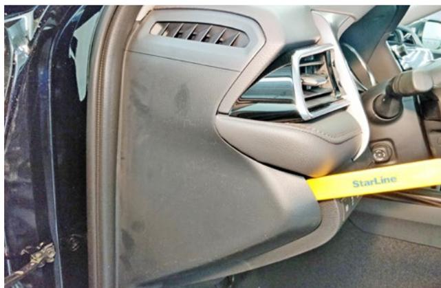
Фото 1.4. Снять левую боковую накладку передней панели
