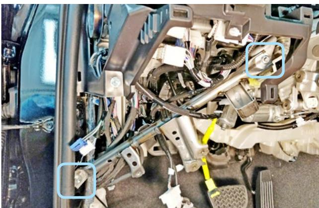
Фото 1.27. Болт и гайка крепления кронштейна
