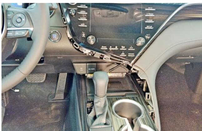
Фото 1.14. Декоративная накладка передней панели снята
