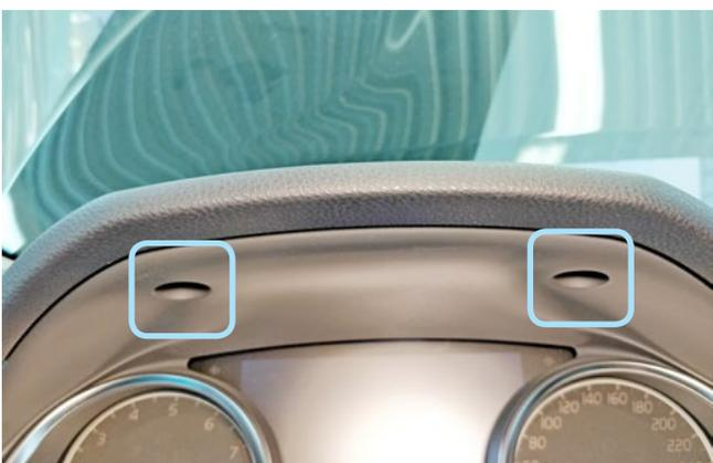
Фото 1.16. Клипсы крепления накладки панели приборов
