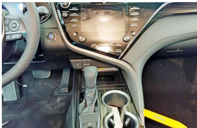
Фото 1.13. Снять декоративную накладку передней панели
