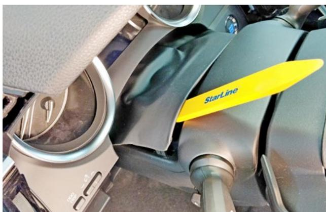
Фото 1.15. Отсоединить пылезащитный чехол от кожуха рулевого вала
