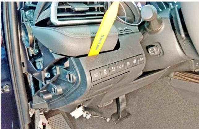
Фото 1.9. Снять накладку под рулевой колонкой
