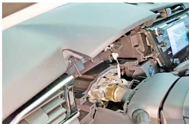
Фото 1.19. Панель приборов снята
