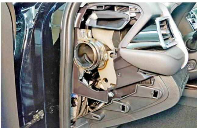
Фото 1.5. Левая боковая накладка передней панели снята
