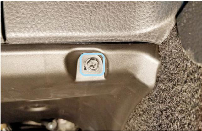
Фото 1.7. Саморез крепления накладки педального узла справа
