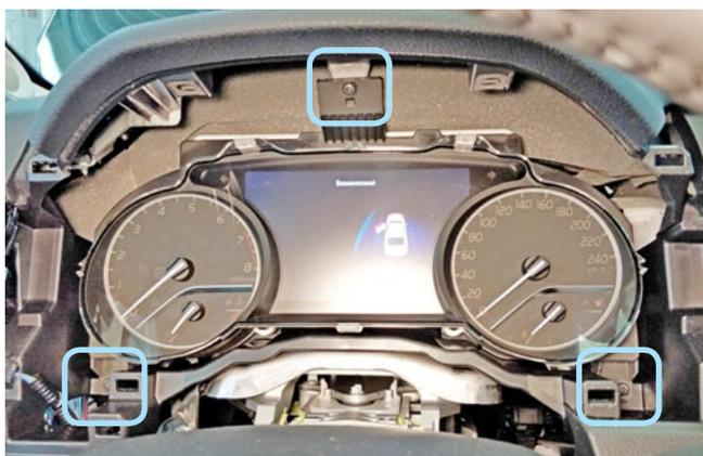
Фото 1.18. Накладка панели приборов снята.
