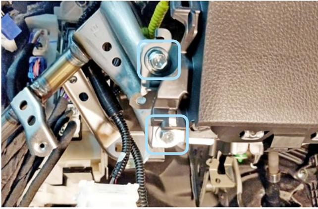
Фото 1.24. Болты крепления подушки безопасности слева
