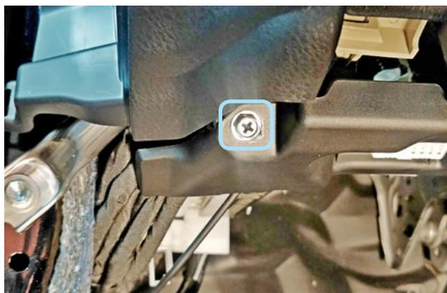
Фото 1.6. Саморез крепления накладки педального узла слева
