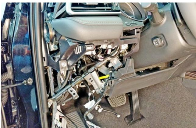
Фото 1.11. Накладка под рулевой колонкой снята
