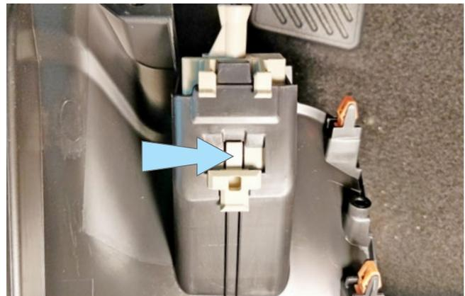
Фото 1.10. Фиксатор крепления ручки отпирания капота
