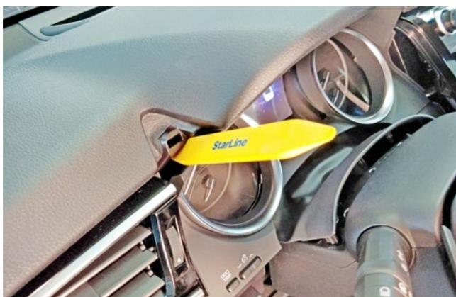
Фото 1.17. Снять накладку панели приборов
