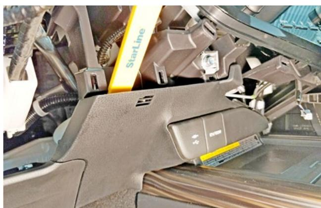
Фото 1.22. Снять накладку под мультимедийной системой
