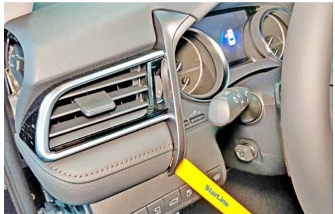
Фото 1.8. Снять декоративную накладку слева от панели приборов
