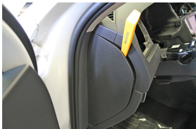
Фото 1.9. Снять левую боковую накладку передней панели
