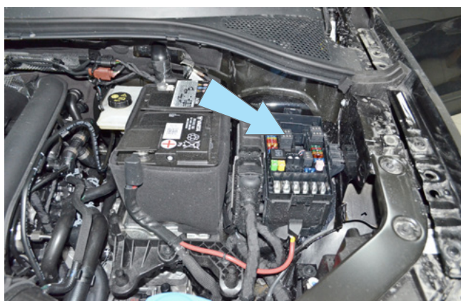
Фото 2.6. Возможное место установки подкапотного блока R6
