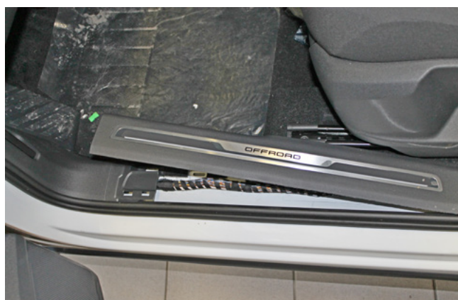
Фото 1.14. Пластиковая накладка порога двери водителя снята
