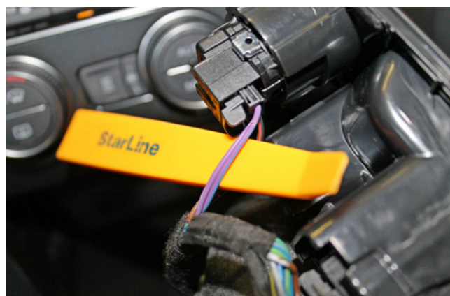
Фото 3.9. Управление кнопкой Старт-Стоп (фиолетовый и фиолетово-синий)
