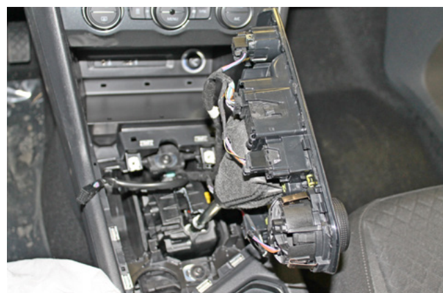
Фото 1.27. Блок кнопок снят
