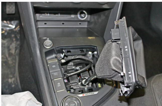
Фото 1.24. Пластиковая панель с индикаторами снята
