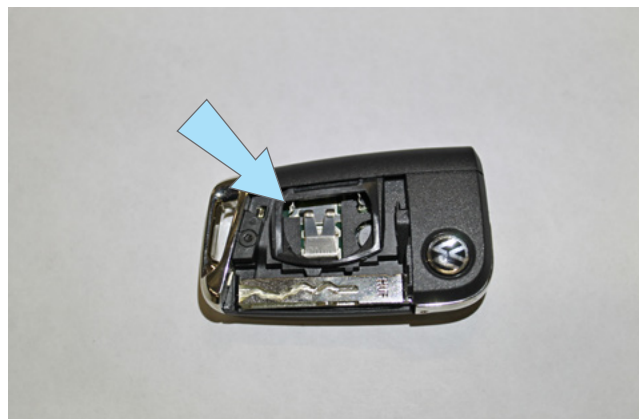
Фото 3.15. Контактная площадка (+) на плате ключа
