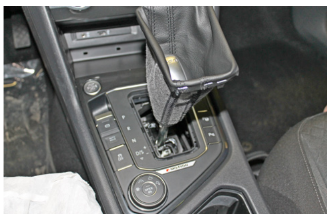
Фото 1.22. Пылезащитный кожух ручки селектора АКПП снят
