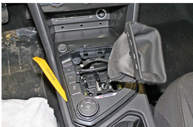
Фото 1.26. Снять блок кнопок
