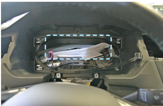
Фото 2.7. Пример расположения центрального блока охранно-телематического комплекса
