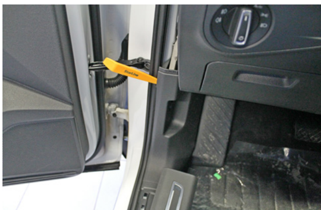
Фото 1.18. Снять пластиковую накладку левой кик-панели
