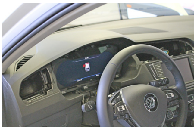
Фото 1.5. Накладка панели приборов снята
