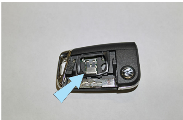
Фото 3.14. Контактная площадка (-) на плате ключа
