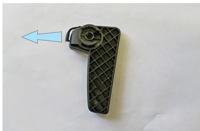
Фото 1.15. Сдвинуть фиксатор ручки отпирания капота
