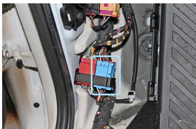
Фото 3.10. Местоположение синего разъёма в левой кик-панели
