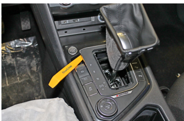
Фото 1.23. Снять пластиковую панель с индикаторами
