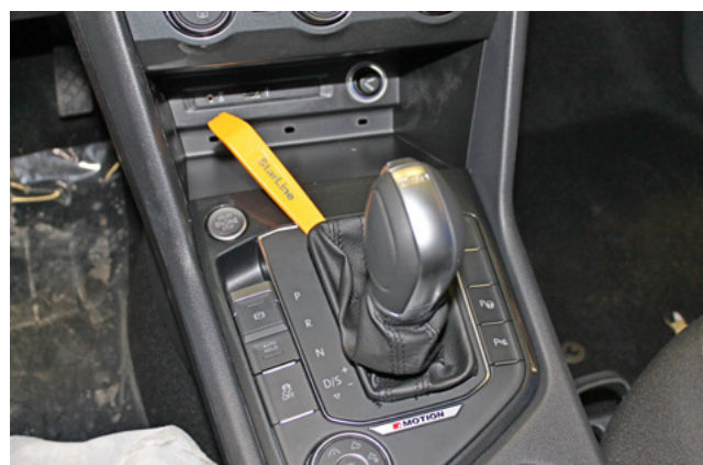
Фото 1.21. Снять пылезащитный кожух ручки селектора АКПП
