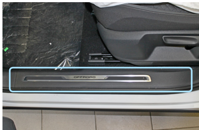
Фото 1.13. Пластиковая накладка порога двери водителя
