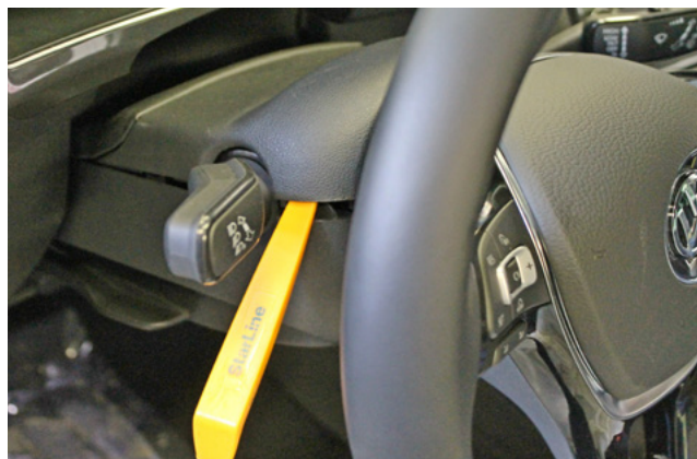
Фото 1.2. Снять верхнюю часть кожуха рулевого вала
