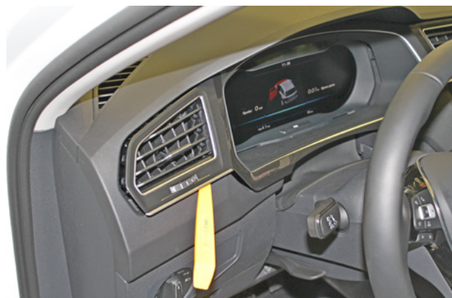
Фото 1.4. Снять накладку панели приборов
