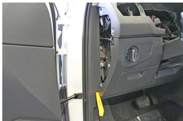
Фото 1.11. Снять накладку слева от передней панели
