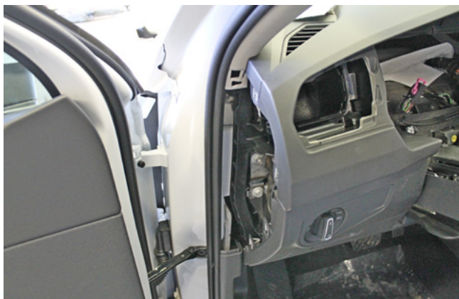
Фото 1.12. Накладка слева от передней панели снята
