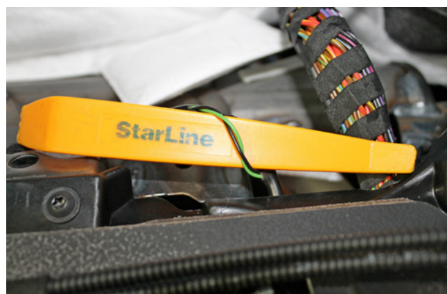
Фото 3.13. Провода антенны штатного иммобилайзера (зелёный и чёрный)
