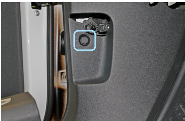
Фото 1.16. Ручка отпирания капота снята. Клипса крепления накладки кик-панели
