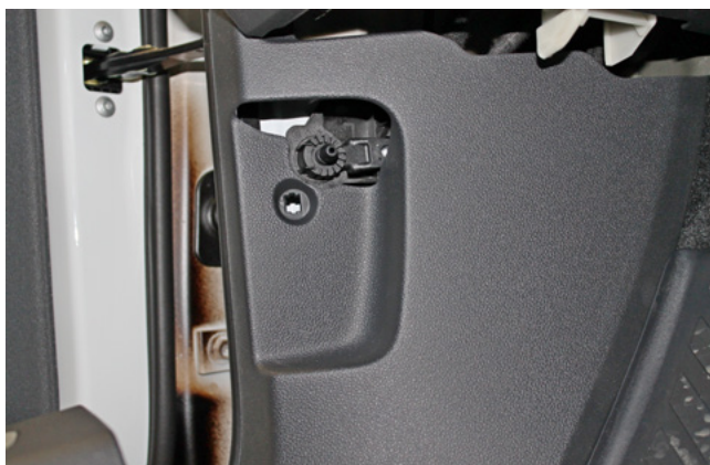
Фото 1.17. Клипса крепления накладки снята
