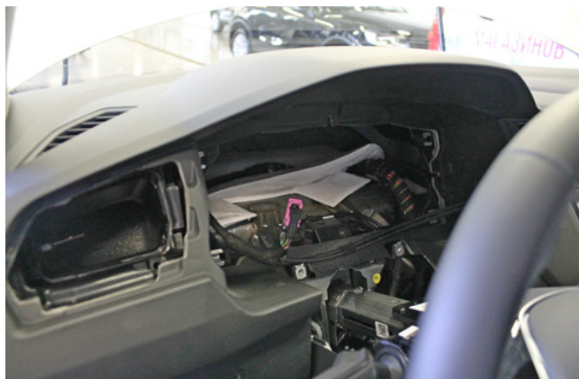
Фото 1.7. Панель приборов снята
