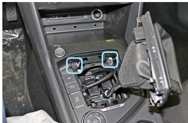
Фото 1.25. Саморезы крепления блока кнопок
