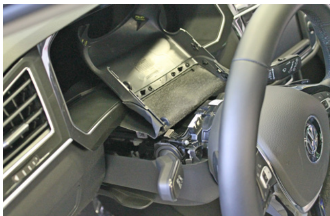
Фото 1.3. Верхняя часть кожуха рулевого вала снята
