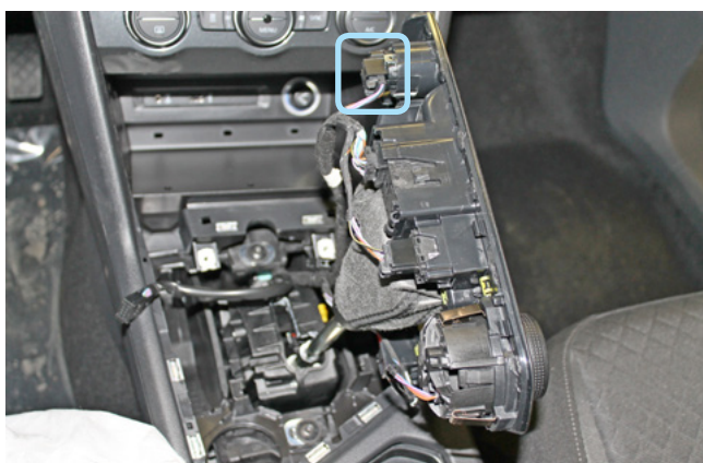
Фото 3.8. Местоположение разъёма кнопки Старт-Стоп
