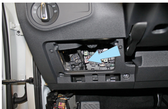
Фото 3.4. Местоположение жгута диагностического разъёма
