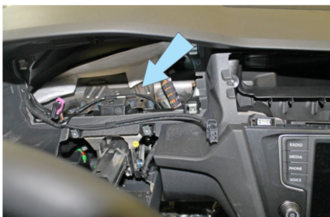
Фото 3.12. Местоположение жгута антенны штатного иммобилайзера
