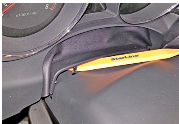
Фото 2.2. Снять пылезащитный кожух рулевой колонки
