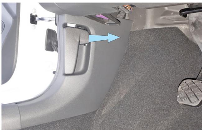
Фото 1.3. Сдвинуть фиксатор, снять ручку отпирания капота
