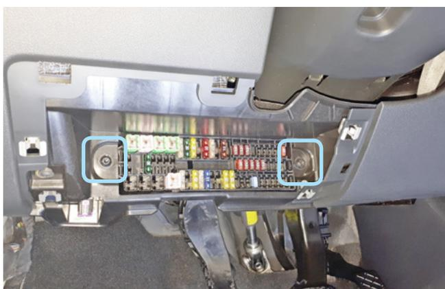
Фото 1.9. Саморезы блока предохранителей
