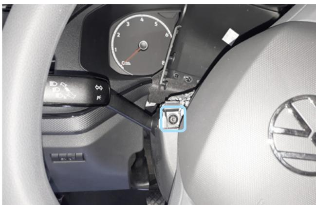
Фото 1.12. Винт крепления нижней части кожаной рулевого вала слева
