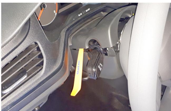
Фото 1.10. Снять верхнюю часть кожуха рулевого вала
