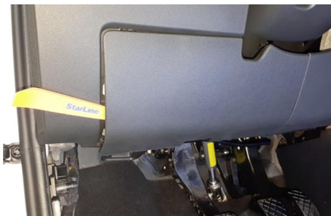
Фото 1.8. Снять крышку блока предохранителей
