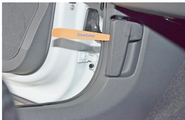
Фото 1.4. Снять ручку отпирания капота
