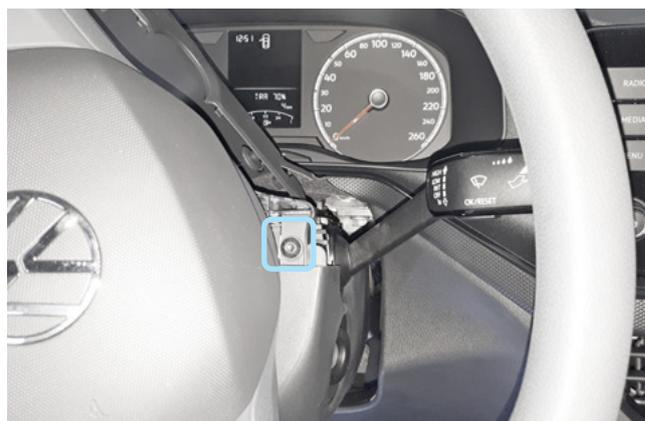
Фото 1.13. Винт крепления нижней части кожаной рулевого вала справа
