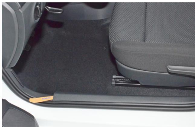
Фото 1.2. Снять декоративную накладку порога двери водителя
