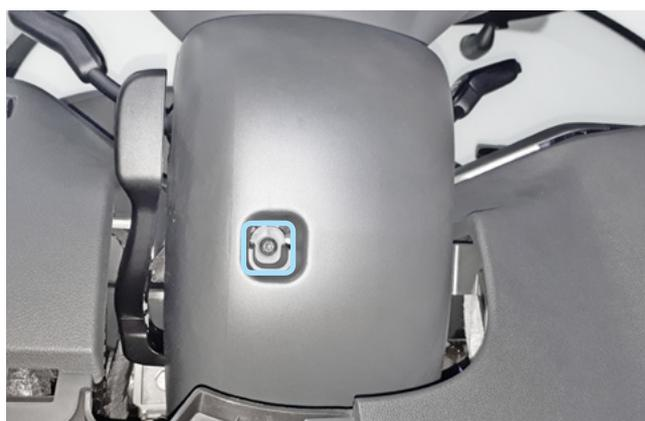
Фото 1.11. Винт крепления нижней части кожуха рулевого вала
