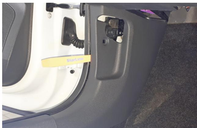
Фото 1.6. Снять кик-панель
